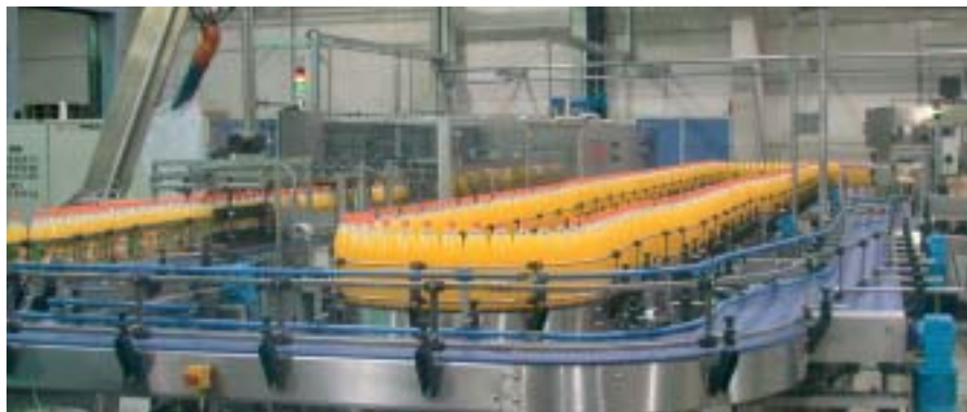
Die Abfüll- und Verpackungsanlage der Firma Starzinger stattet Sixpacks mit Folie und Tragegriff aus.
