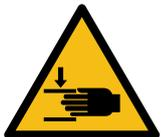
**Gefährdung durch Quetschen zwischen Shuttle und Führungsschiene!
