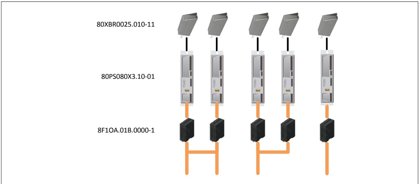
Abbildung 126: Beispiel Leistungsversorgung für ACOPOStrak Transportsysteme
