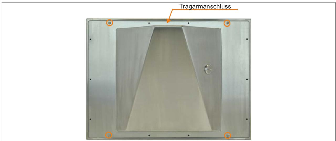
10. Anschließend werden die restlichen Schrauben Torx M4x12 mm leicht angezogen. Ist der Gehäusedeckel richtig zentriert und die Dichtung liegt plan auf können alle Schrauben fest geschraubt werden. (Drehmoment max.: 1 Nm)
