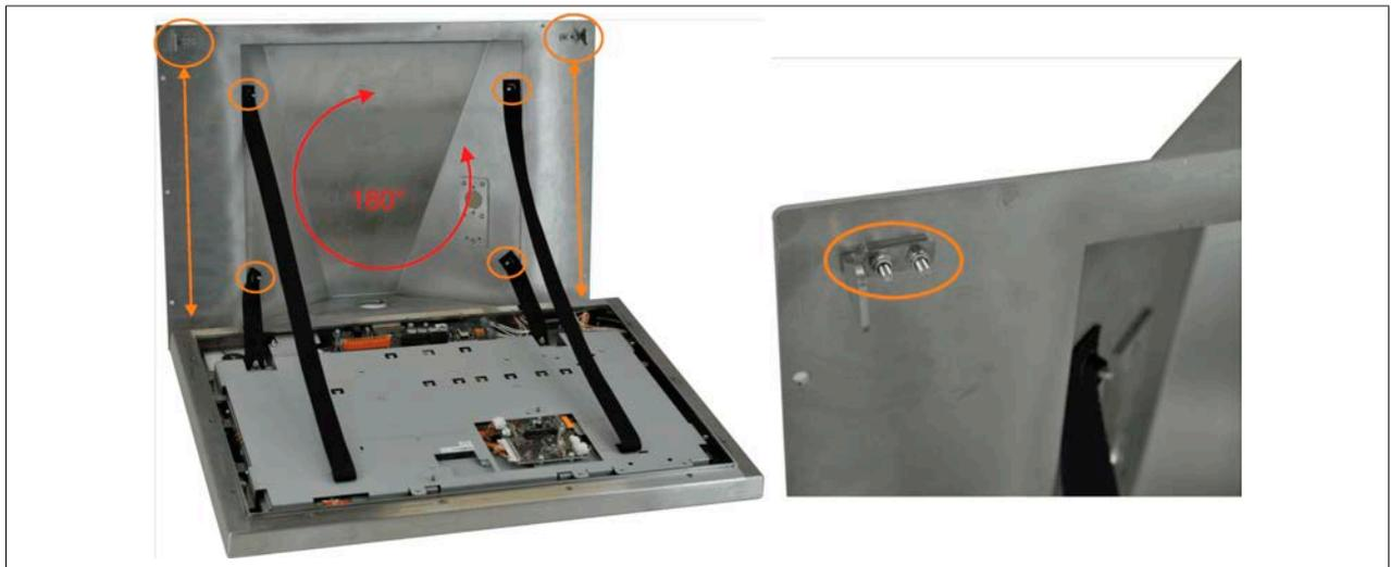
6. Die langen Haltebänder werden immer an der Gehäusedeckel-Oberseite und die kurzen Haltebänder an der Gehäusedeckel-Unterseite montiert. Es muss darauf geachtet werden, dass die Haltebänder nach innen (in die Vertiefung des Gehäuses) ragen um nicht eingeklemmt zu werden.
