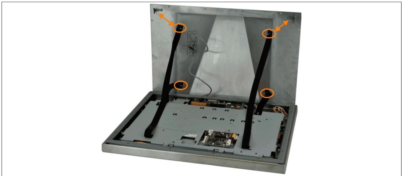
7. Dann kann die Verkabelung vorgenommen werden. Anschließend wird das Panel an die Haltehaken des Gehäusedeckels eingehängt, dabei muss darauf geachtet werden, dass die Haltebänder nicht eingeklemmt sind.
