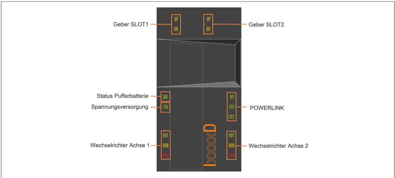
Abbildung 1: Anzeigegruppen Wechselrichtermodule 8BVI (Zweiachsmodul)
