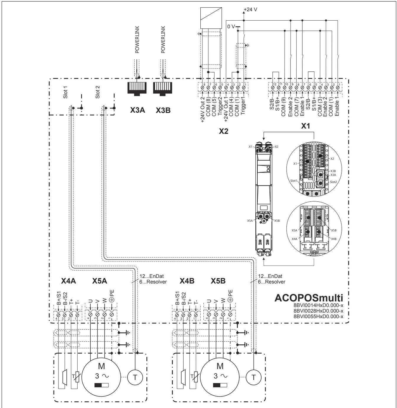
Abbildung 3: Übersicht Anschlussbelegungen 8BVI0014HxD0.000-x, 8BVI0028HxD0.000-x, 8BVI0055HxD0.000-x
