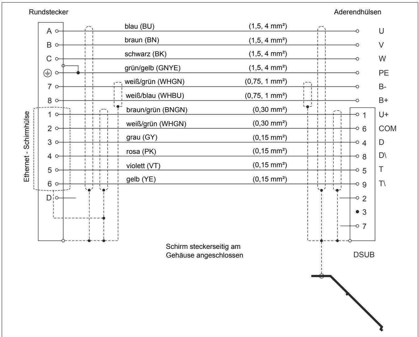
Abbildung 1: Kabelplan Motorhybridkabel
