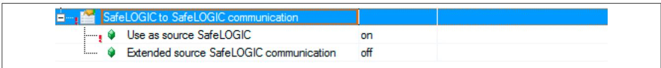
Zusätzlich kann nach dem Aktivieren des Parameters "Use as source SafeLOGIC" die Ausprägung - fix oder extended - der SafeLOGIC to SafeLOGIC communication konfiguriert werden. Ist der Parameter "Extended source SafeLOGIC communication" nicht aktiviert so wird die fixe Kommunikation verwendet.
