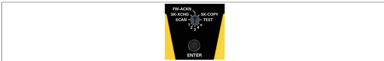
Abbildung 3: Auswahlschalter und Bestätigungstaster
