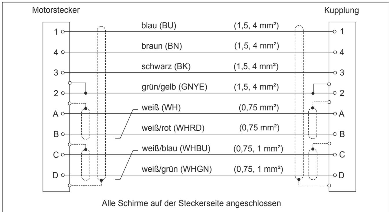
Abbildung 1: Kabelplan Motorkabel
