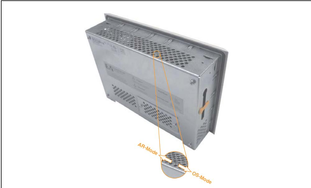
Abbildung 100: BIOS Boot-Mode Schalter
