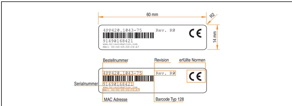
Abbildung 56: Aufbau / Abmessungen Serialnummernaufkleber
