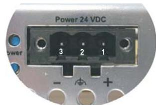
Abbildung 4: Spannungsversorgungsanschluss
