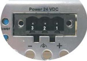
Abbildung 98: Spannungsversorgungsanschluss
