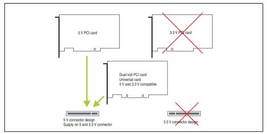
Figure 33: PCI connector type: 5 volt
