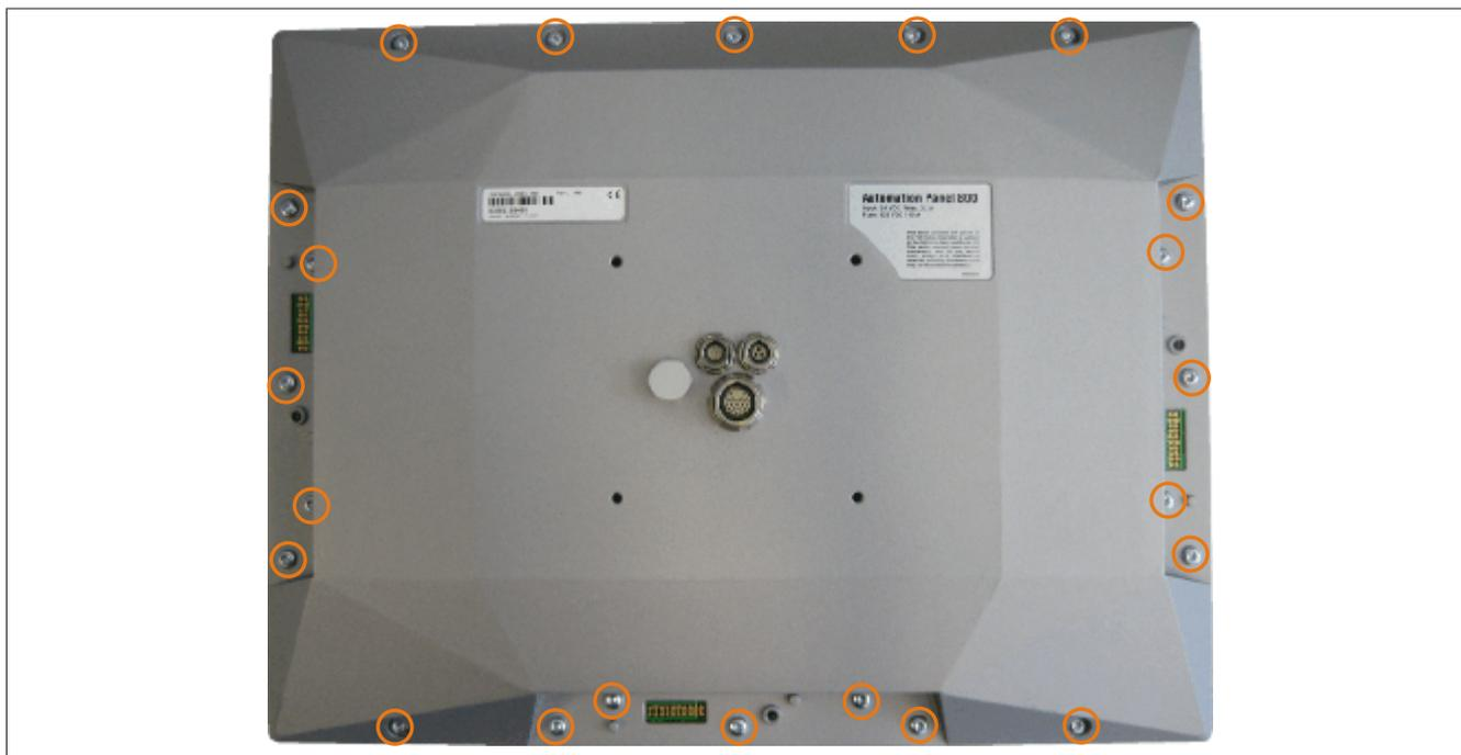
Abbildung 97: Schrauben lösen
