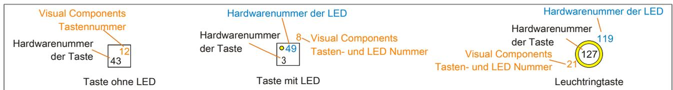
Abbildung 70: Darstellung - Tasten und LEDs in der Matrix
