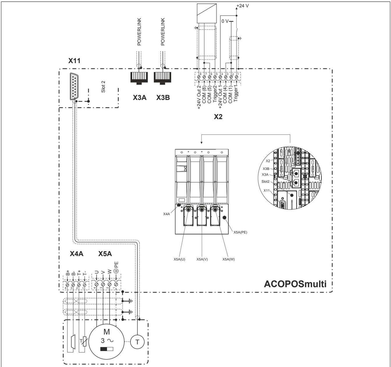
Abbildung 3: Übersicht Anschlussbelegungen
