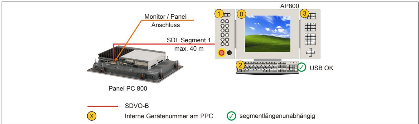
Abbildung 65: Ein Automation Panel 800 über SDL onboard
