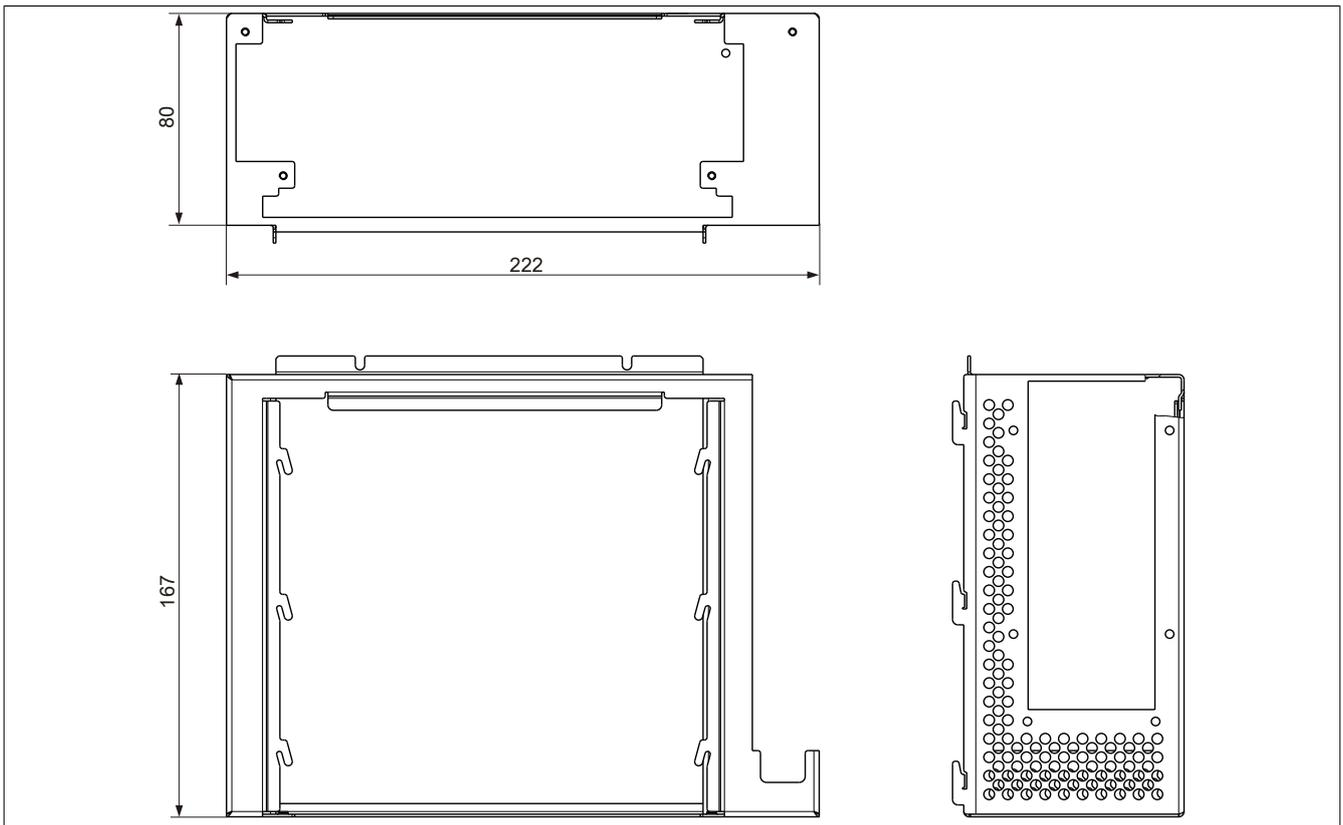
Abbildung 22: 5AC803.SX02-00 - Abmessungen
