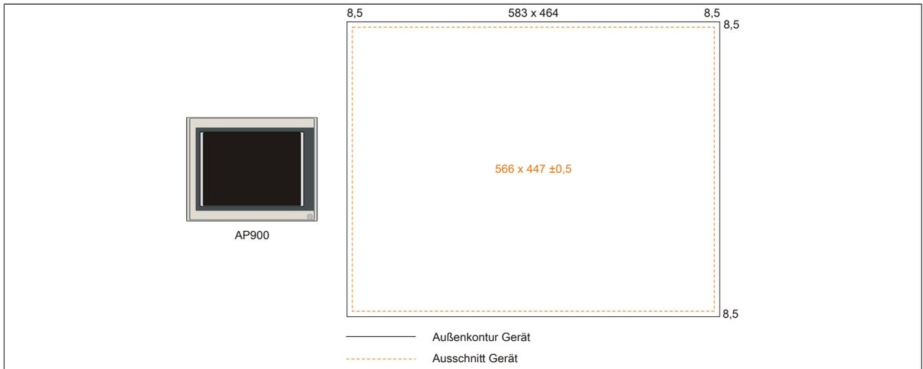
Abbildung 225: Einbaukompatibilität 21,1" Geräte Quer1
