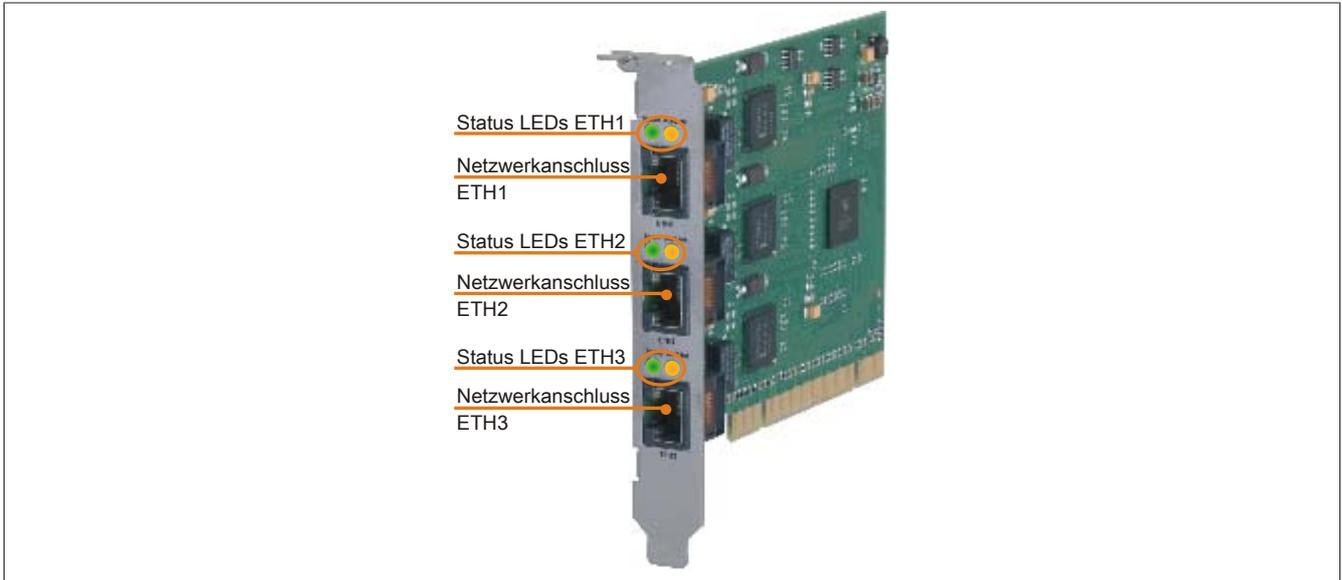
Abbildung 140: 5ACPCI.ETH3-01 - PCI Ethernet Card 10/100
