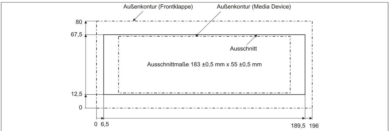
Abbildung 161: Einbauausschnitt USB Media Drive mit Frontklappe
