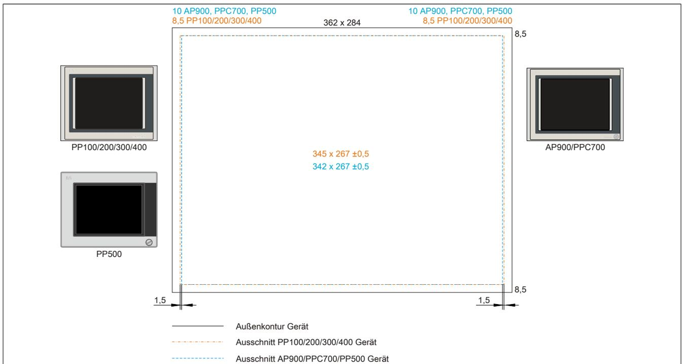
Abbildung 220: Einbaukompatibilität 12,1" Geräte Format Quer1
