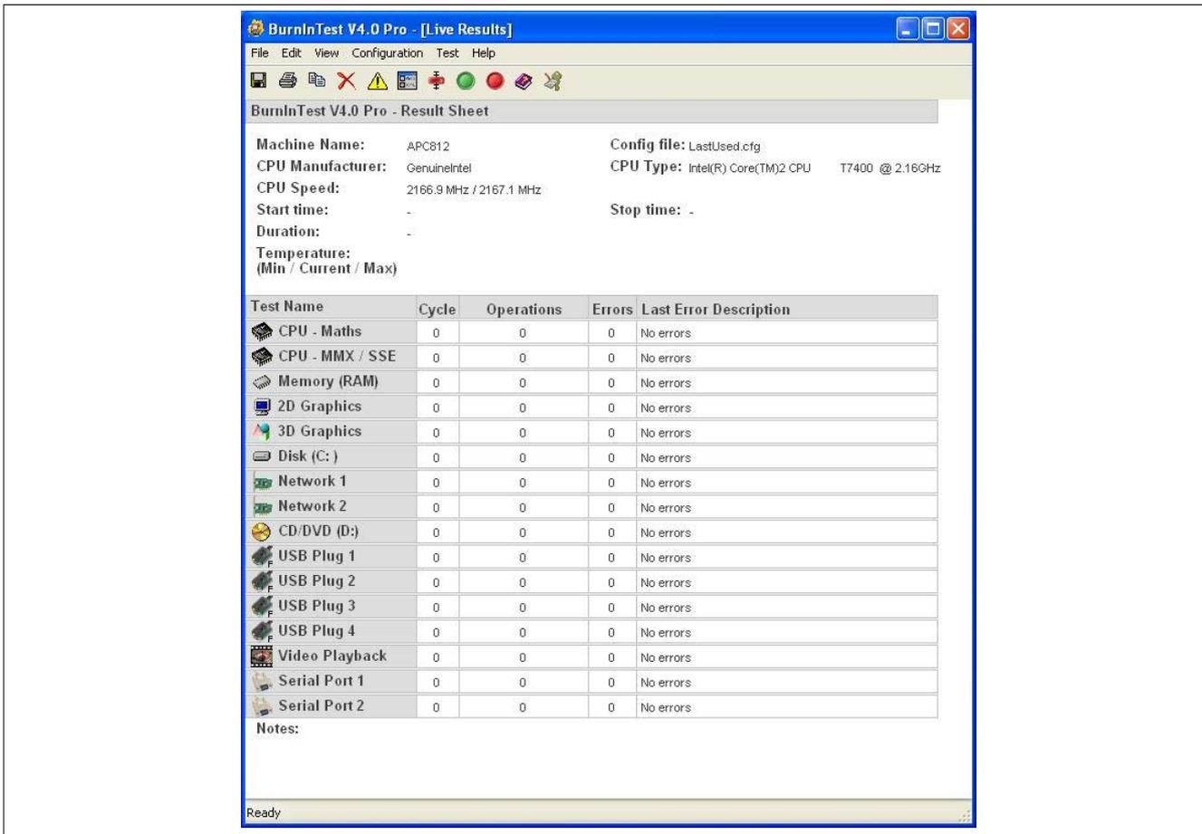
Abbildung 62: Testübersicht eines APC810 2 Slot mit DVD
