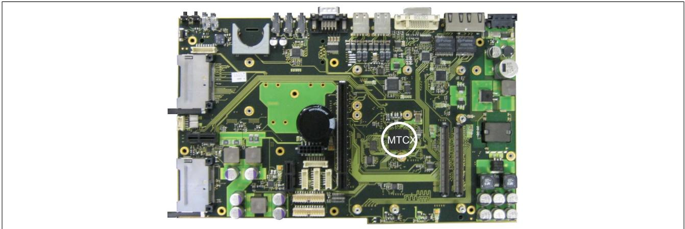
Abbildung 210: Position des MTCX Controllers
