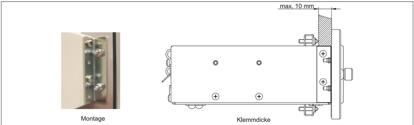
Abbildung 160: Frontklappenmontage und Klemmdicke
