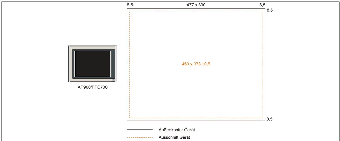
Abbildung 223: Einbaukompatibilität 17" Geräte Quer1
