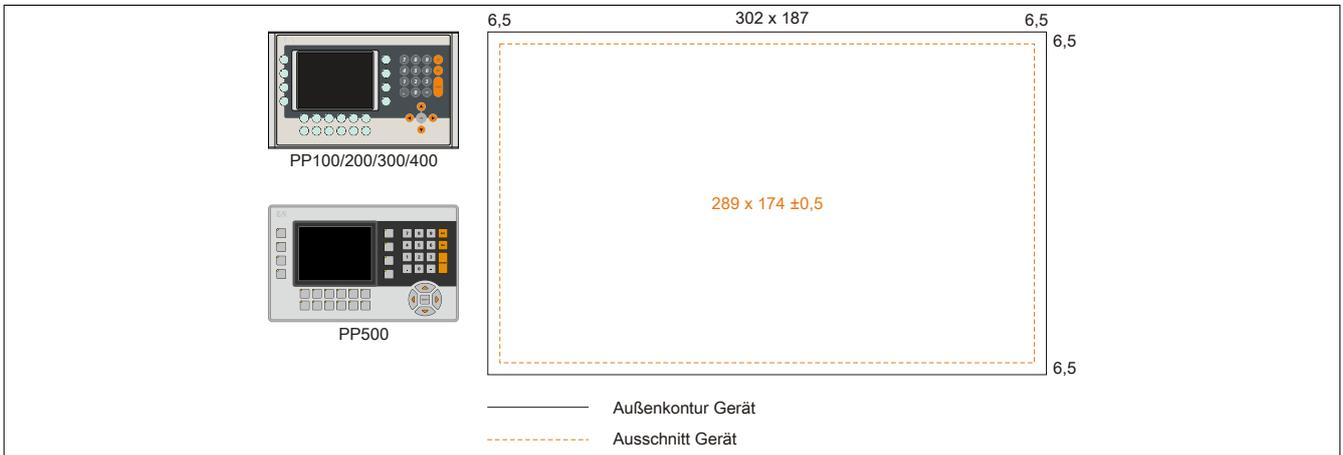
Abbildung 215: Einbaukompatibilität 5,7“ Geräte Format Quer2
