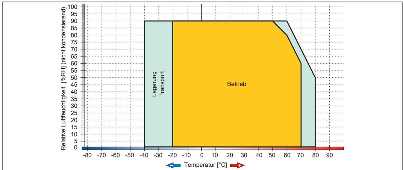
Abbildung 212: Temperatur Luftfeuchtediagramm AMT Touch Screen 5-Draht
