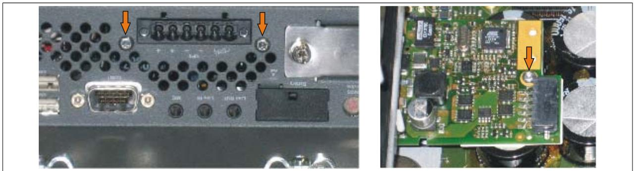
Abbildung 196: USV Modul montieren
