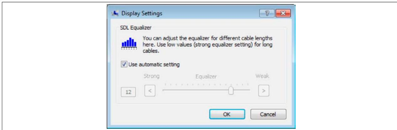
Abbildung 122: ADI Control Center - SDL Equalizer Einstellung
