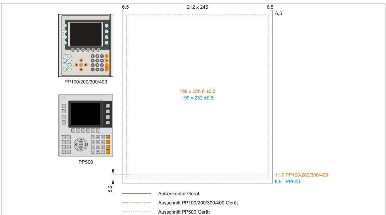
Abbildung 216: Einbaukompatibilität 5,7“ Geräte Format Hoch1
