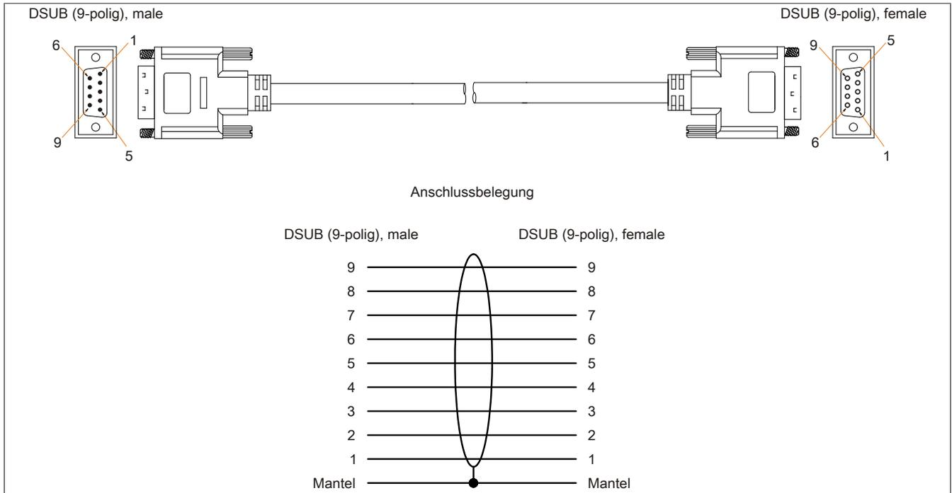
Abbildung 179: 9A0014.xx - Belegung RS232 Kabel
