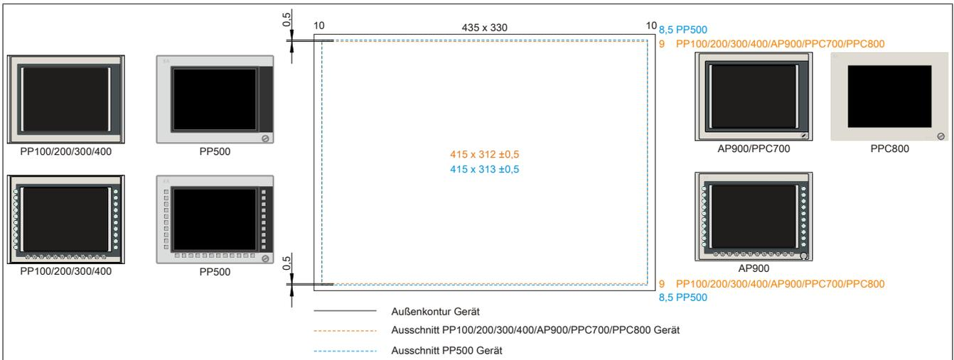
Die 15" Power Panel 500 Geräte sind mit den Power Panel 100/200, Power Panel 300/400, Automation Panel 900, Panel PC 700 bzw. Panel PC 800 Geräten Format Hoch1 nicht zu 100% einbaukompatibel. Die Power Panel 500 Geräte benötigen einen um 0,5 mm höheren (Unter- und Oberkante) Ausschnitt.
