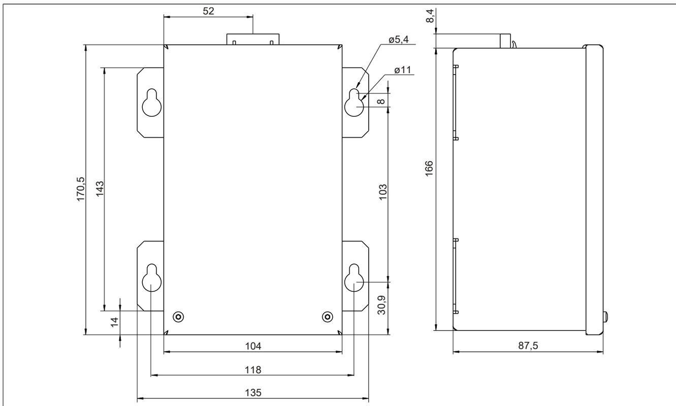
Abbildung 135: 5PC600.UPSB-00 - Abmessungen
