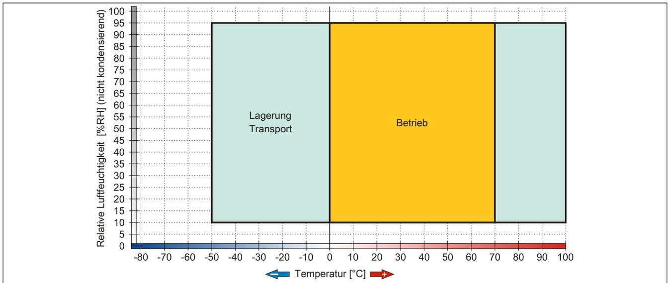
Abbildung 150: 5CFCRD.xxxx-03 - Temperatur Luftfeuchtediagramm CompactFlash Karten
