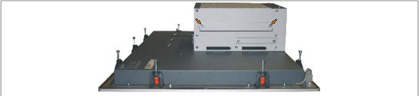
Abbildung 186: Schnellverschlusschrauben lösen
