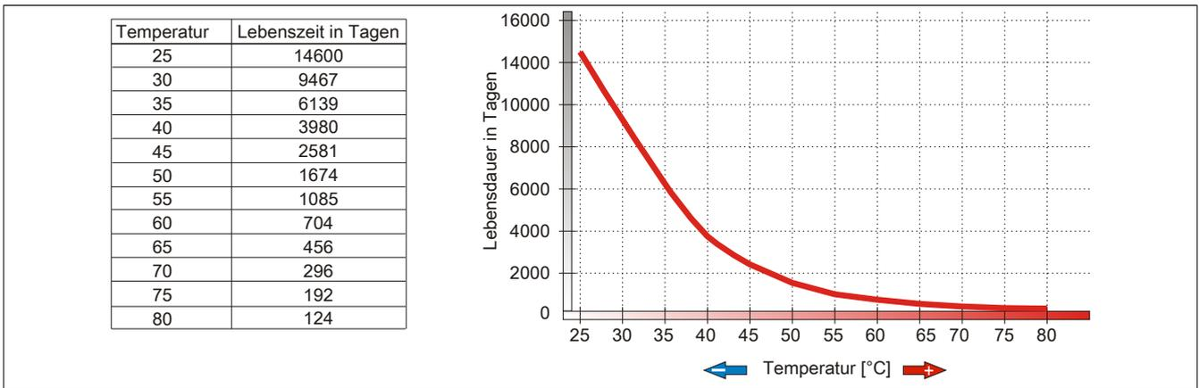
Abbildung 133: Temperatur Lebensdauerdiagramm
