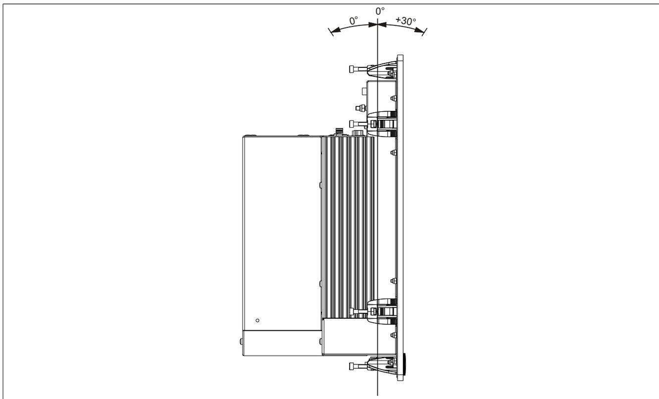
Abbildung 57: Einbaulage mit 5AC801.DVDS-00
