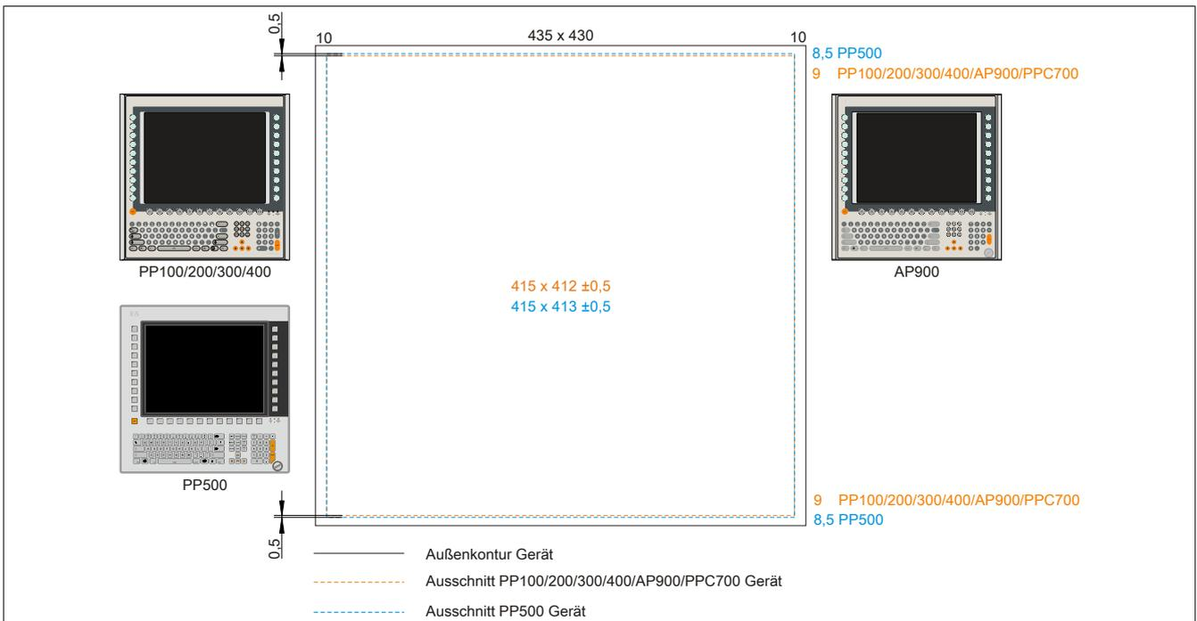
Die 15" Power Panel 500 Geräte sind mit den Power Panel 100/200, Power Panel 300/400, Automation Panel 900 bzw. Panel PC 700 Geräten Format Hoch1 nicht zu 100% einbaukompatibel. Die Power Panel 500 Geräte benötigen einen um 0,5 mm höheren (Unter- und Oberkante) Ausschnitt.
