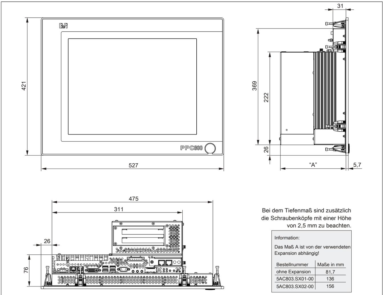
Abbildung 18: 5PC820.1906-00 - Abmessungen
