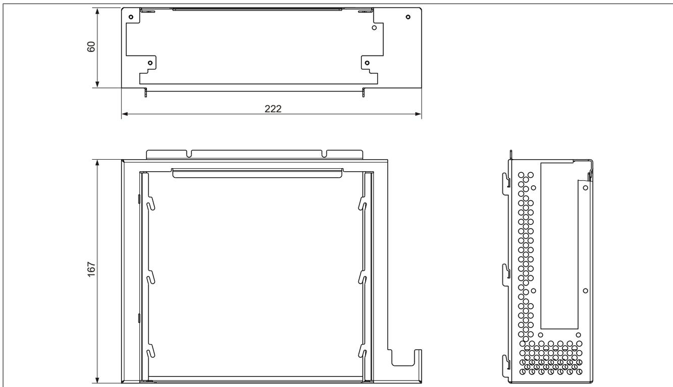
Abbildung 21: 5AC803.SX01-00 - Abmessungen
