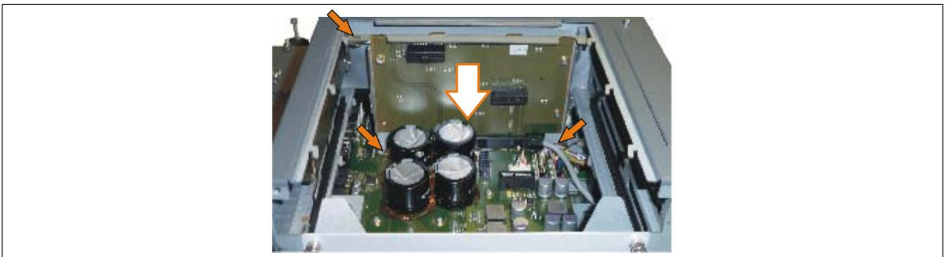
Abbildung 200: Buseinheit montieren
