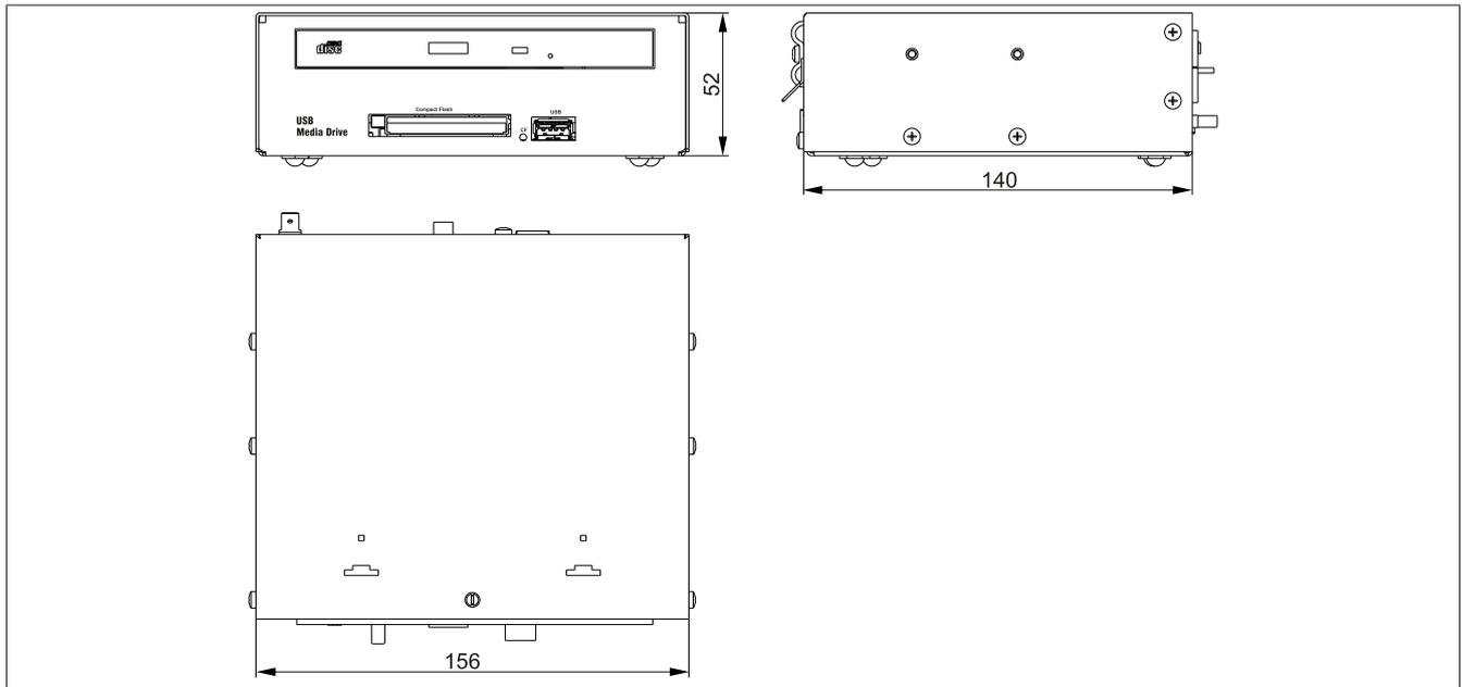
Abbildung 155: 5MD900.USB2-02 - Abmessungen
