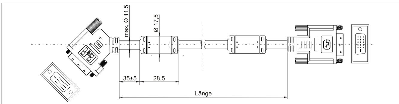
Abbildung 169: 5CASDL.0xxx-01 - Abmessungen
