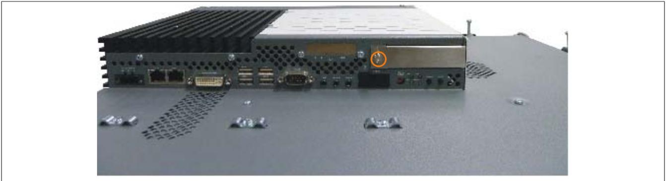
Abbildung 204: PCIec Modulabdeckung entfernen
