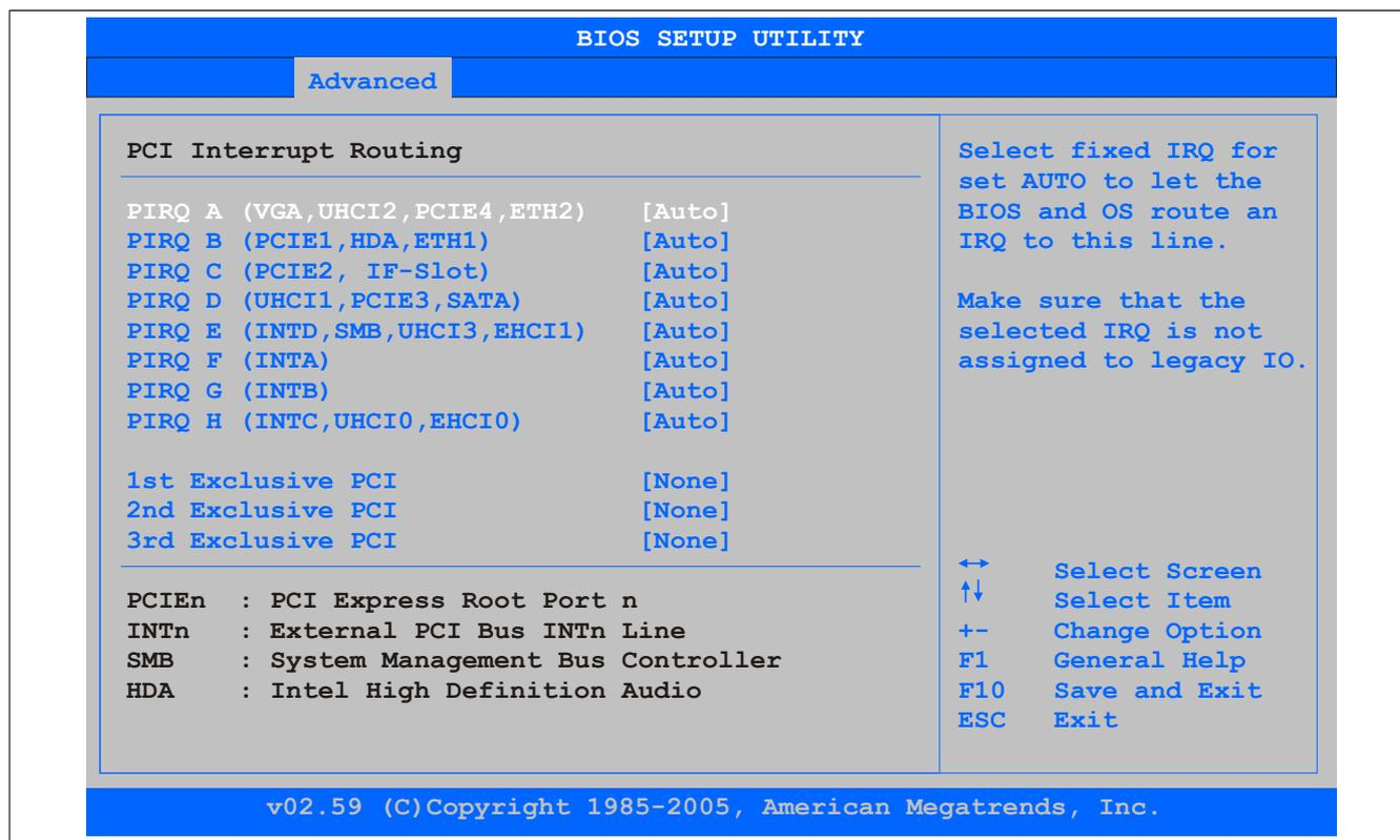
Abbildung 86: GM45 Advanced PCI Interrupt Routing
