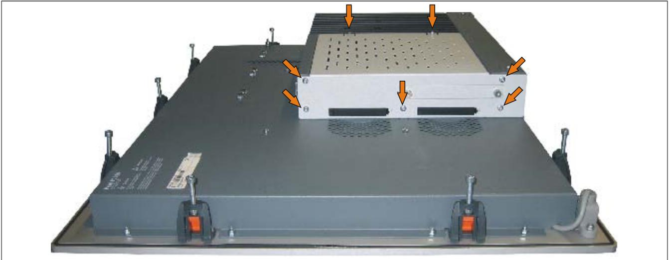
Abbildung 206: PPC800 Seitendeckeldemontage ohne Expansion
