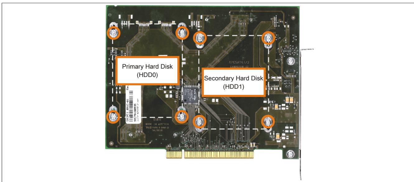
Abbildung 208: Rückseite des SATA RAID Controllers 5ACPCI.RAIC-03 Schraubenzuordnung
