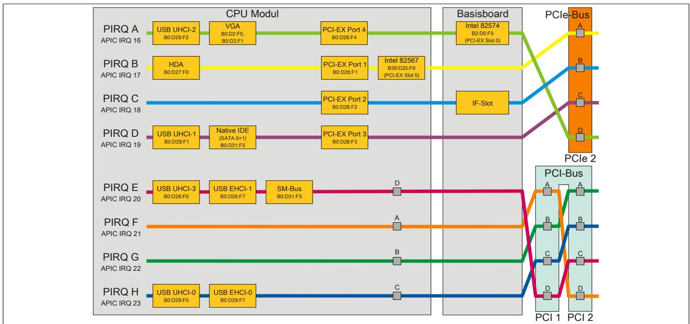
Abbildung 112: PCI und PCIe Routing mit aktiviertem APIC CPU Boards GM45
