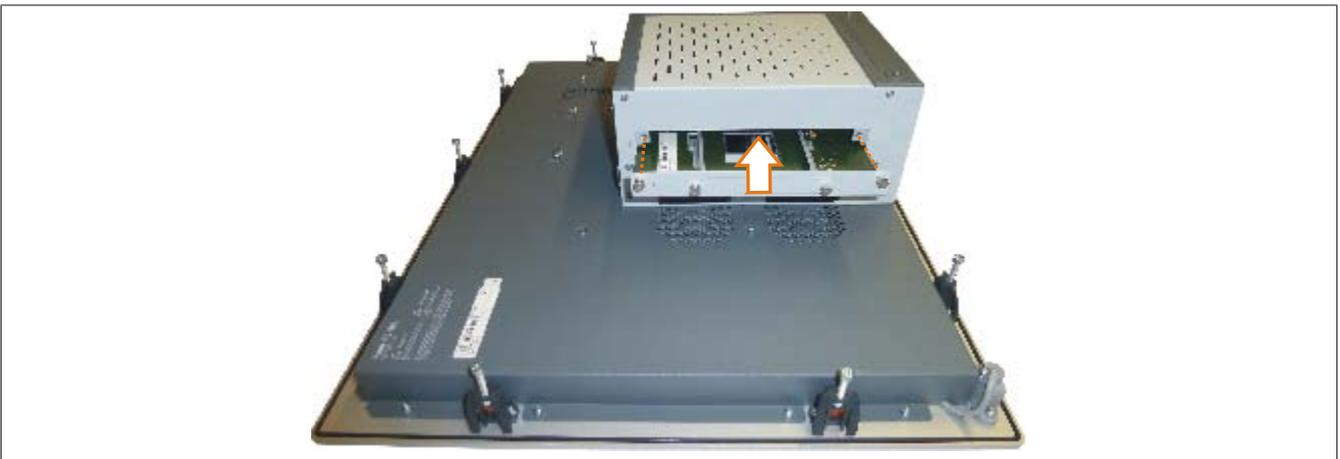
Abbildung 189: Slide-in compact Adapter Einbau
