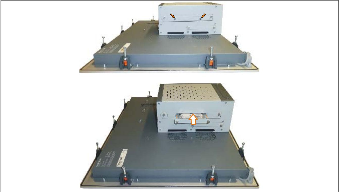
Abbildung 190: Slide-in compact Laufwerk montieren
