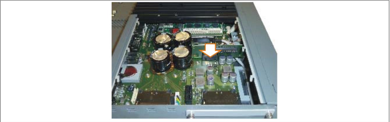
Abbildung 203: 5AC803.BC02-00 Adapter montieren
