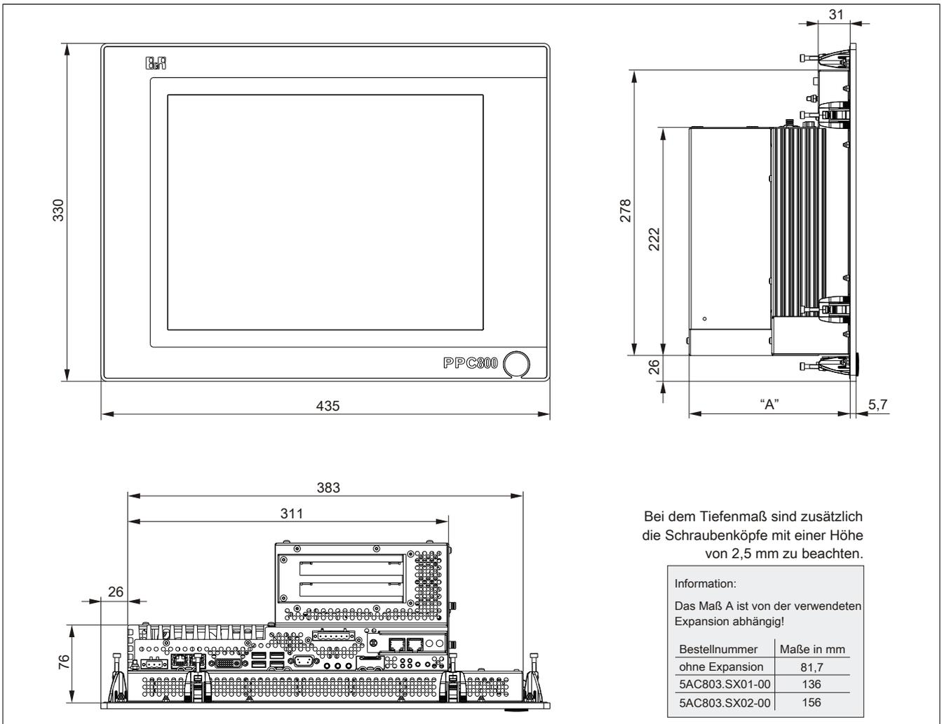
Abbildung 14: 5PC820.1505 - Abmessungen
