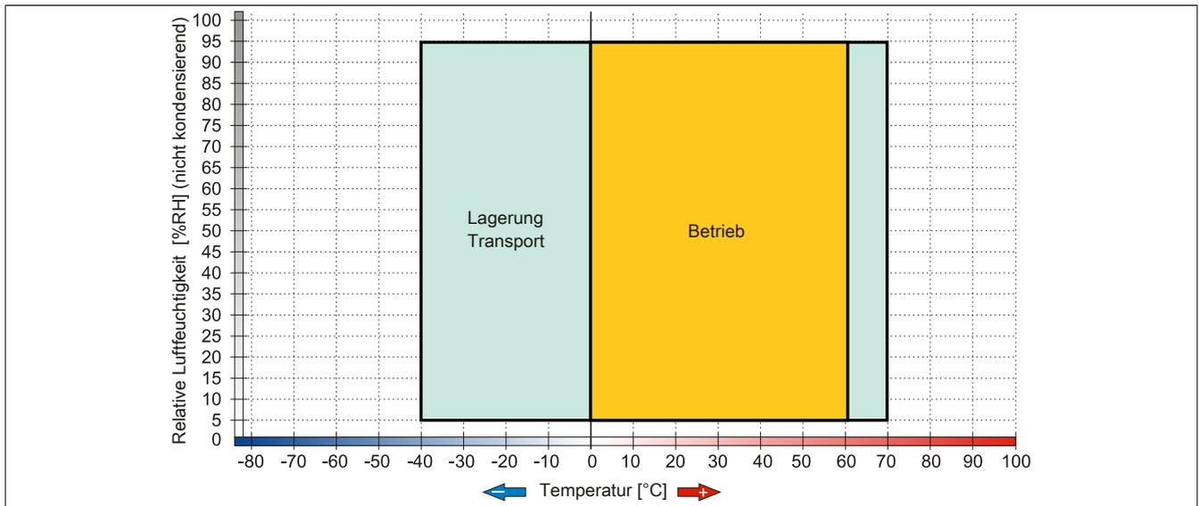
Abbildung 46: 5ACPCI.RAIC-05 - Temperatur Luftfeuchtediagramm
