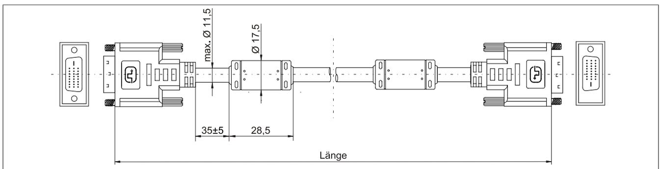
Abbildung 166: 5CASDL.0xxx-00 - Abmessungen
