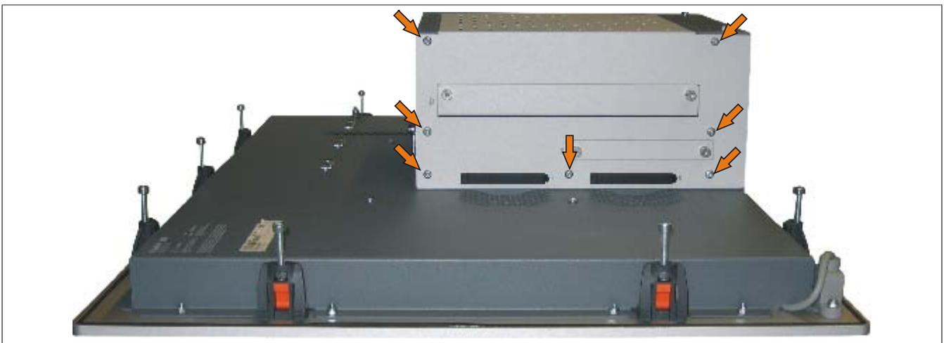
Abbildung 207: PPC800 Seitendeckeldemontage mit Expansion (Beispielfoto 1 Slot Expansion)
