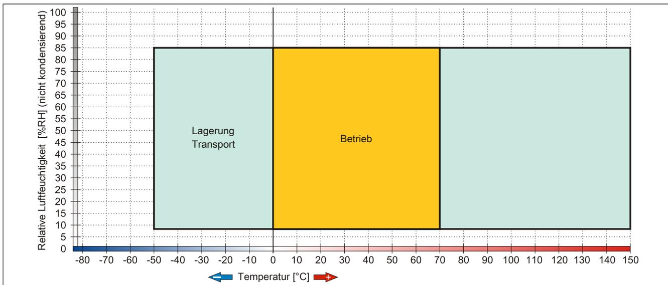
Abbildung 142: 5CFCRD.xxxx-06 - Temperatur Luftfeuchtediagramm CompactFlash Karte
