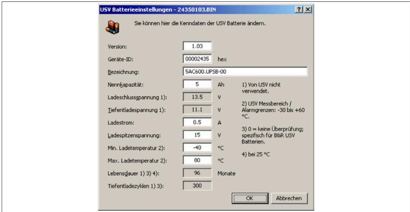
Abbildung 125: ADI Control Center - USV Batterieeinstellungen
