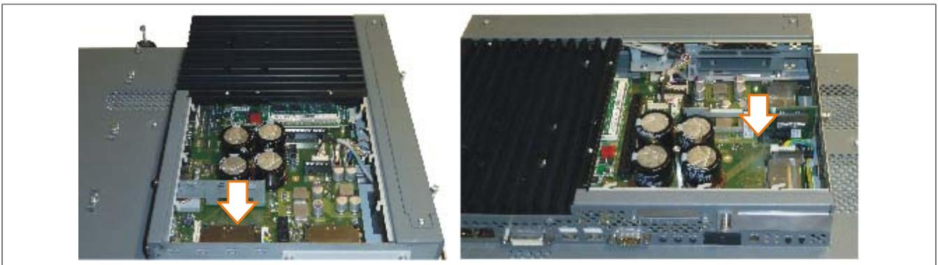
Abbildung 202: 5AC803.BC01-00 Adapter montieren
