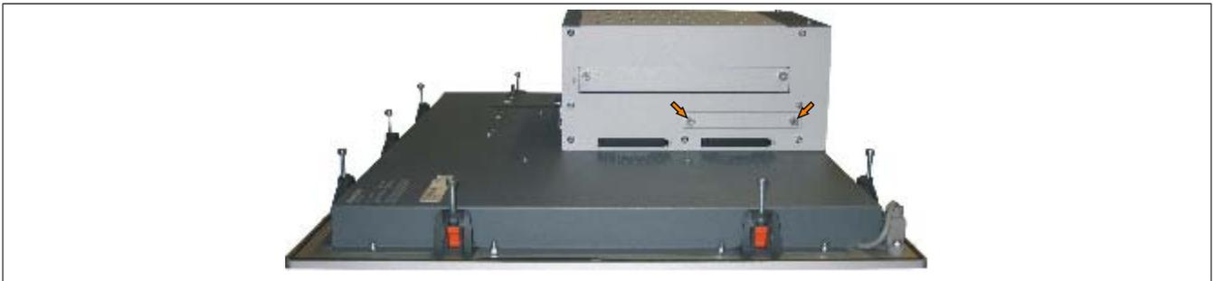
Abbildung 184: Schnellverschlusschrauben lösen
