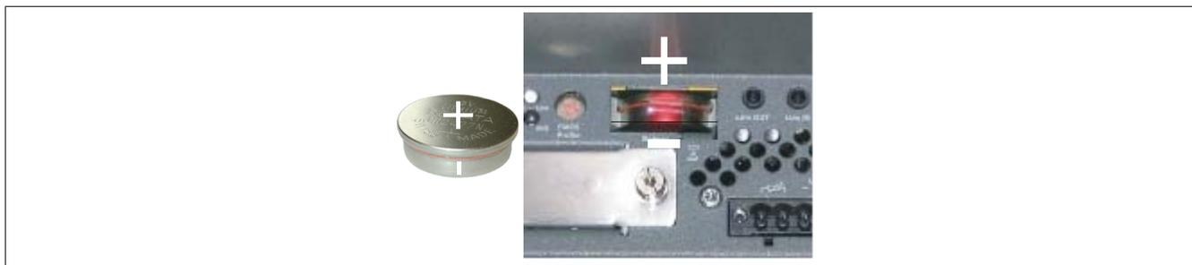
Abbildung 182: Batteriepolarität
