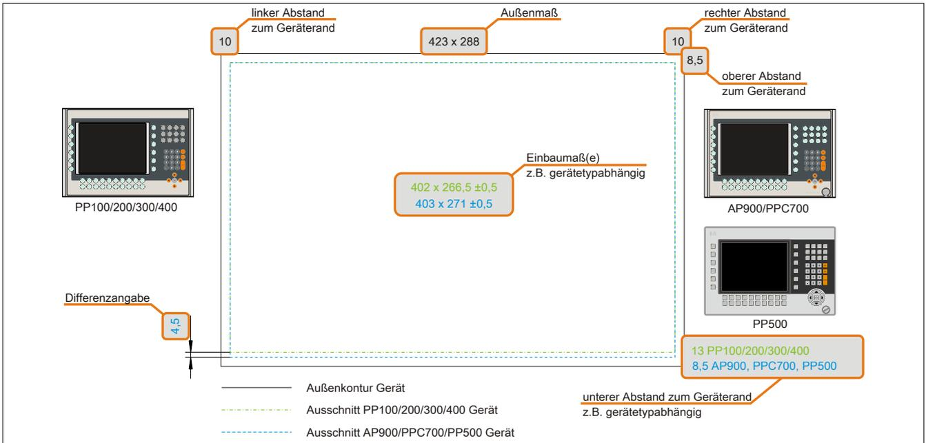
Abbildung 213: Kompatibilitätsdetails Abbildungsaufbau
