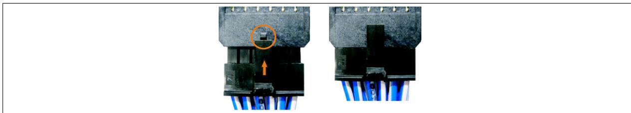
Abbildung 198: Steckerverriegelung
