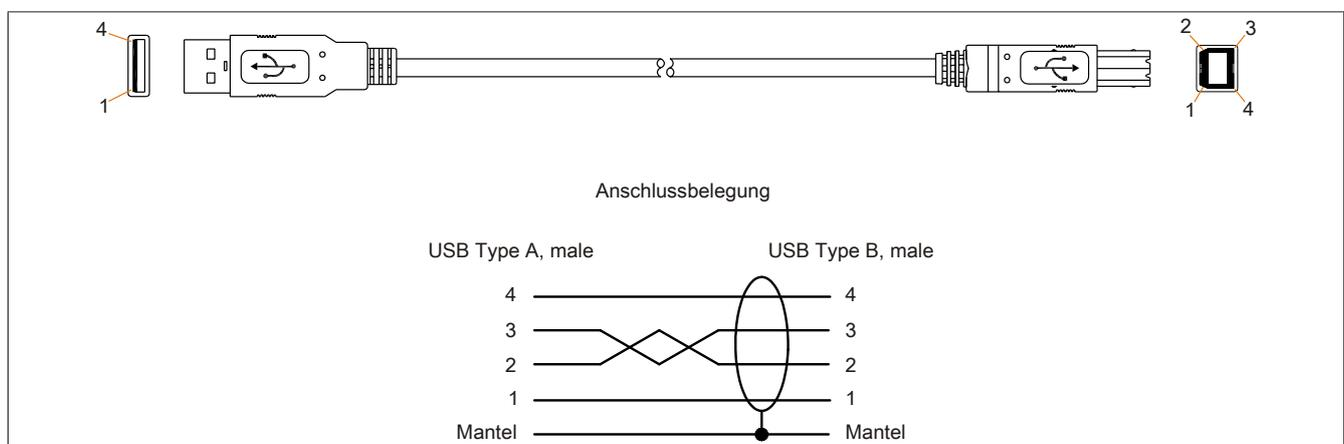
Abbildung 178: 5CAUSB.00xx-00 - Belegung USB Kabel
