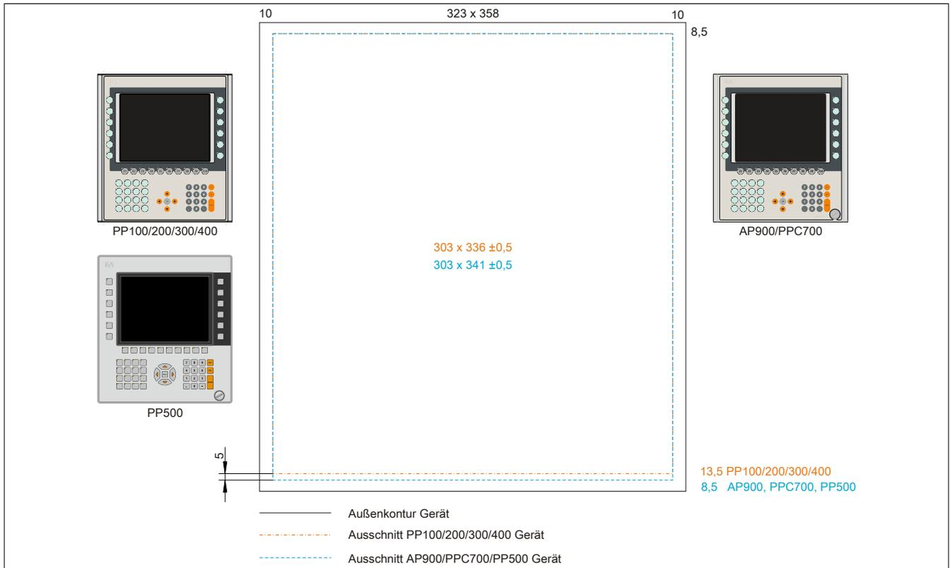
Abbildung 219: Einbaukompatibilität 10,4" Geräte Format Hoch1
