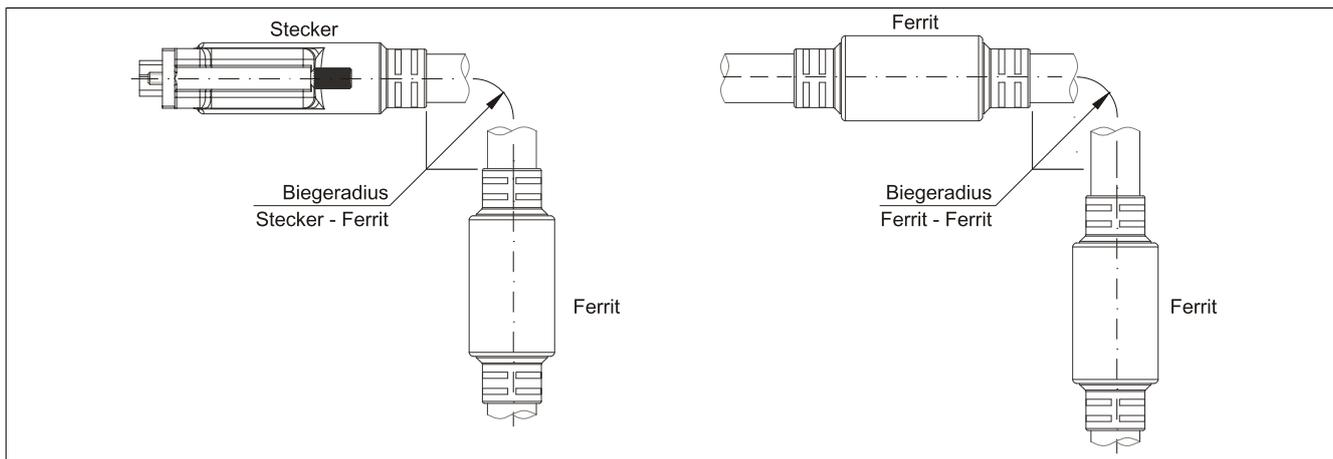
Abbildung 168: Biegeradiusspezifikation
