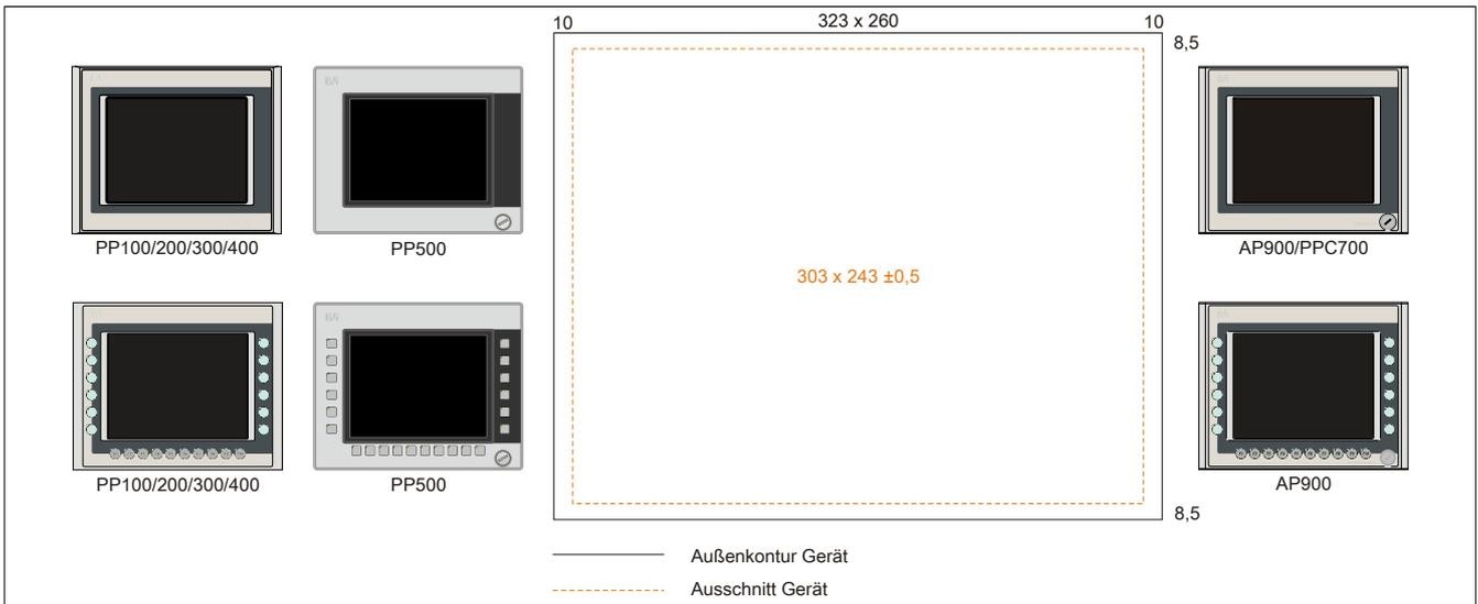
Abbildung 217: Einbaukompatibilität 10,4" Geräte Format Quer1
