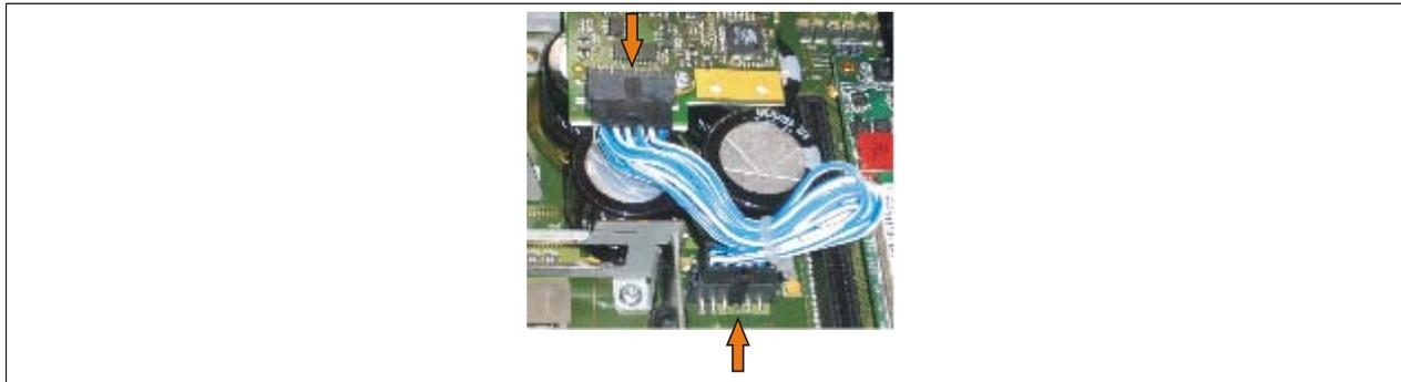
Abbildung 197: Verbindungskabel anstecken
