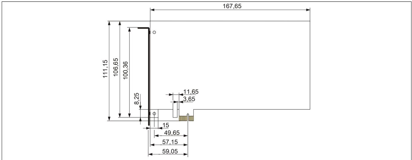
Abbildung 24: Abmessungen Standard half-size PCIe Karte
