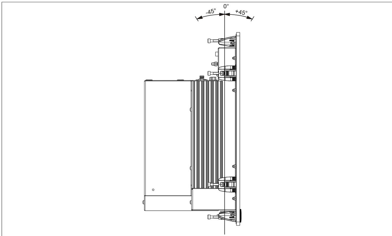
Abbildung 55: Einbaulage 0° und +/-45°
