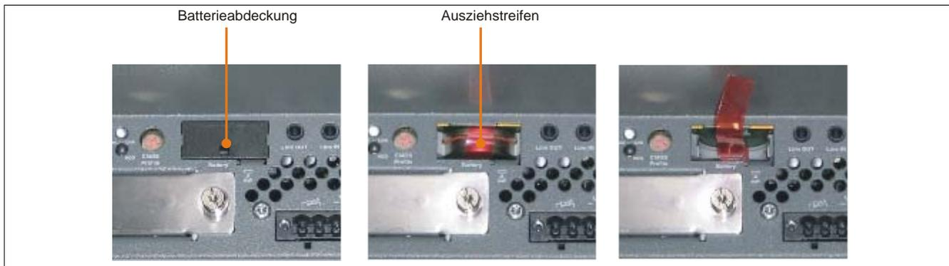
Abbildung 180: Batterie entfernen
