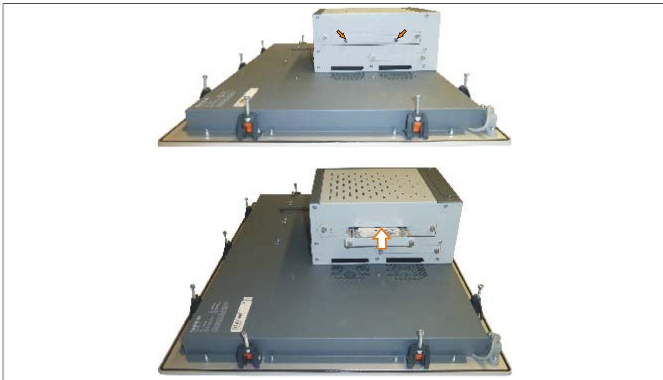
Abbildung 175: Slide-in compact Laufwerk montieren
