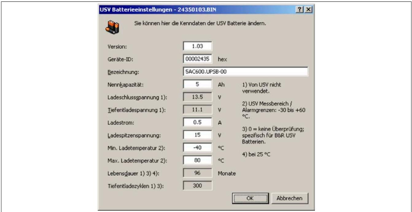
Abbildung 117: ADI Control Center - USV Batterieeinstellungen
