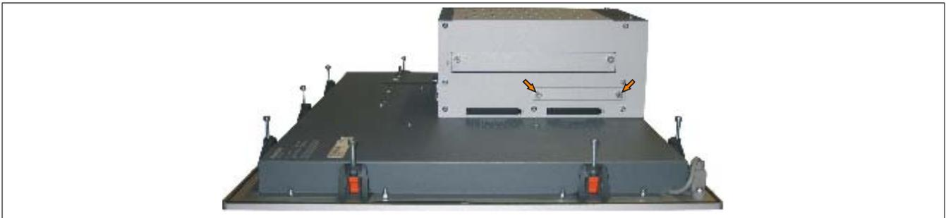
Abbildung 169: Schnellverschlusschrauben lösen
