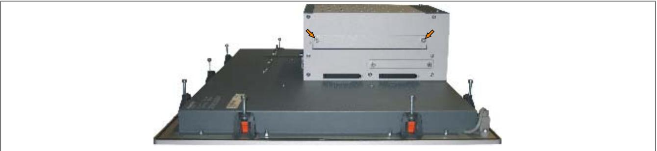
Abbildung 173: Schnellverschlusschrauben lösen
