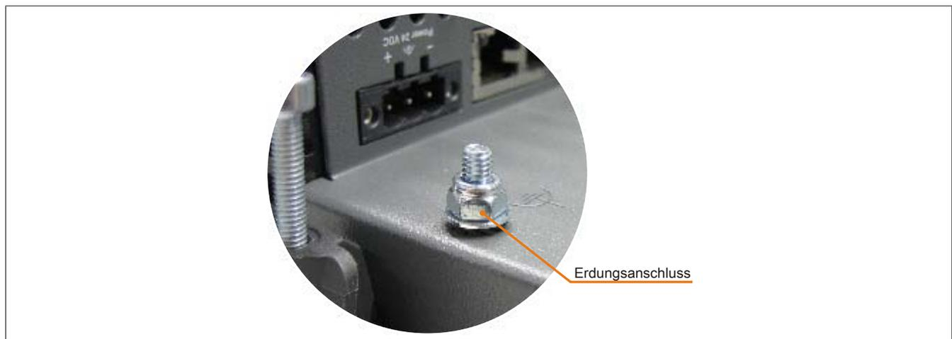
Abbildung 11: Erdungsanschluss
