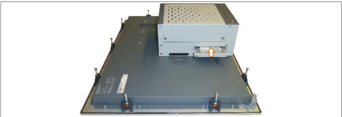
Abbildung 170: Compact SATA Laufwerk einschieben
