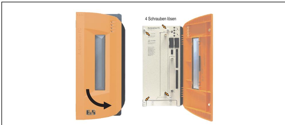
Abbildung 268: APC810 2 Card Slot Seitendeckeldemontage
