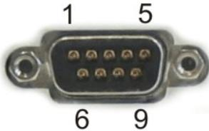
Abbildung 11: RS232-Schnittstelle und Versorgung 4B1260.00-390
