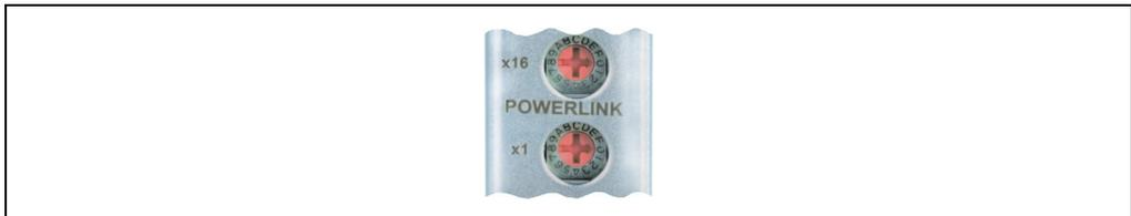
Abbildung 2: IF787 ETHERNET Powerlink Stationsnummernschalter
