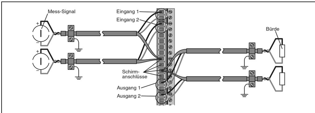
Abbildung 149: AM051 Anschluss der Signalkabel
