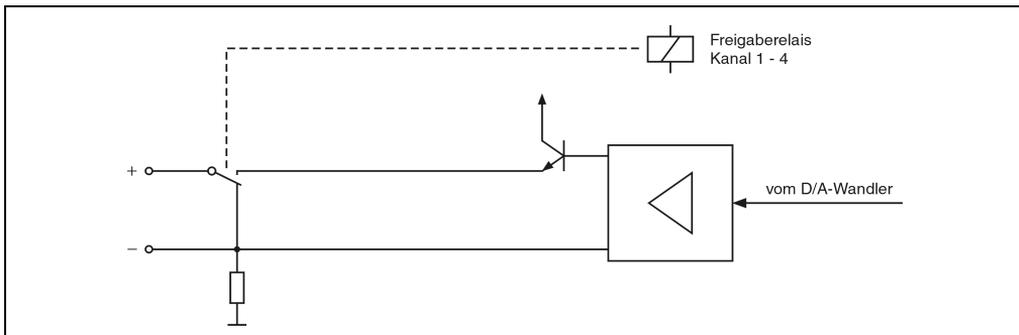
Abbildung 152: AM051 Ausgangsschema
