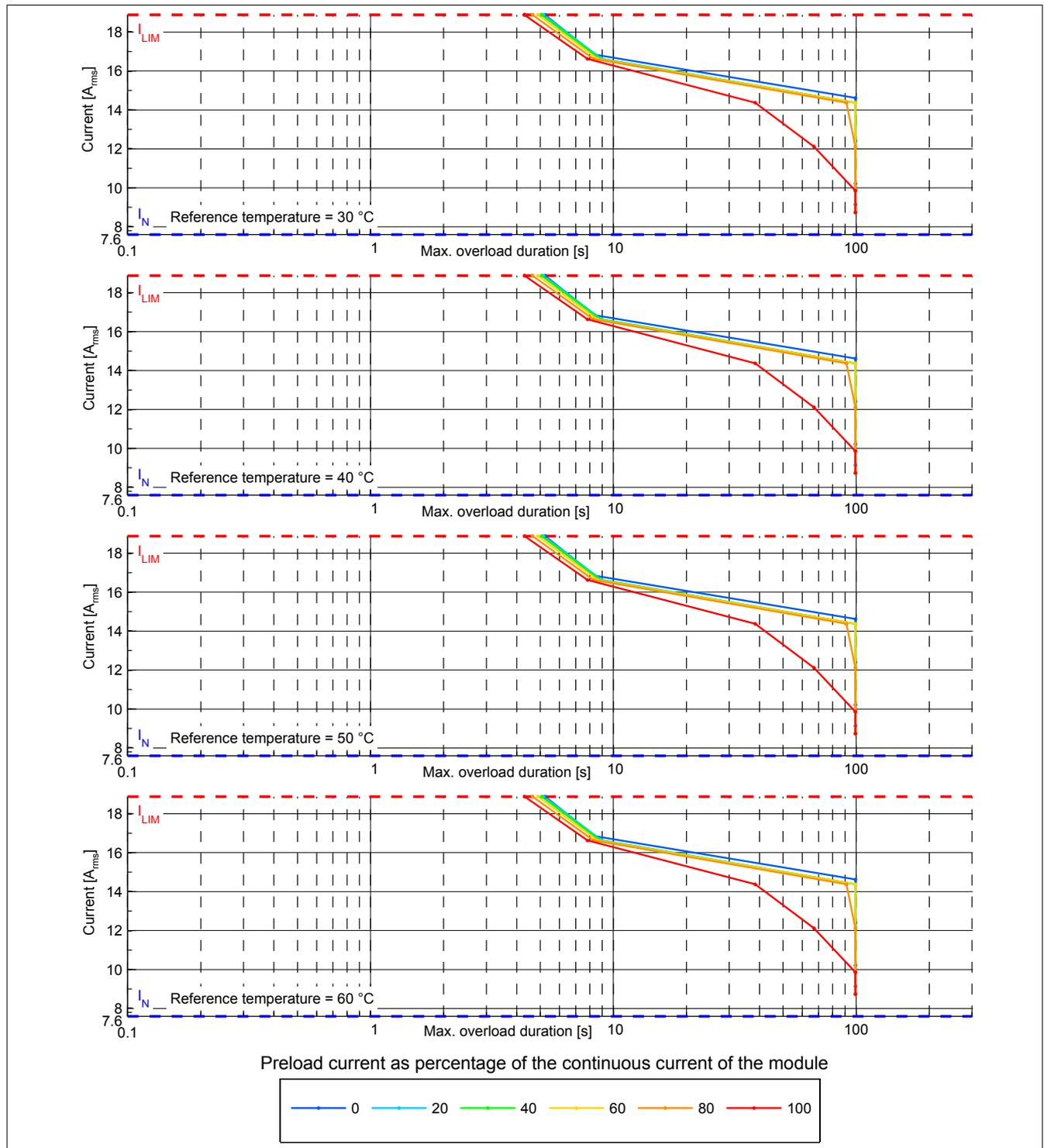
Abbildung 1: Überlast-Charakteristik 8BVI0055HCDx.000-1, Überlastreaktion - WARNING
