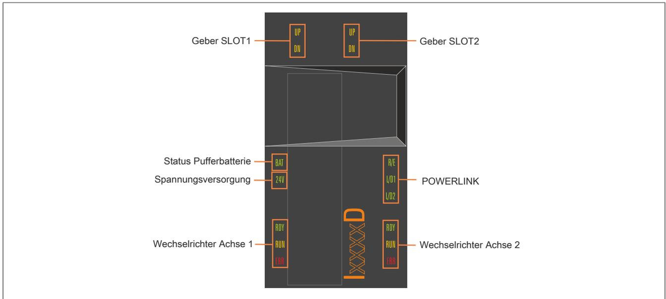
Abbildung 3: Anzeigegruppen Wechselrichtermodule 8BVI (Zweiachsmodul)
