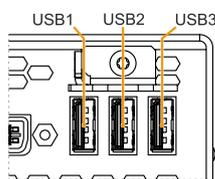
1) Die USB-Schnittstellen sind durch einen wartungsfreien „USB Strombegrenzungsschalter“ (max. 0,5 A) abgesichert.
