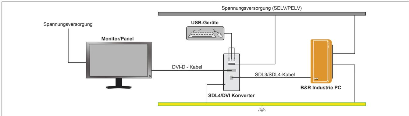
Maximale Kabellänge SDL4: 100 m
