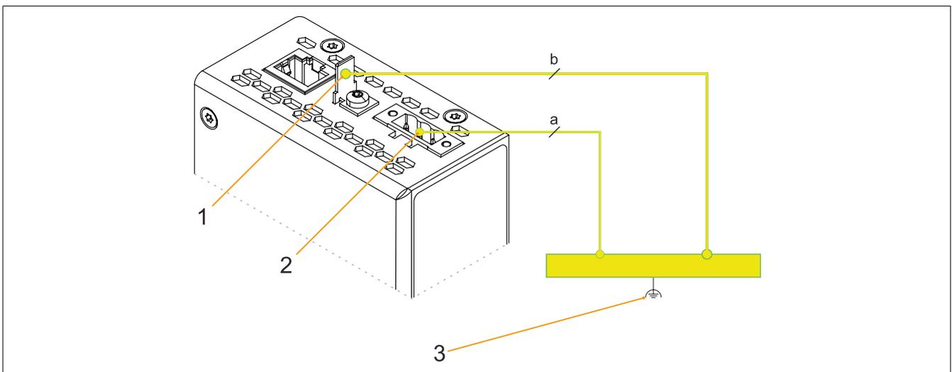
Abbildung 2: Beim 5COSD4.1002-00 befinden sich die Anschlüsse der Erdung und der Spannungsversorgung an der Unterseite.
