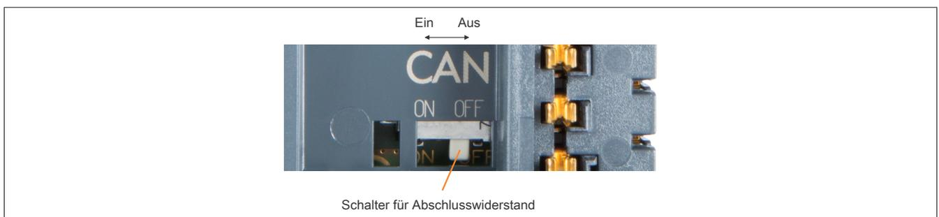
Am Busmodul ist bereits ein Abschlusswiderstand für den CAN-Bus integriert. Mit einem Schalter wird der Abschlusswiderstand zu- oder abgeschaltet. Ein aktivierter Abschlusswiderstand wird am Einspeisemodul durch die LED "T" angezeigt.
