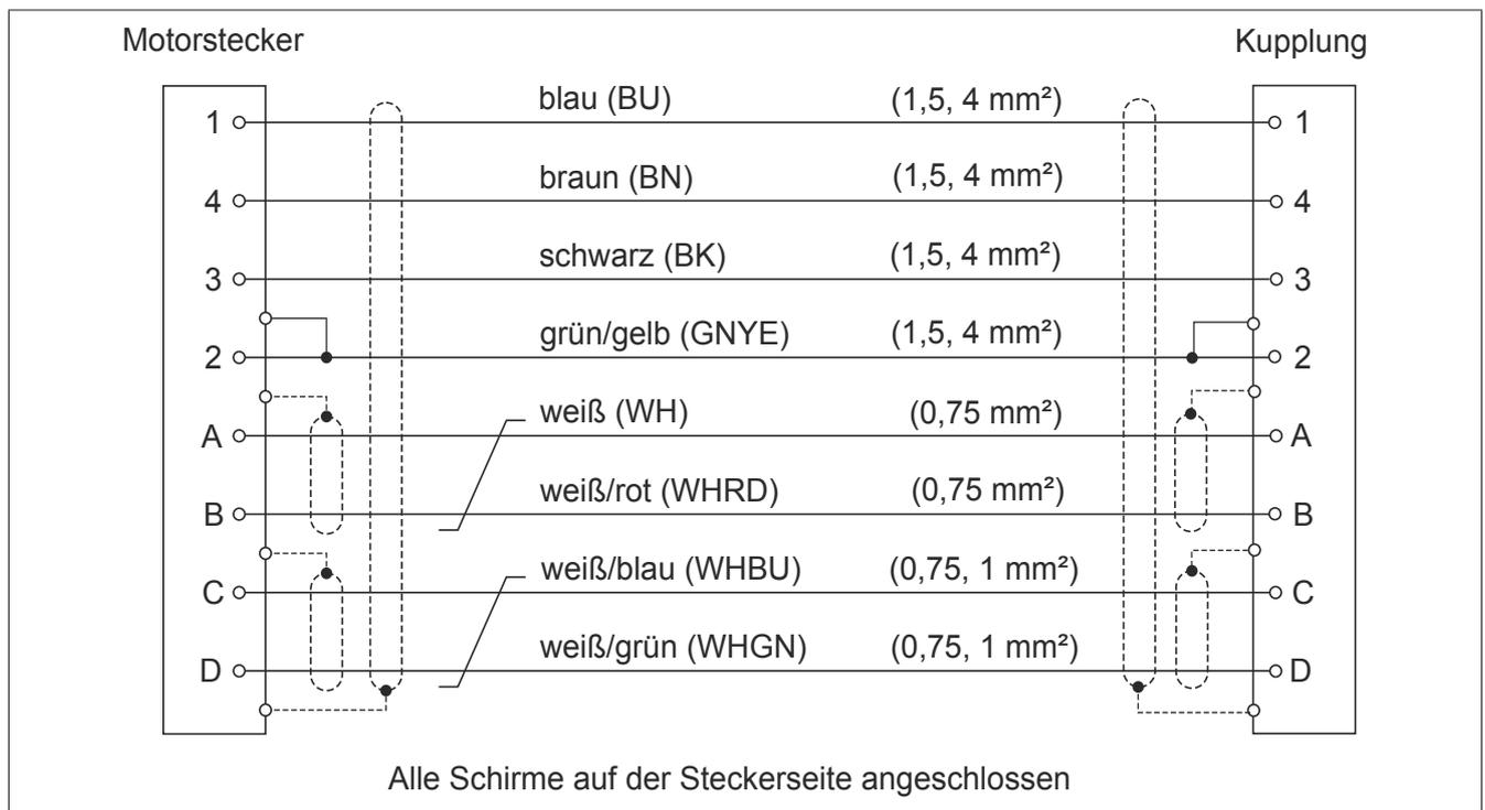
Abbildung 1: Kabelplan Motorkabel
