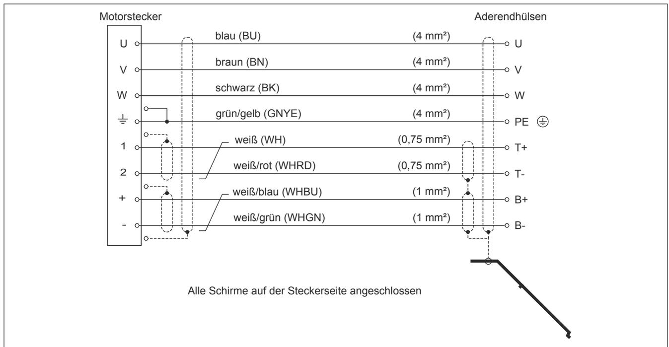
Abbildung 1: Kabelplan Motorkabel 4 mm<sup>2</sup> mit Stecker Größe 1,5
