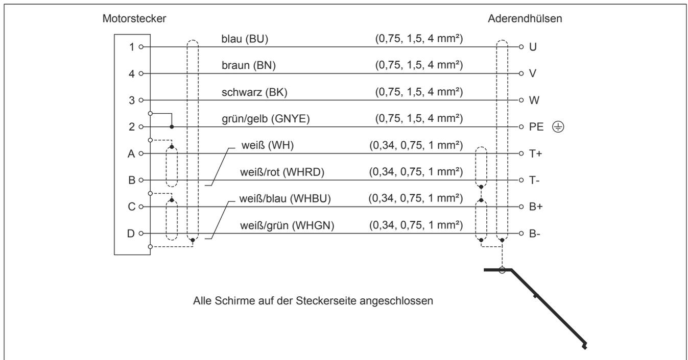
Abbildung 1: Kabelplan ACOPOSmulti Motorkabel mit SpeedTEC Stecker Größe 1
