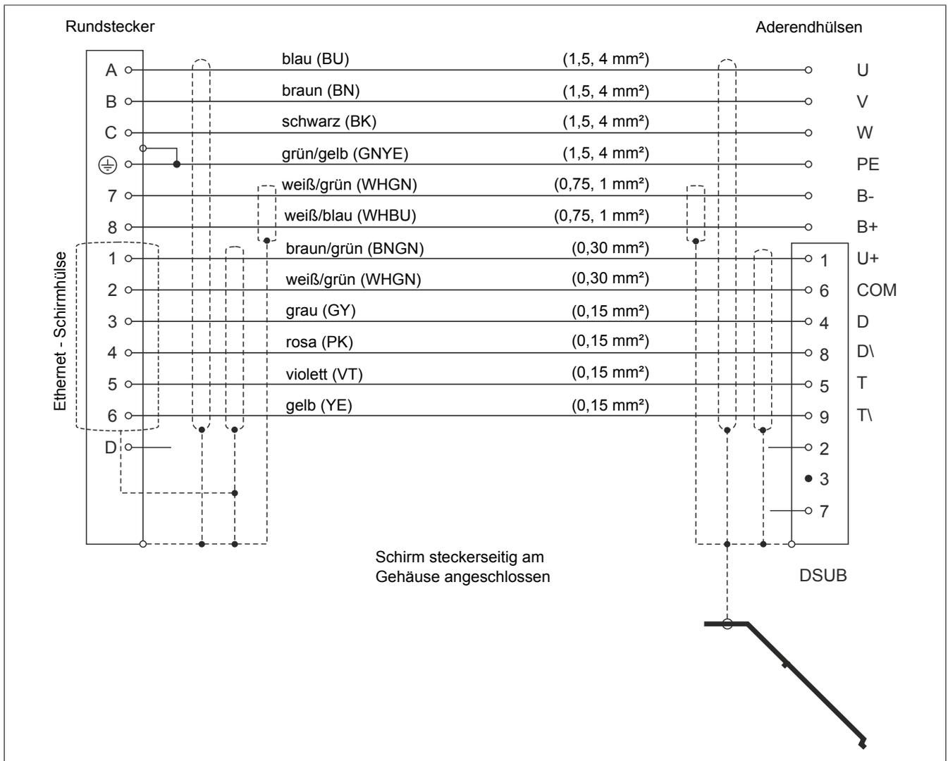
Abbildung 1: Kabelplan Motorhybridkabel
