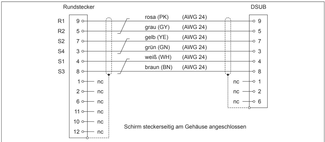
Abbildung 1: Kabelplan Resolverkabel 8BCR
