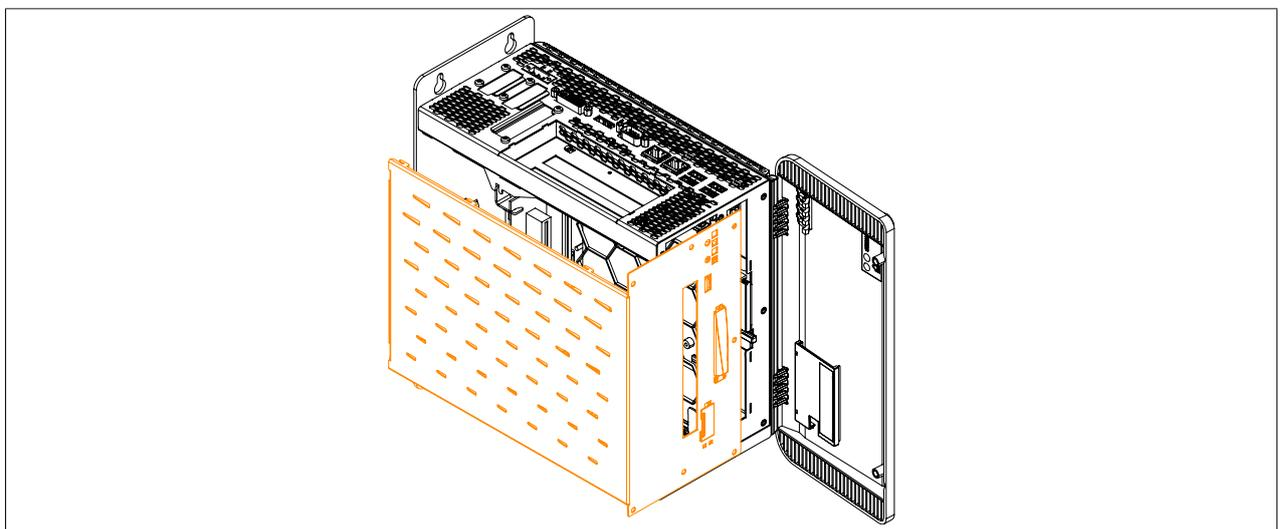
Abbildung 211: Seitenabdeckung entfernen
