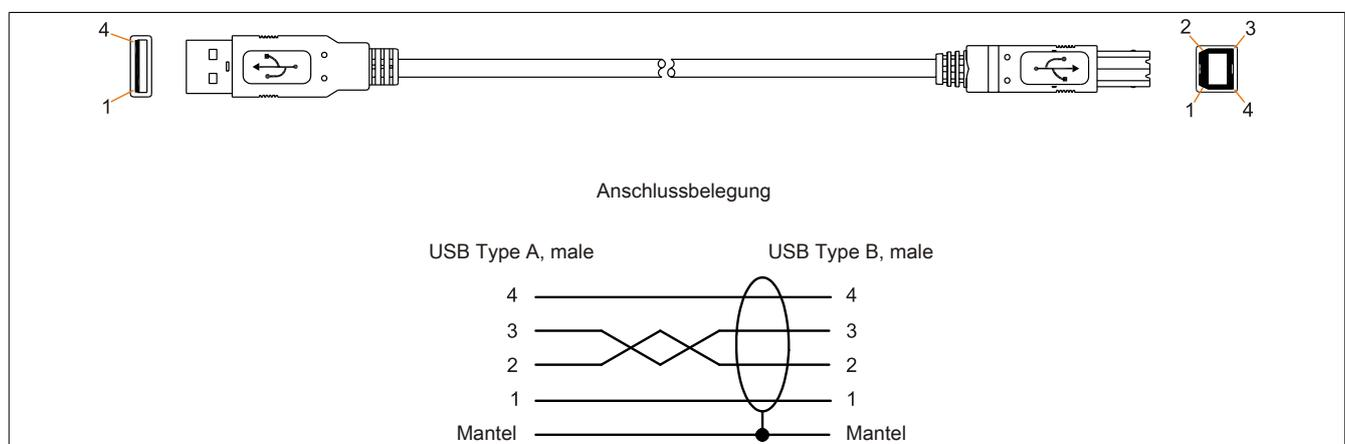
Abbildung 195: 5CAUSB.00xx-00 - Belegung USB Kabel
