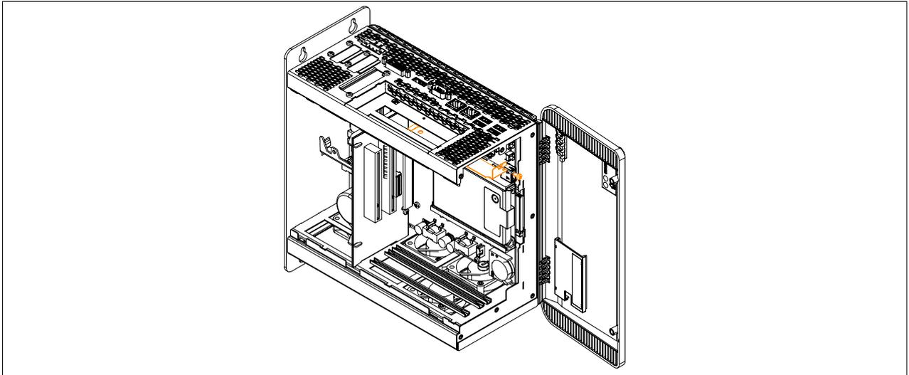
Abbildung 229: PCI-/PCIe-Blindabdeckung entfernen
