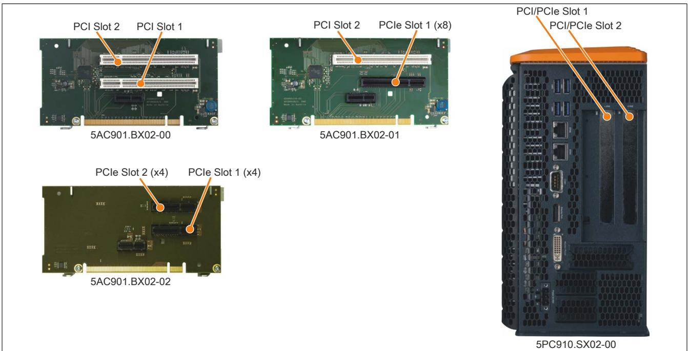
Abbildung 32: 2 Slot Buseinheiten
