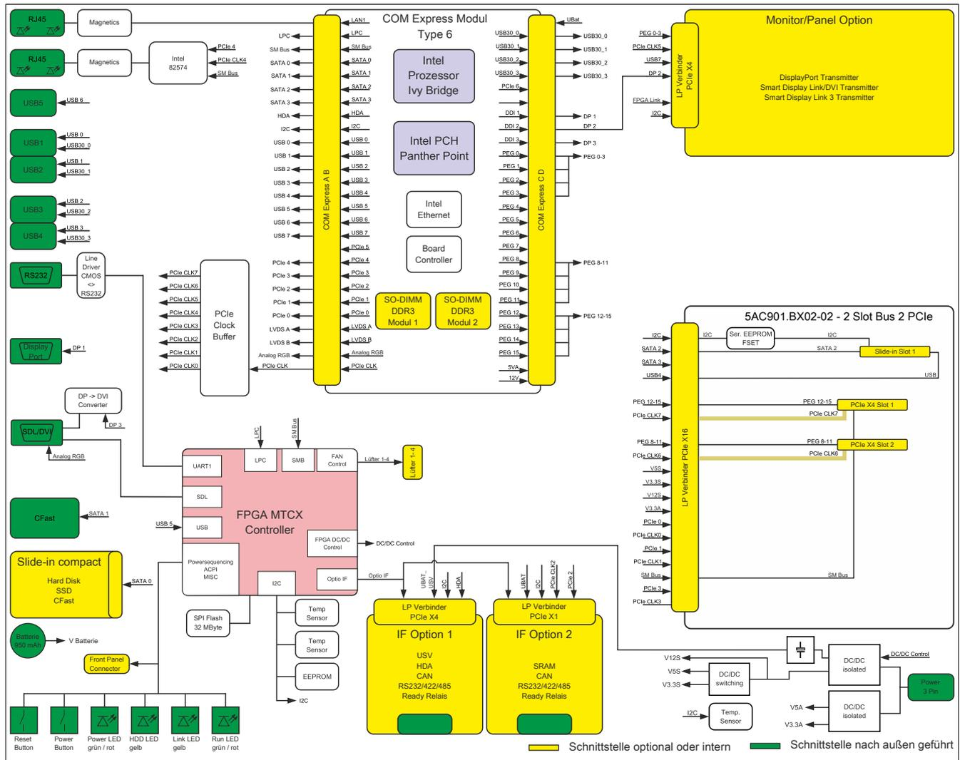
Abbildung 12: Systemeinheit 5PC910.SX02-00 + Buseinheit 5AC901.BX02-02 Blockschaltbild
