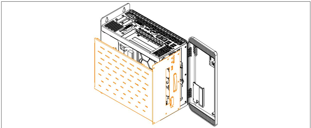
Abbildung 215: Seitenabdeckung montieren
