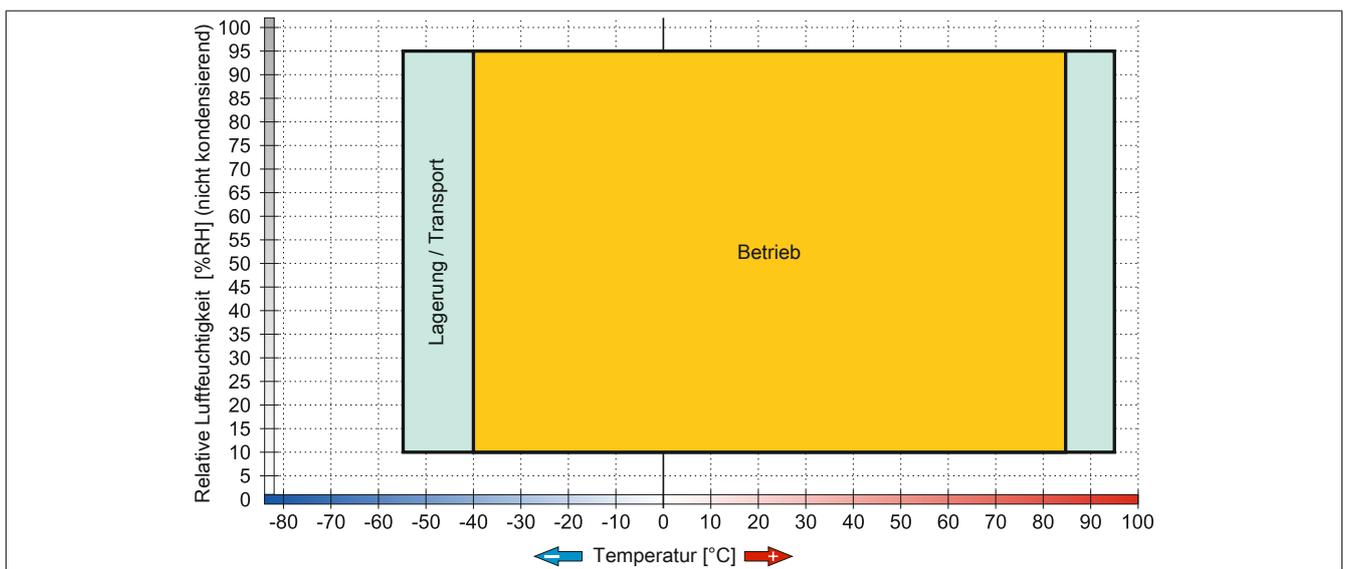
Abbildung 164: 5CFAST.xxxx-10 - Temperatur Luftfeuchtediagramm
