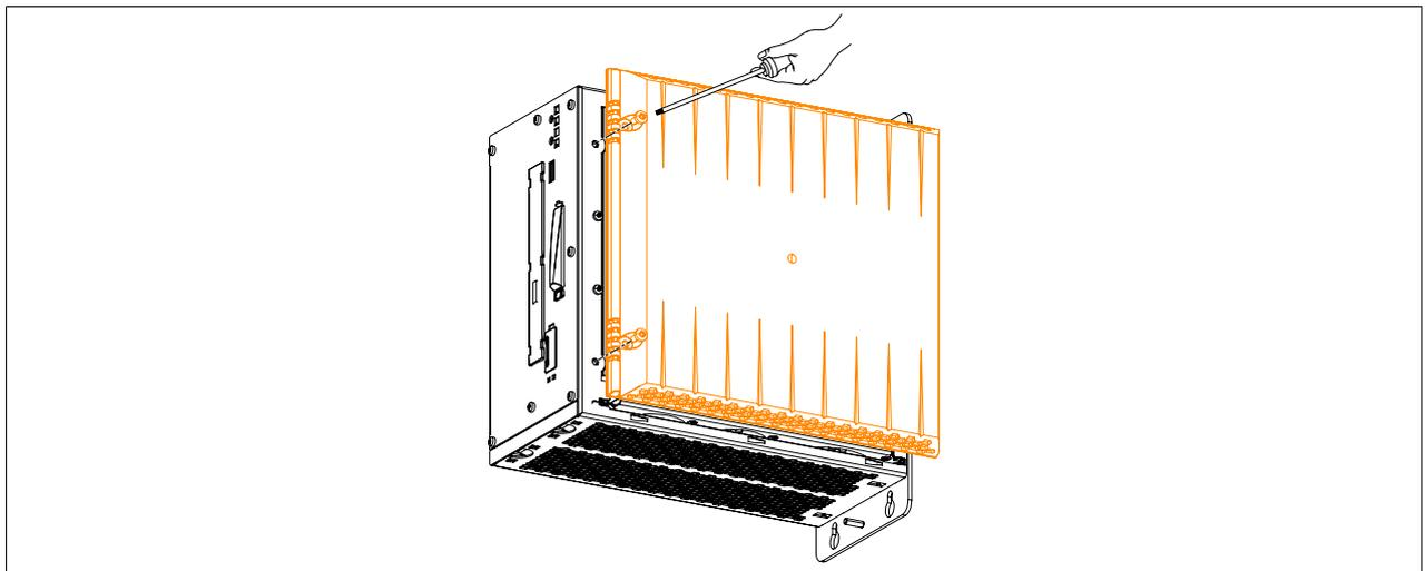
Abbildung 236: Kühlkörperabdeckung demontieren
