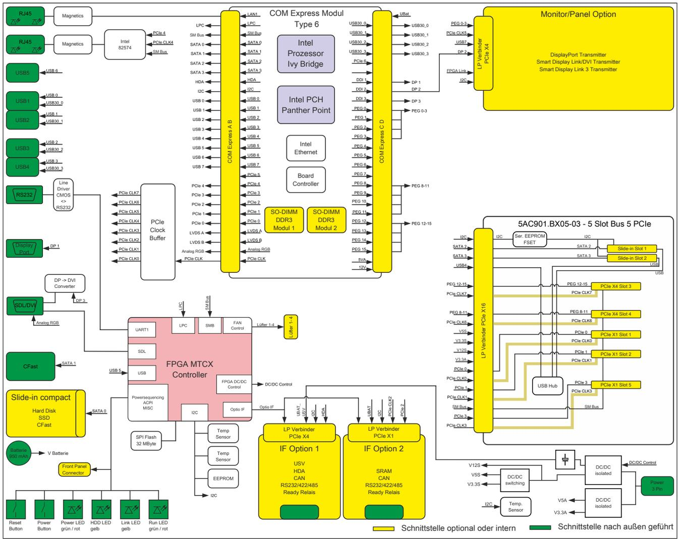
Abbildung 16: Systemeinheit 5PC910.SX05-00 + Buseinheit 5AC901.BX05-03 Blockschaltbild
