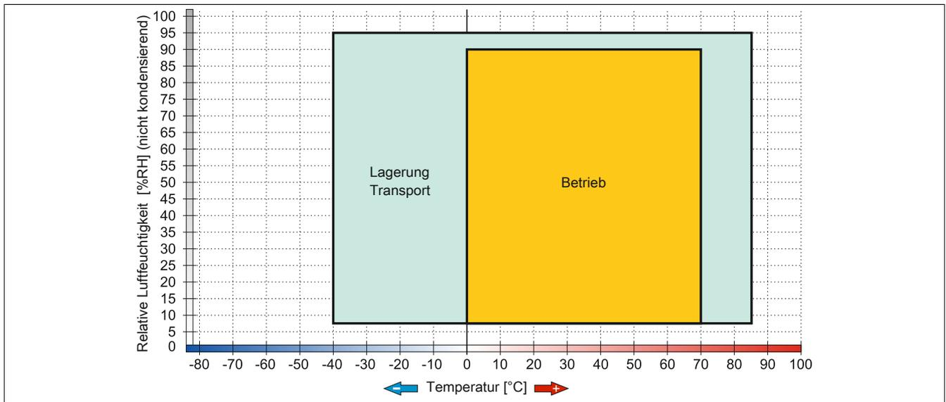
Abbildung 46: 5MMSSD.0060-01 ≤ Rev. C0 - Temperatur Luftfeuchtediagramm
