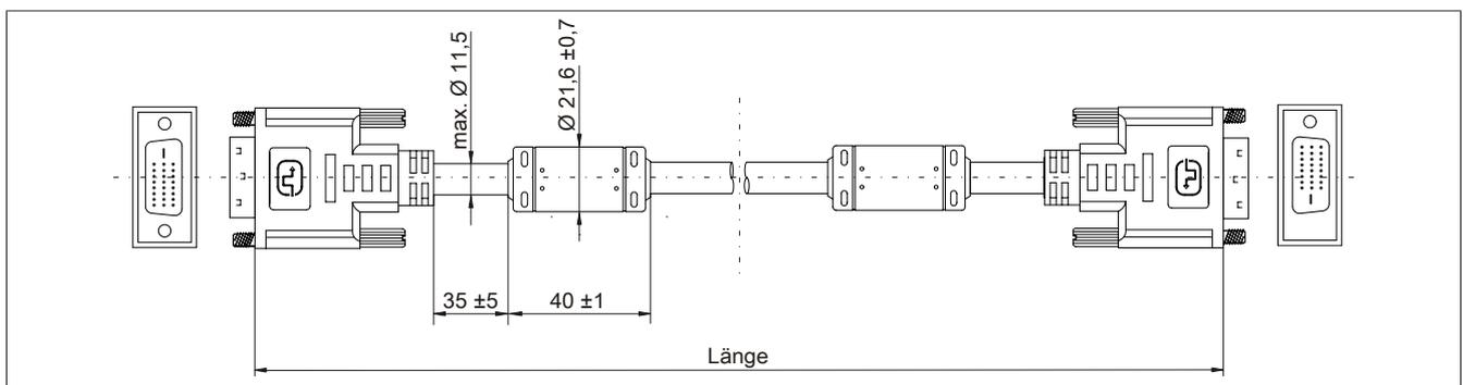
Abbildung 179: 5CASDL.0xxx-00 - Abmessungen
