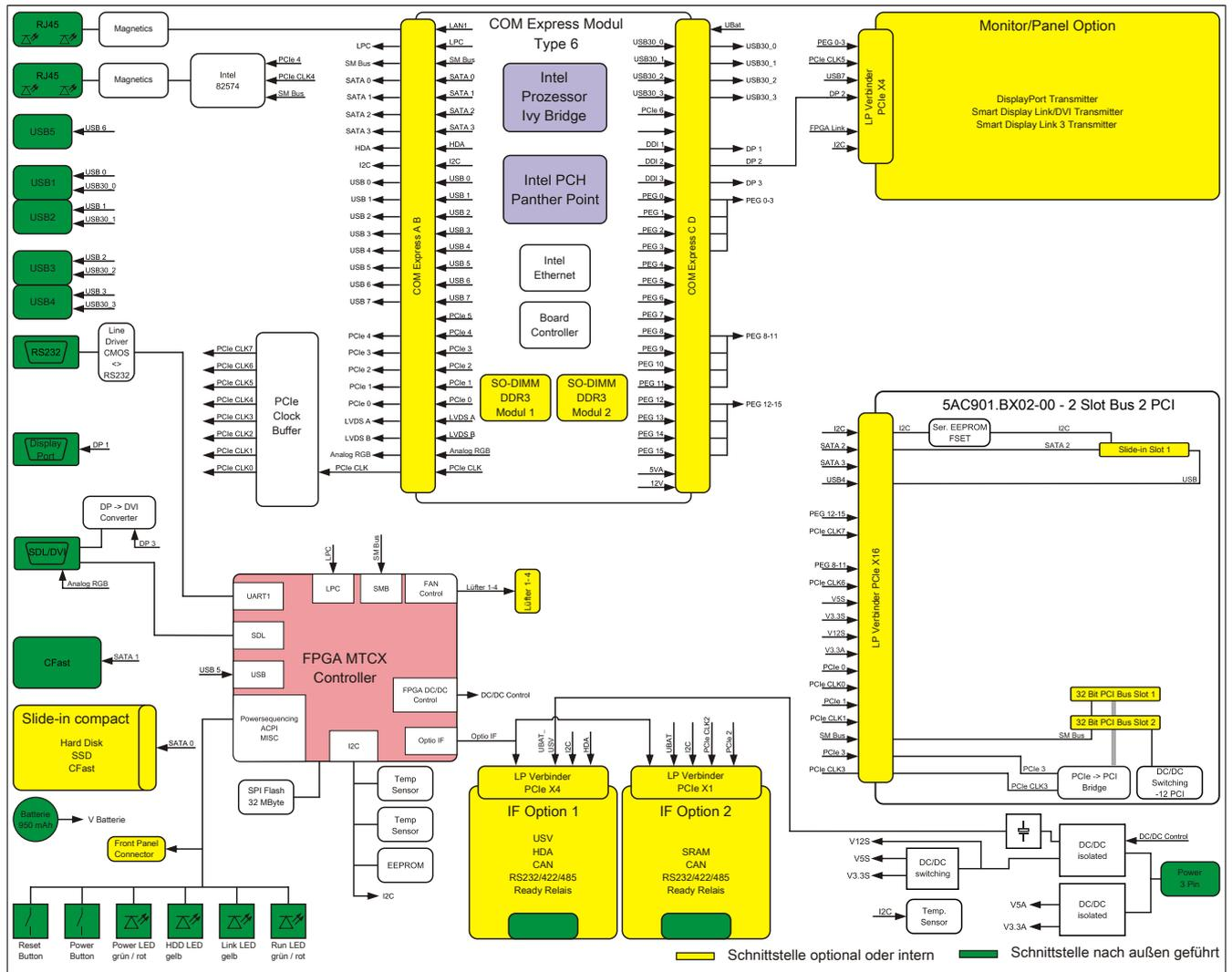
Abbildung 10: Systemeinheit 5PC910.SX02-00 + Buseinheit 5AC901.BX02-00 Blockschaltbild
