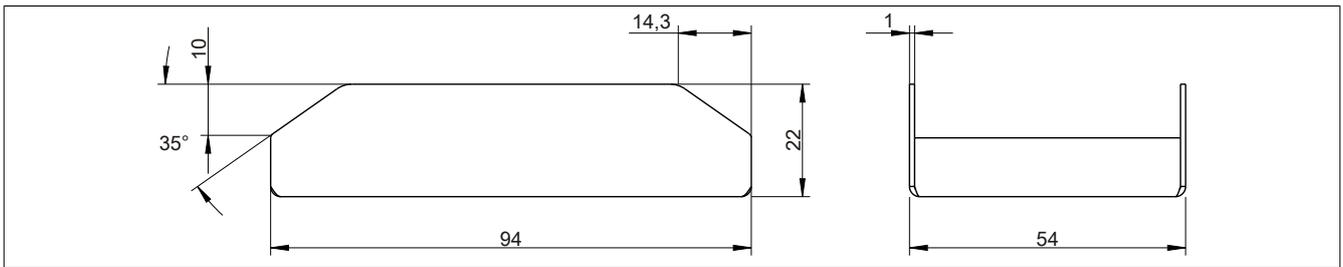
Abbildung 197: 5AC804.MFLT-00 - Abmessungen
