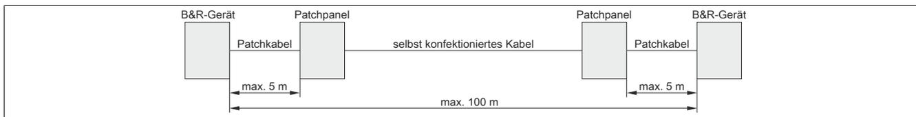
Abbildung 194: Verkabelung mit selbst konfektioniertem Kabel
