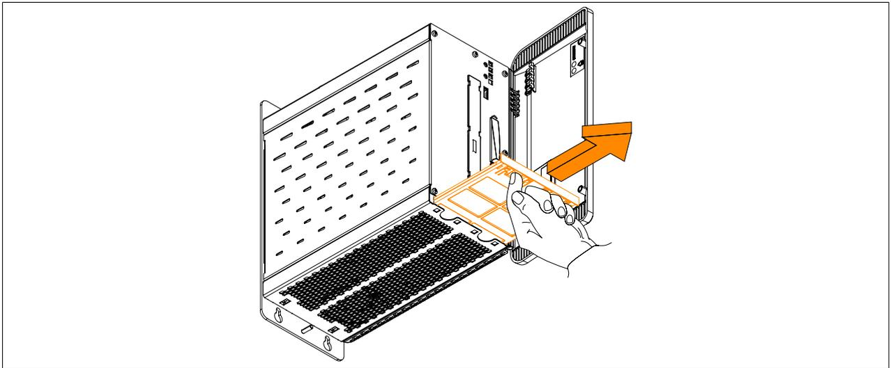
Abbildung 234: Lüfterfilter aus dem APC910 entfernen
