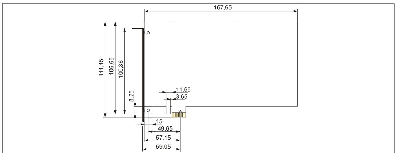
Abbildung 24: Abmessungen Standard half-size PCIe-Karte
