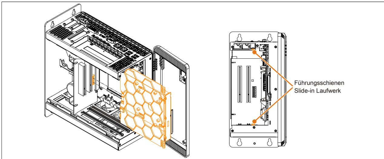
Abbildung 224: Slide-in Laufwerk einbauen bzw. tauschen
