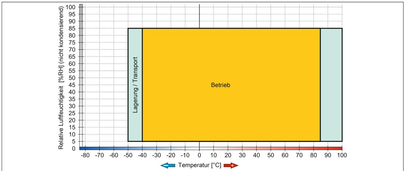
Abbildung 162: 5CFAST.xxxx-00 ≥ Rev. E0 - Temperatur Luftfeuchtediagramm
