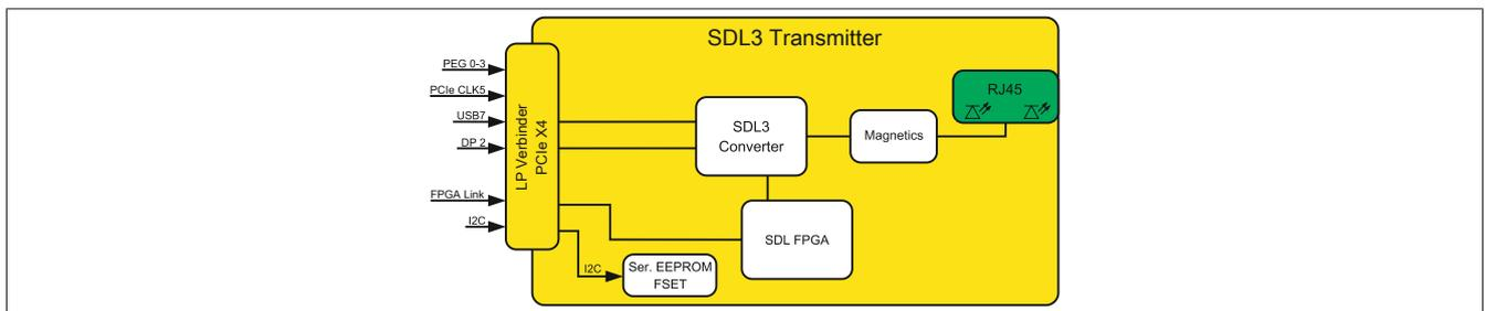
Abbildung 19: Smart Display Link 3 Transmitter 5AC901.LSD3-00 Blockschaltbild
