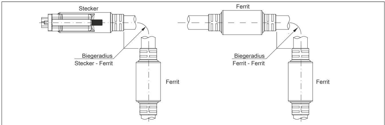
Abbildung 178: Biegeradiusspezifikation
