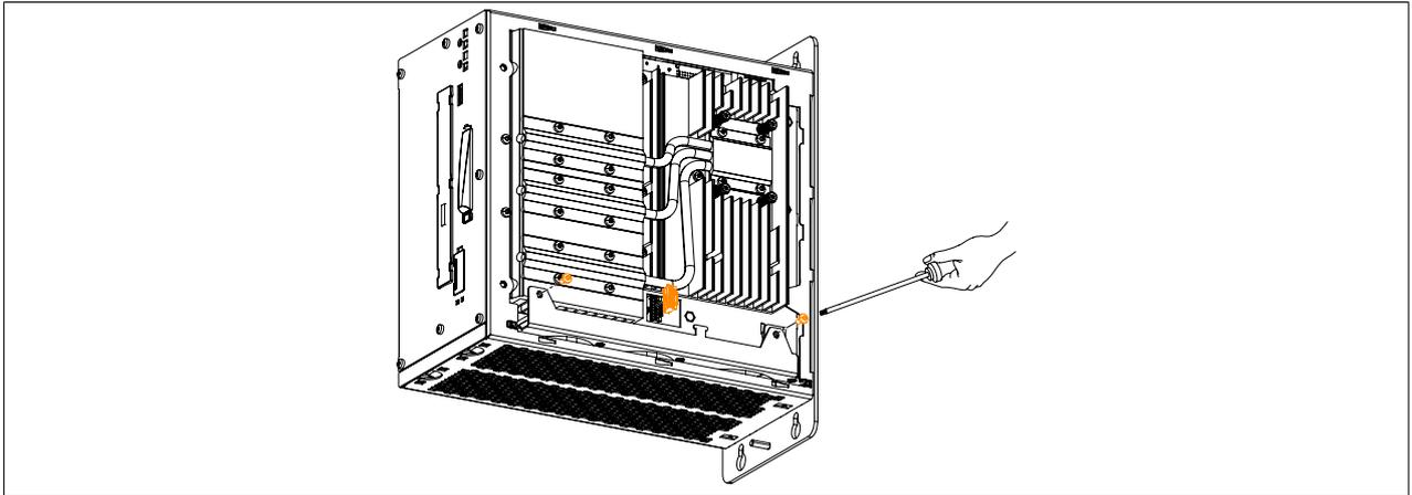
Abbildung 237: Torxschrauben und Lüfterkabel lösen
