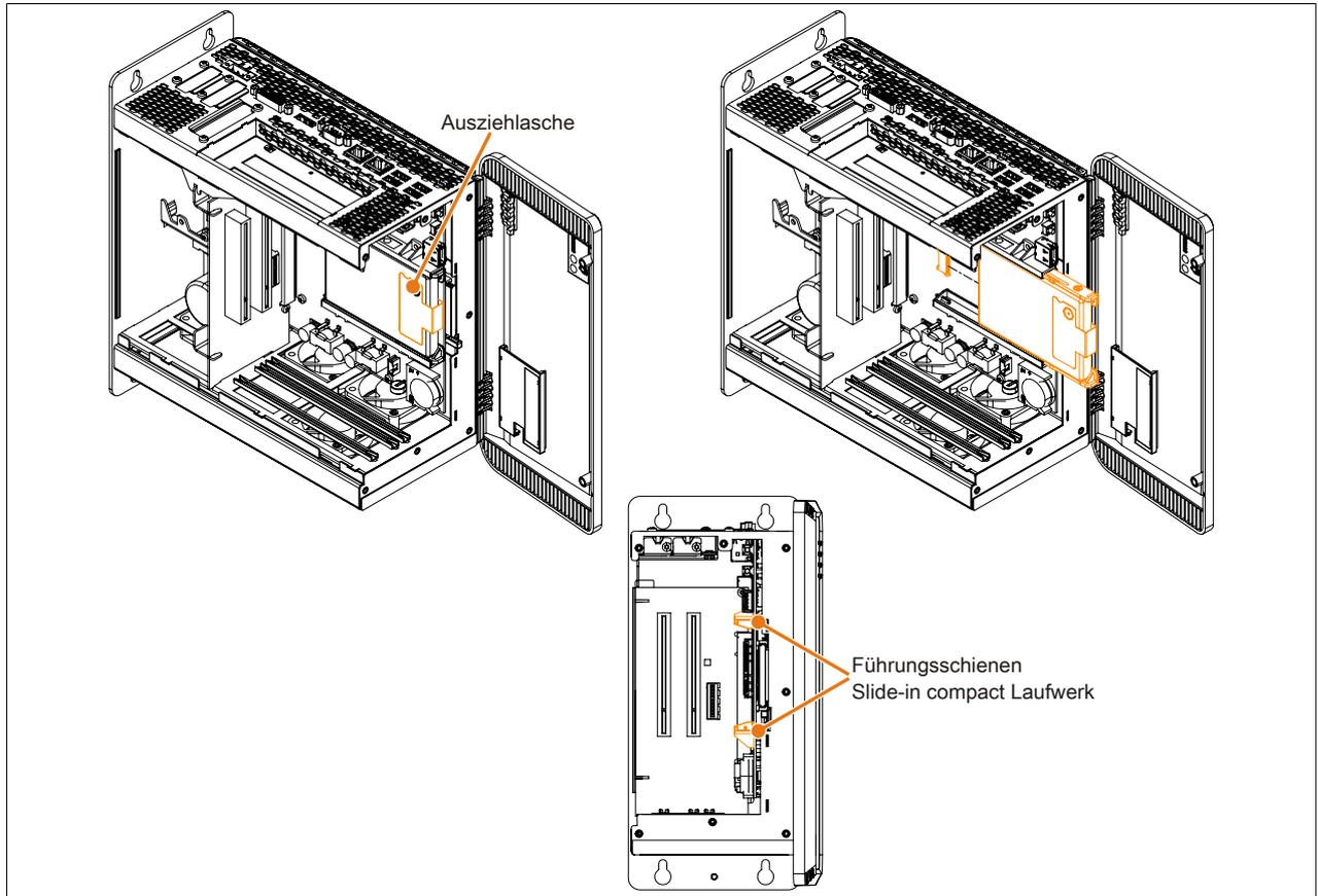
Abbildung 219: Slide-in compact Laufwerk einbauen bzw. tauschen
