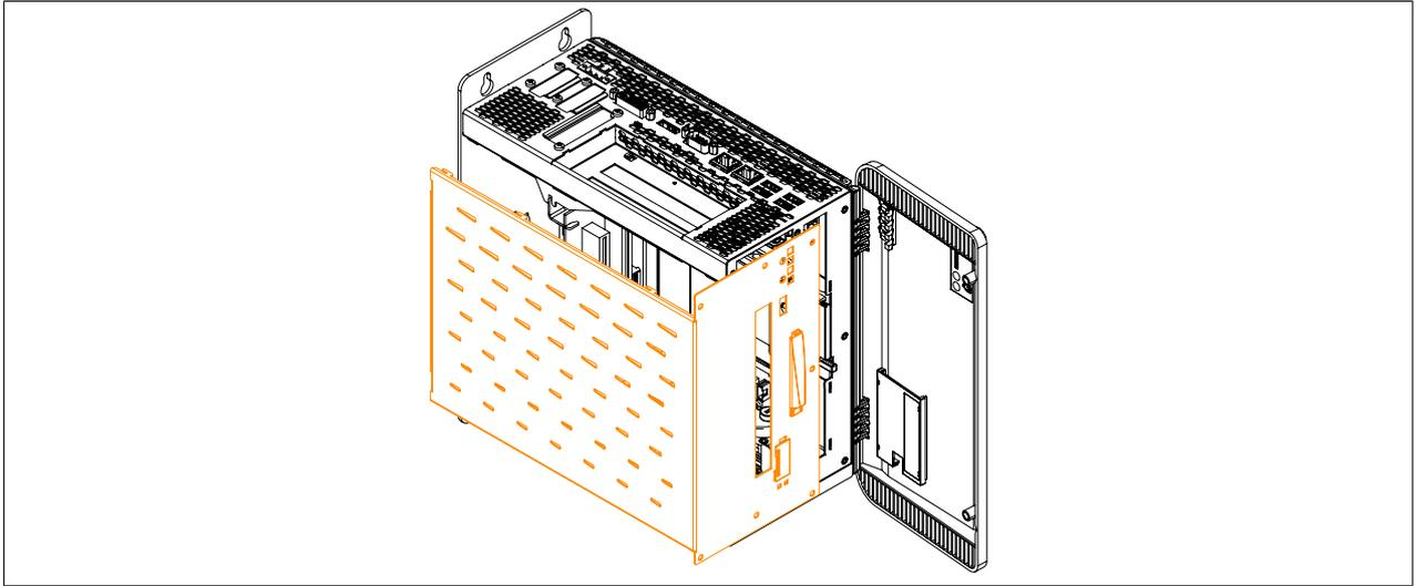
Abbildung 231: Seitenabdeckung montieren
