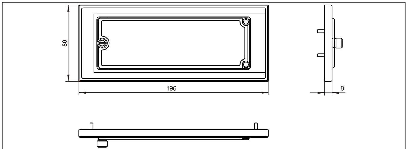
Abbildung 171: 5A5003.03 - Abmessungen
