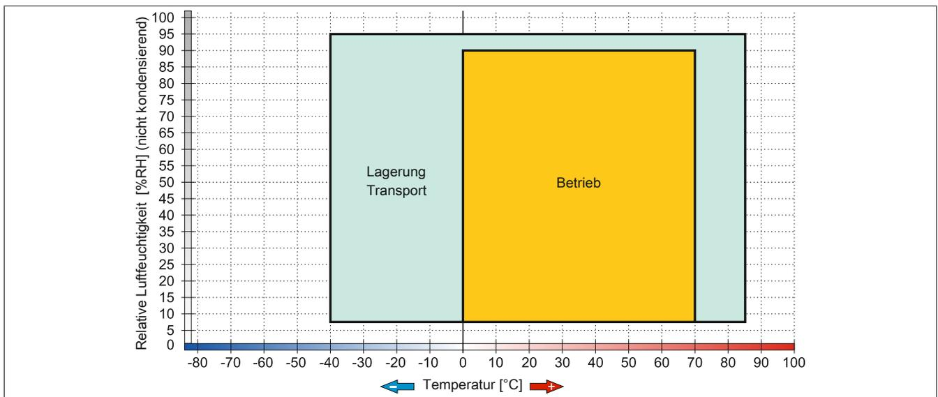
Abbildung 40: 5AC901.CSSD-03 ≤ Rev. C0 - Temperatur Luftfeuchtediagramm
