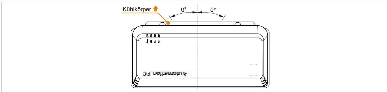
Abbildung 65: Einbaulage - waagrecht
