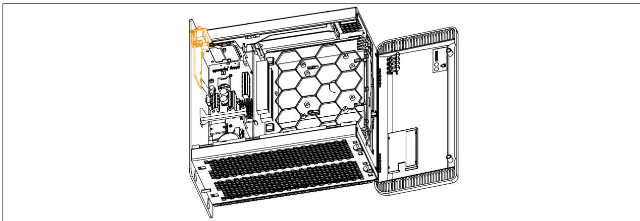
Abbildung 206: Interface Option einbauen
