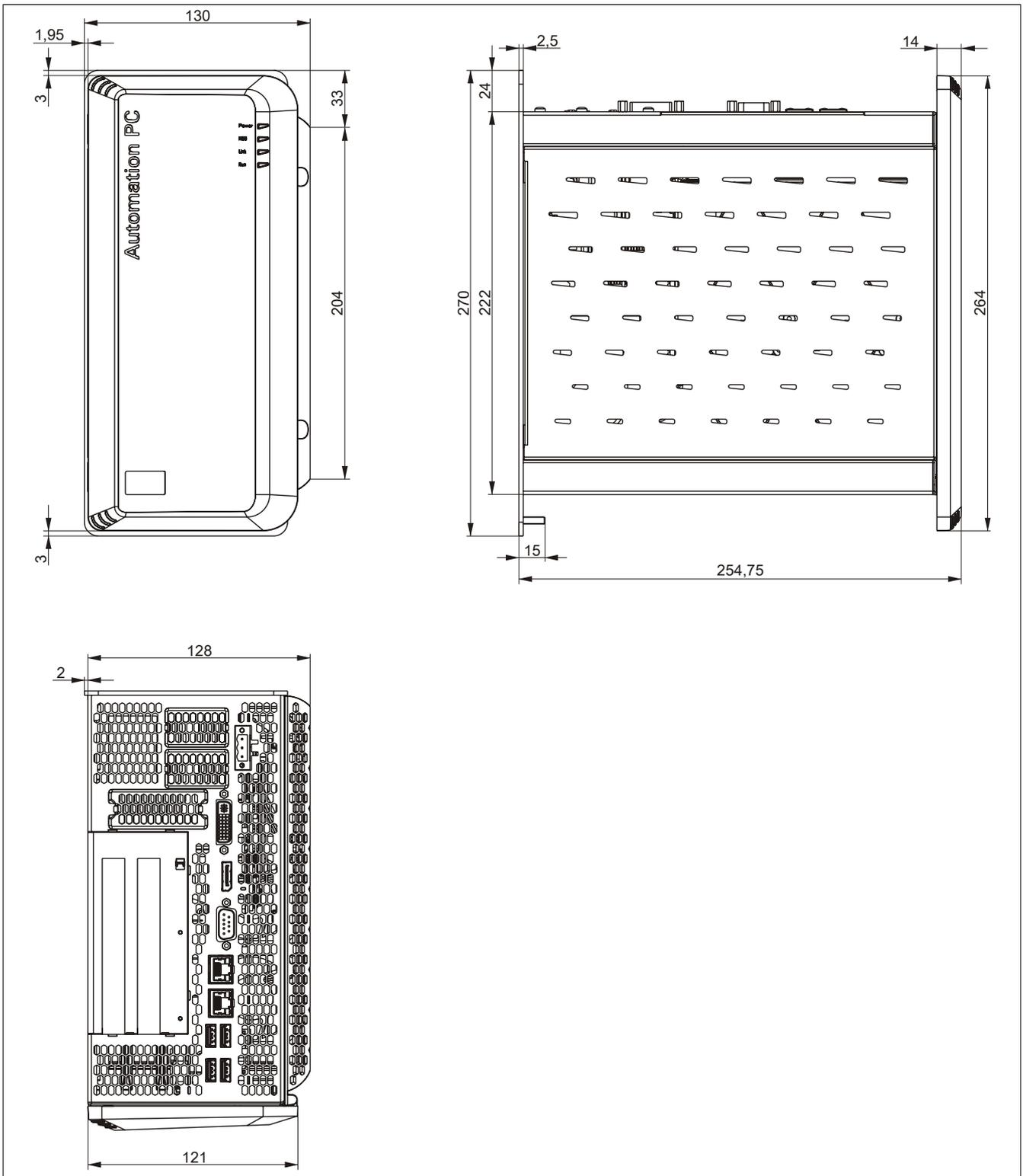
Abbildung 27: 5PC910.SX02-00 - Abmessungen
