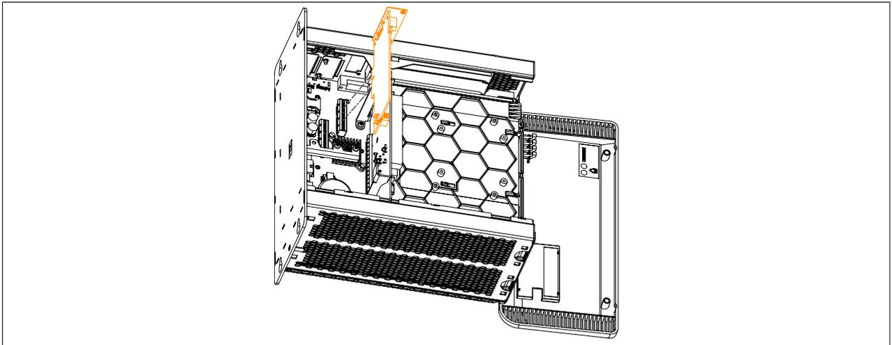
Abbildung 213: Monitor/Panel Option in den APC910 stecken
