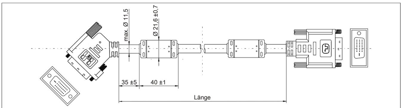
Abbildung 182: 5CASDL.0xxx-01 - Abmessungen
