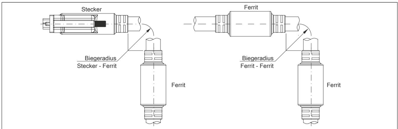
Abbildung 181: Biegeradiusspezifikation
