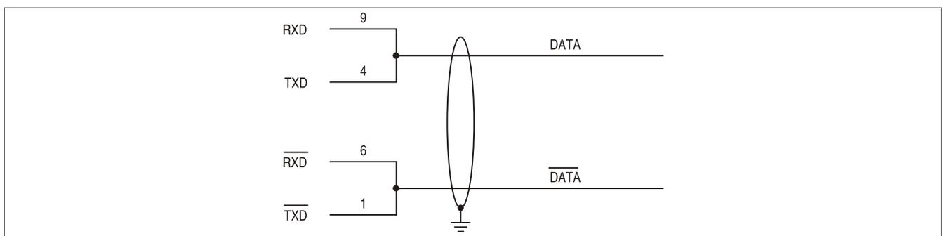
Abbildung 55: RS232/422/485 Interface - Betrieb im RS485 Modus
