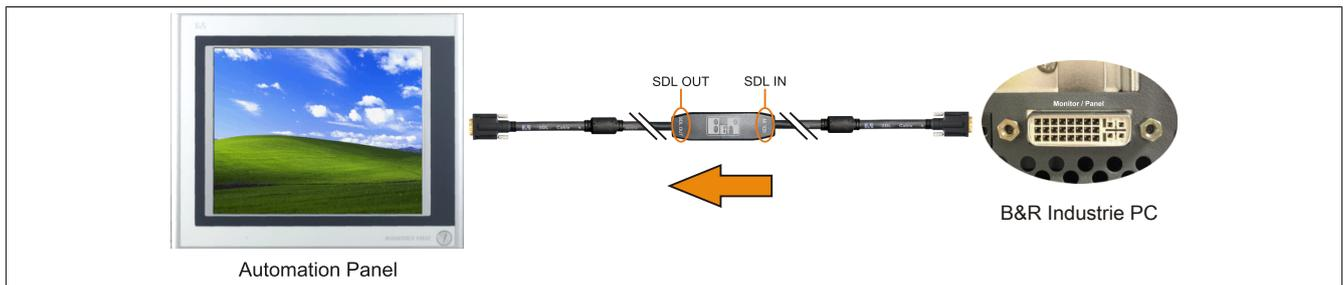
Abbildung 190: Beispiel für die Signalrichtung für das SDL Kabel flex mit Extender
