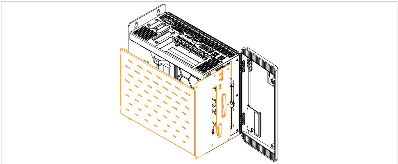
Abbildung 204: Seitenabdeckung entfernen
