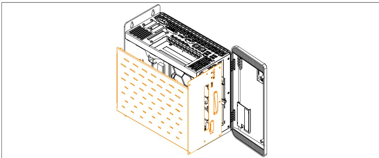
Abbildung 225: Seitenabdeckung montieren
