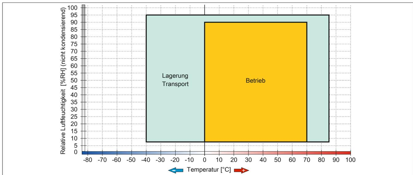
Abbildung 42: 5AC901.CSSD-04 ≤ Rev. C0 - Temperatur Luftfeuchtediagramm
