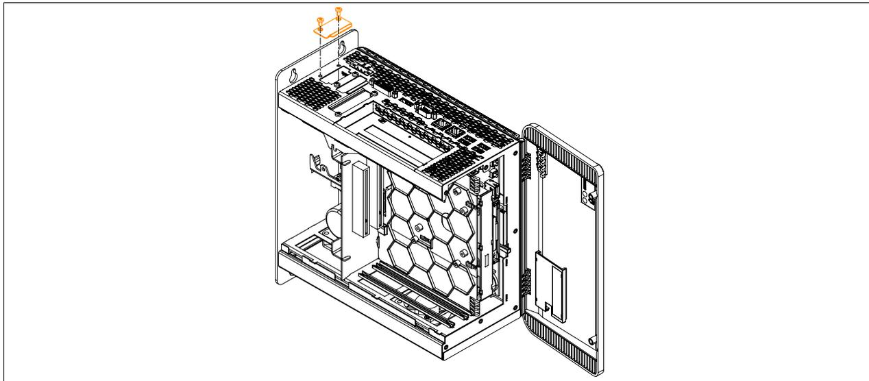
Abbildung 205: Torxschrauben und Blindabdeckung entfernen
