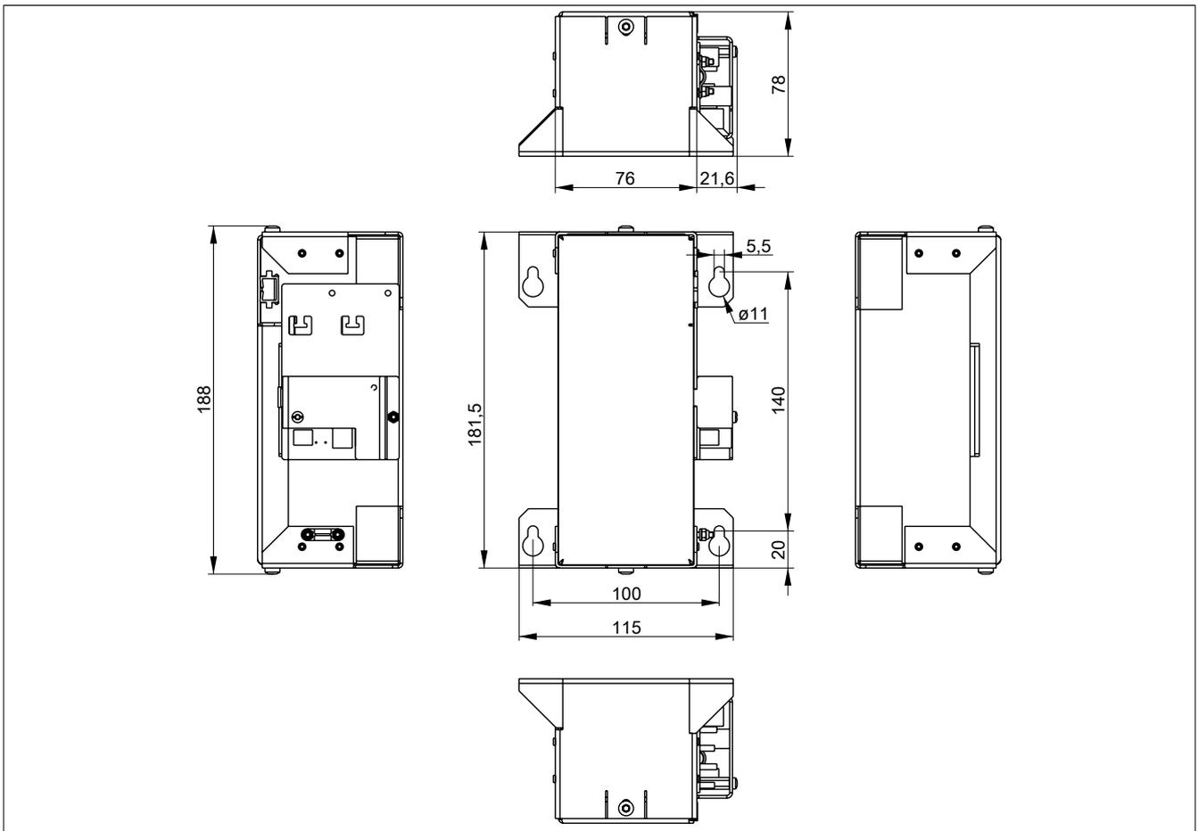
Abbildung 61: 5AC901.BUPS-01 - Abmessungen
