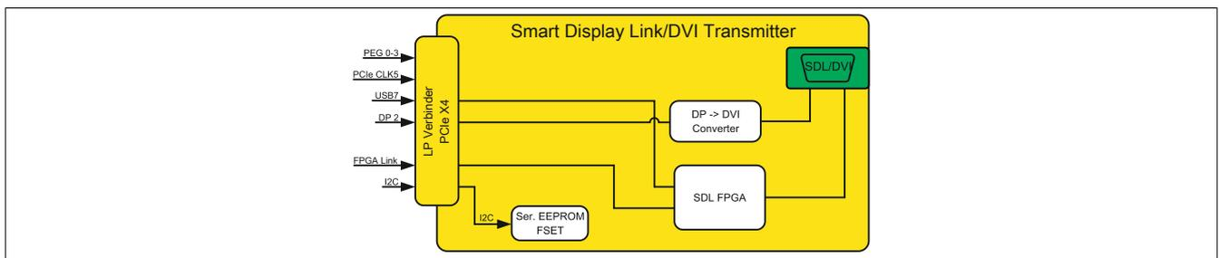
Abbildung 18: Smart Display Link/DVI Transmitter 5AC901.LSDL-00 Blockschaltbild
