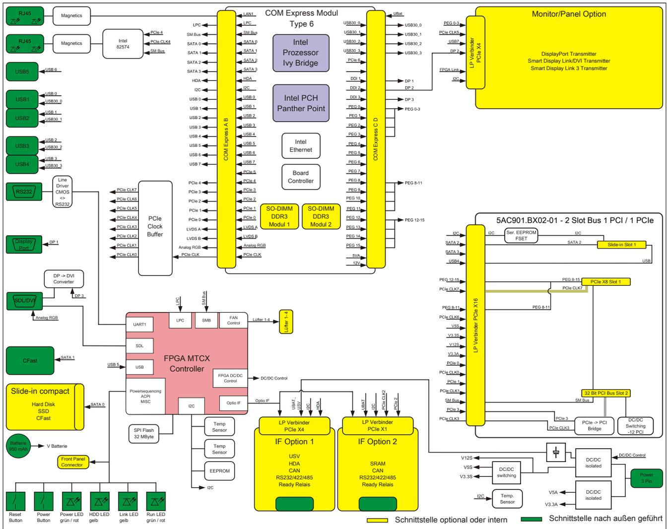
Abbildung 11: Systemeinheit 5PC910.SX02-00 + Buseinheit 5AC901.BX02-01 Blockschaltbild
