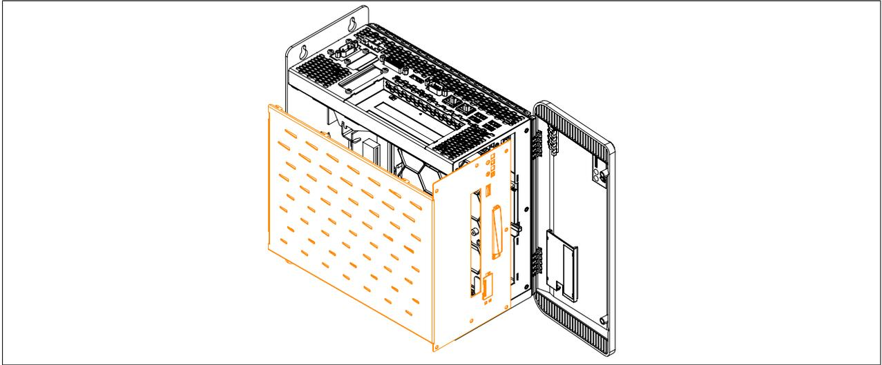
Abbildung 208: Seitenabdeckung montieren
