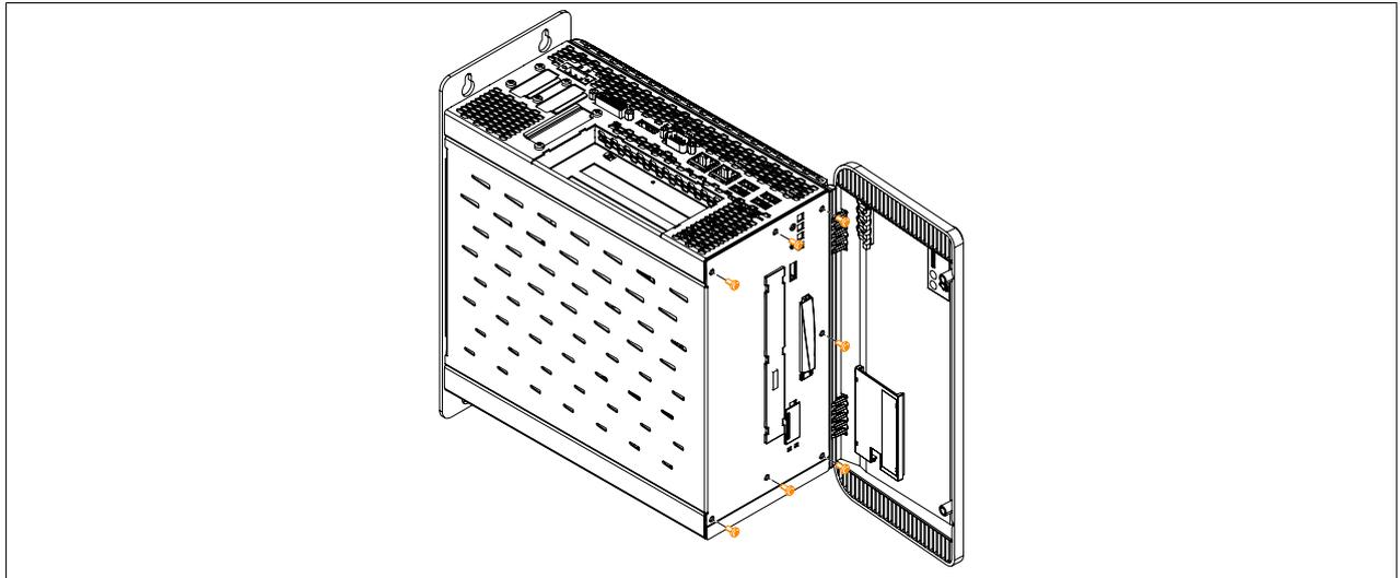
Abbildung 227: Torxschrauben der Seitenabdeckung lösen
