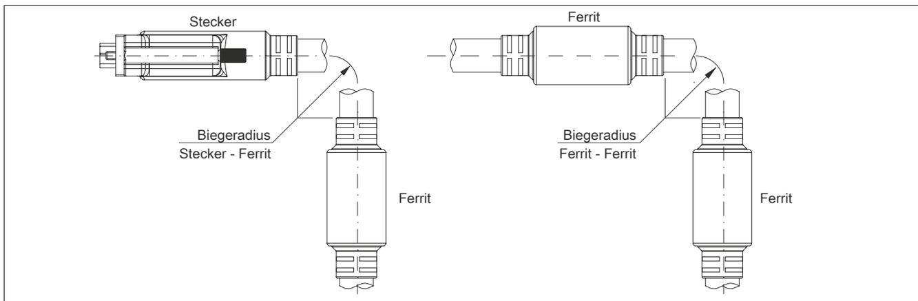
Abbildung 184: Biegeradiusspezifikation
