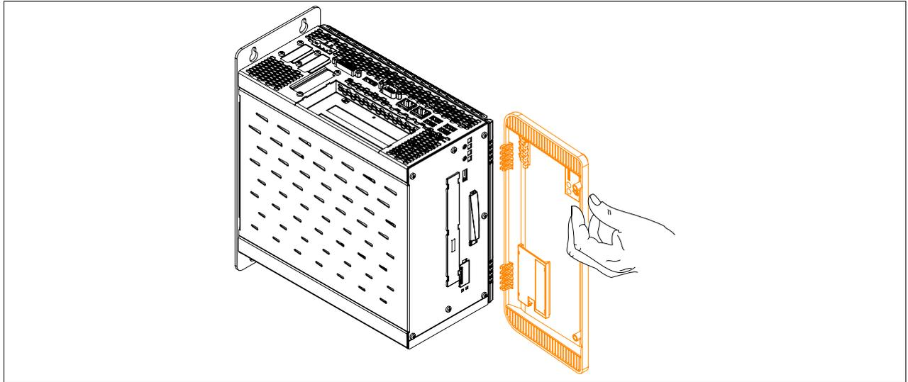
Abbildung 235: Frontklappe entfernen
