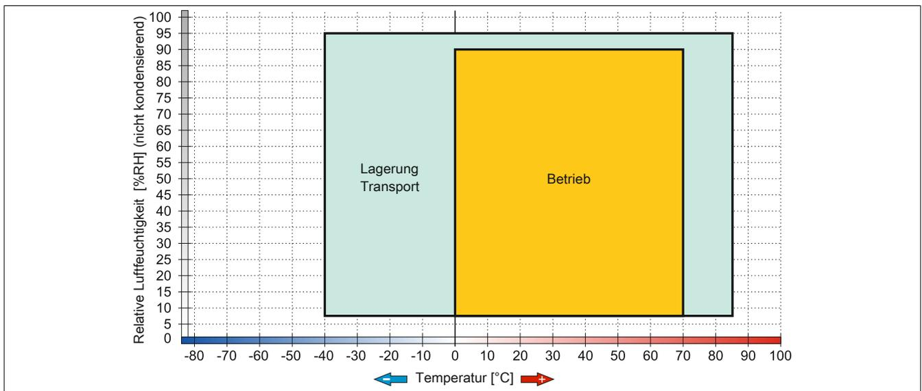
Abbildung 48: 5MMSSD.0128-01 ≤ Rev. C0 - Temperatur Luftfeuchtediagramm
