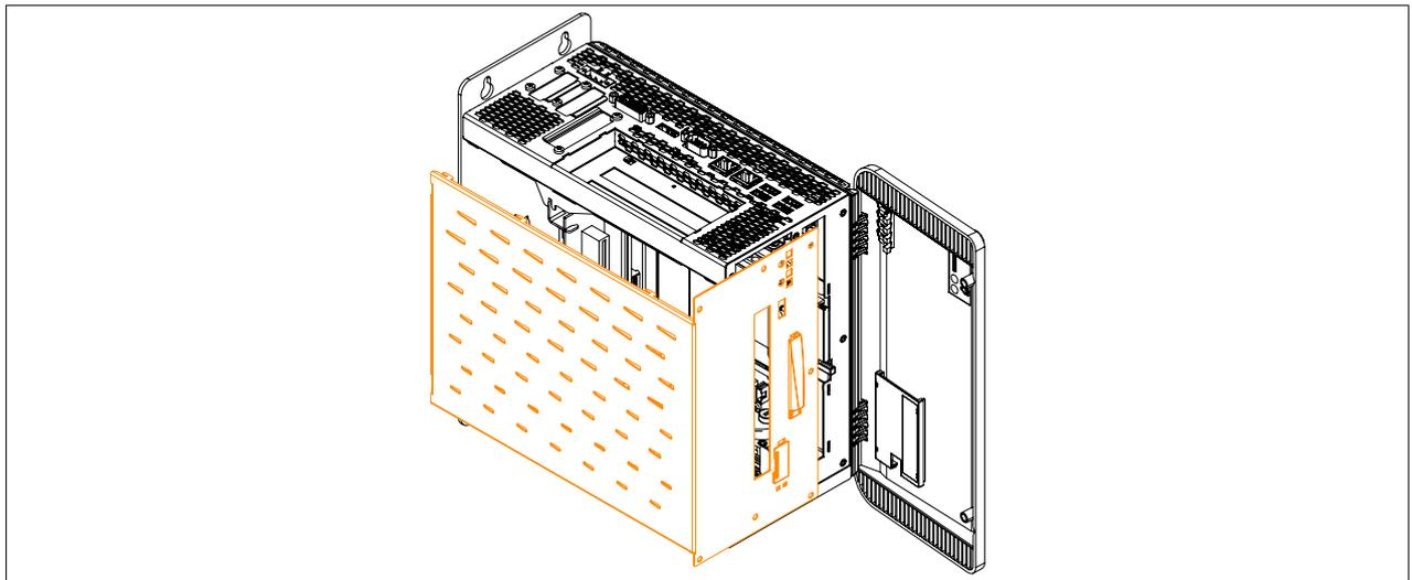
Abbildung 220: Seitenabdeckung montieren
