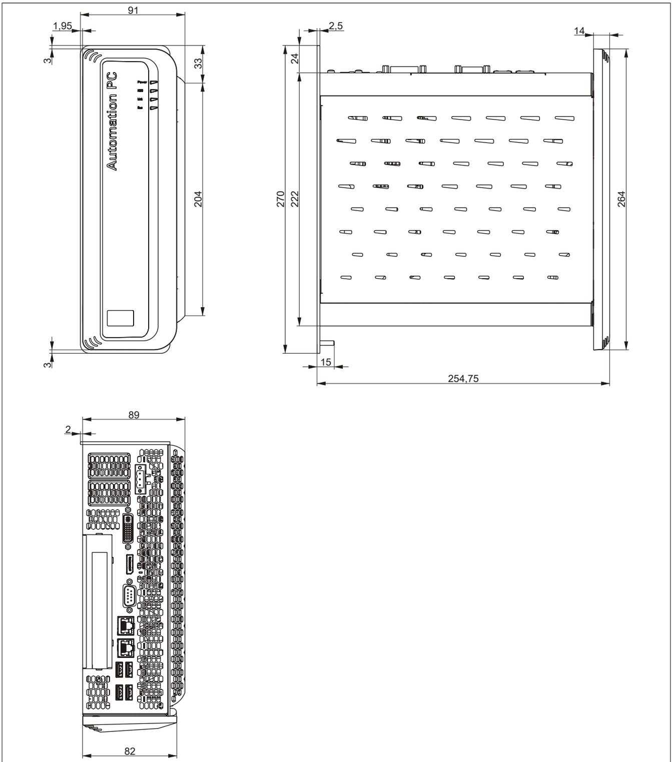
Abbildung 25: 5PC910.SX01-00 - Abmessungen
