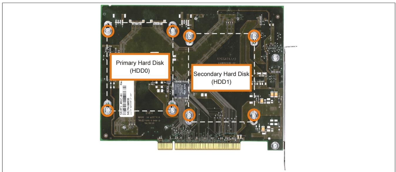
Abbildung 244: Rückseite des SATA RAID Controllers 5ACPCI.RAIC-03 Schraubenzuordnung
