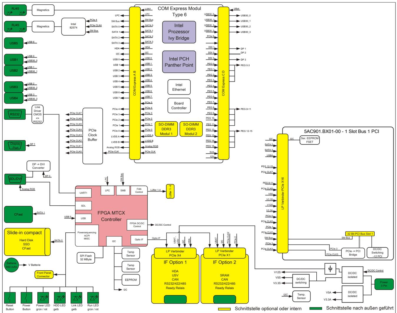
Abbildung 8: Systemeinheit 5PC910.SX01-00 + Buseinheit 5AC901.BX01-00 Blockschaltbild
