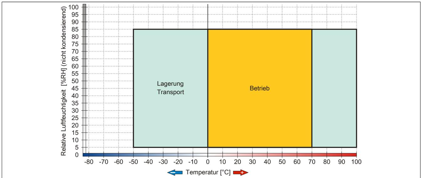
Abbildung 163: 5CFAST.xxxx-00 ≤ Rev. D0 - Temperatur Luftfeuchtediagramm
