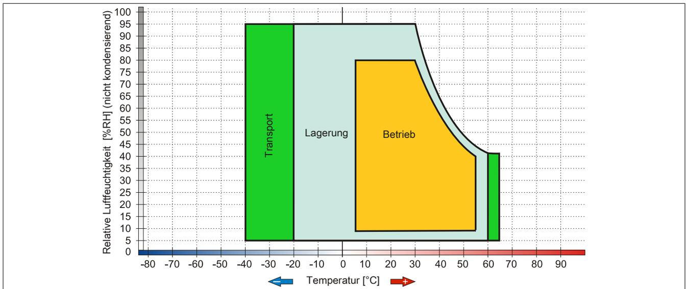
Abbildung 52: 5AC901.SDVW-00 - Temperatur Luftfeuchtediagramm
