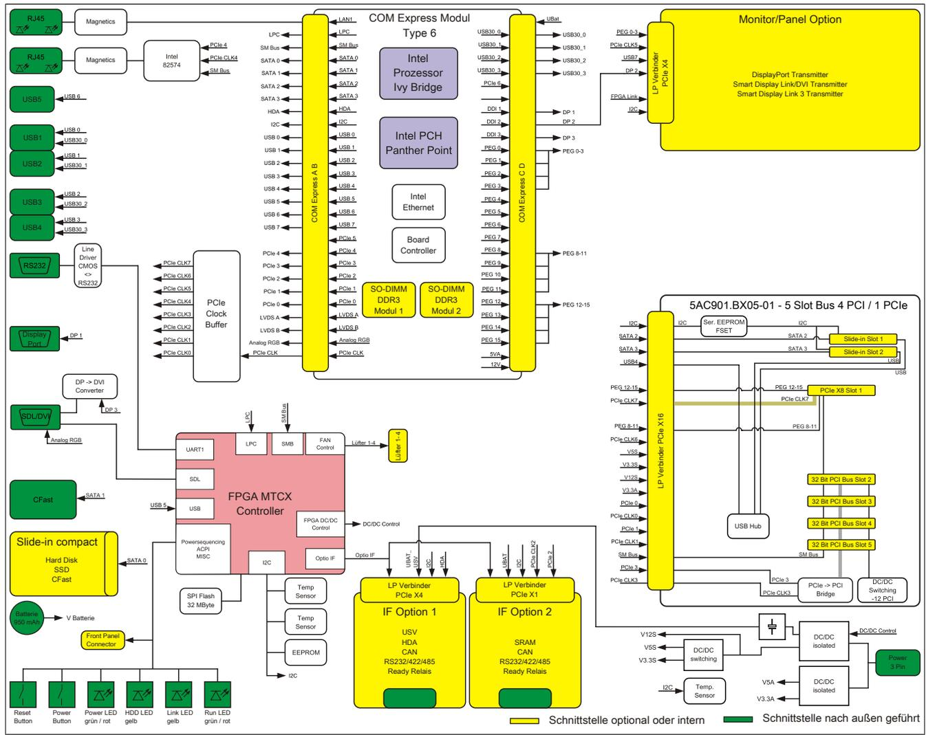
Abbildung 14: Systemeinheit 5PC910.SX05-00 + Buseinheit 5AC901.BX05-01 Blockschaltbild
