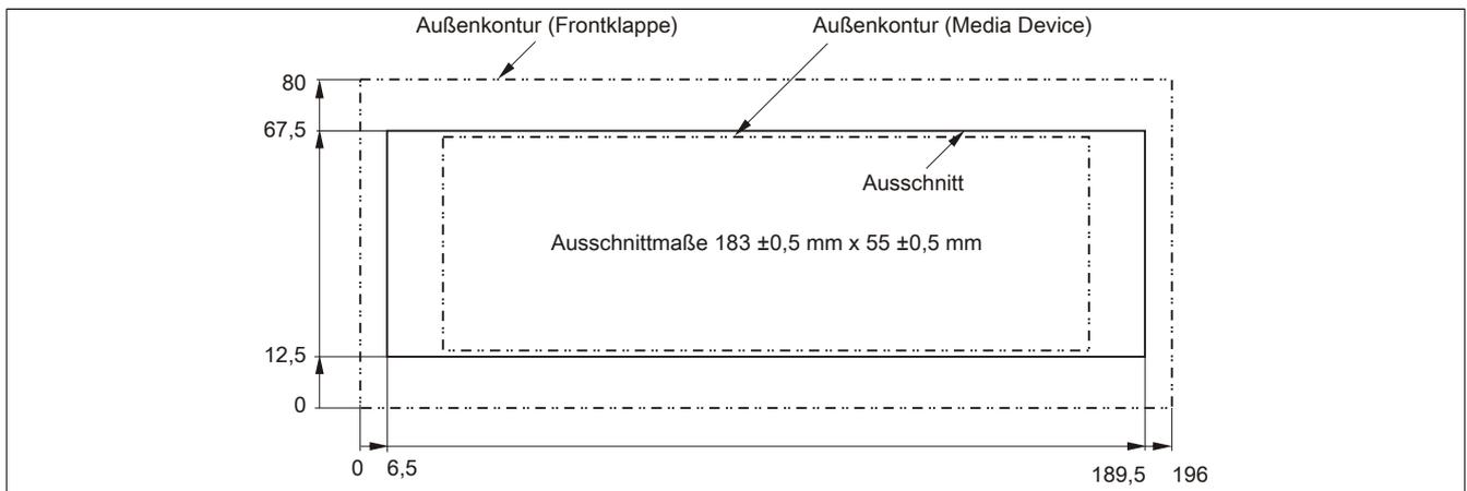
Abbildung 173: Einbauausschnitt USB Media Drive mit Frontklappe
