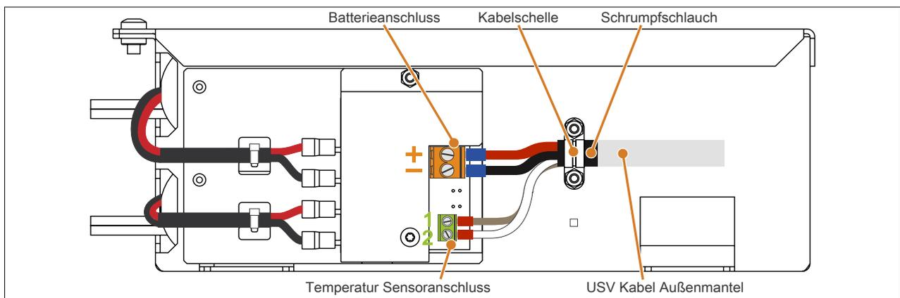
Abbildung 233: Anschluss des USV Kabels an die Batterie
