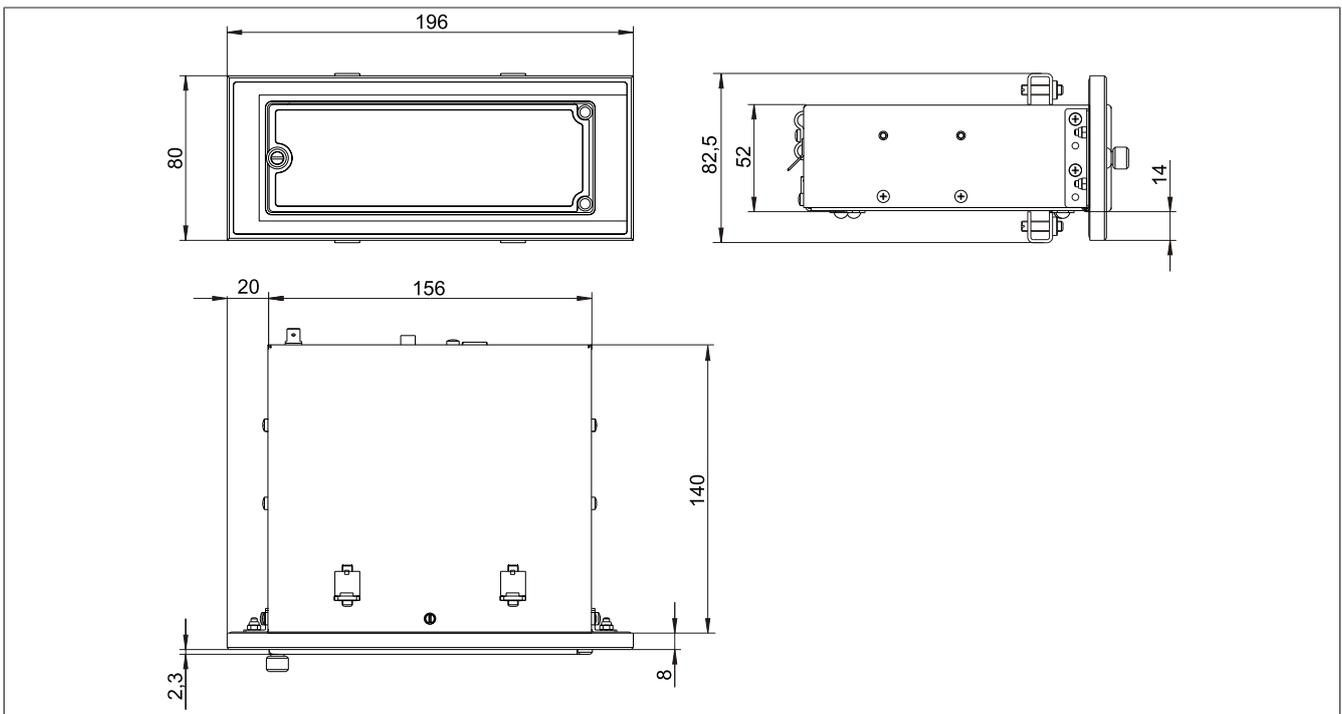
Abbildung 168: Abmessungen USB Media Drive mit Frontklappe
