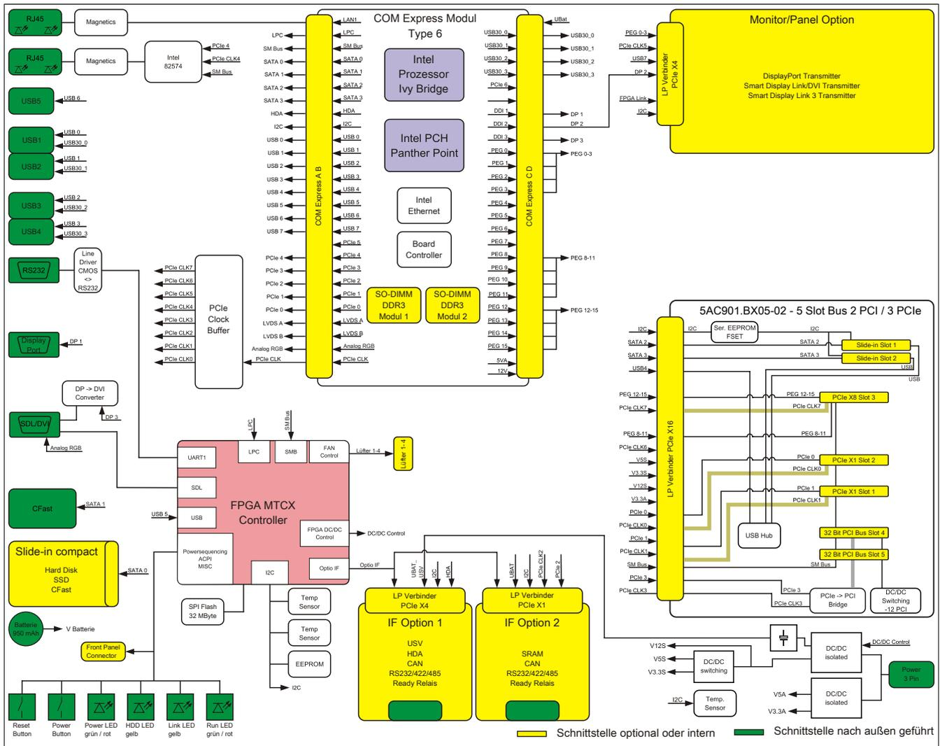
Abbildung 15: Systemeinheit 5PC910.SX05-00 + Buseinheit 5AC901.BX05-02 Blockschaltbild
