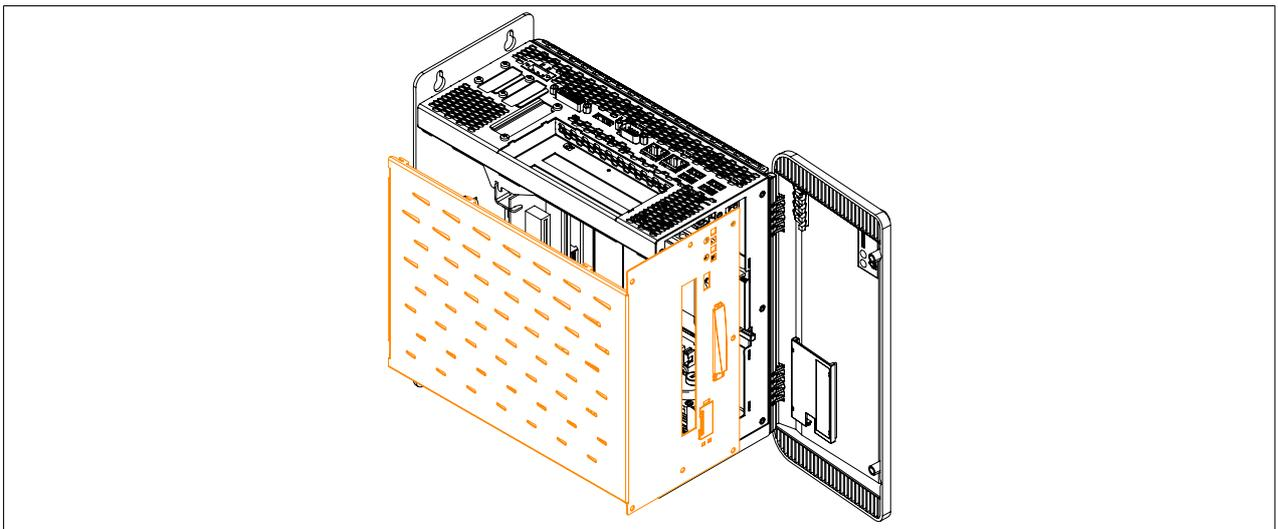
Abbildung 218: Seitenabdeckung entfernen
