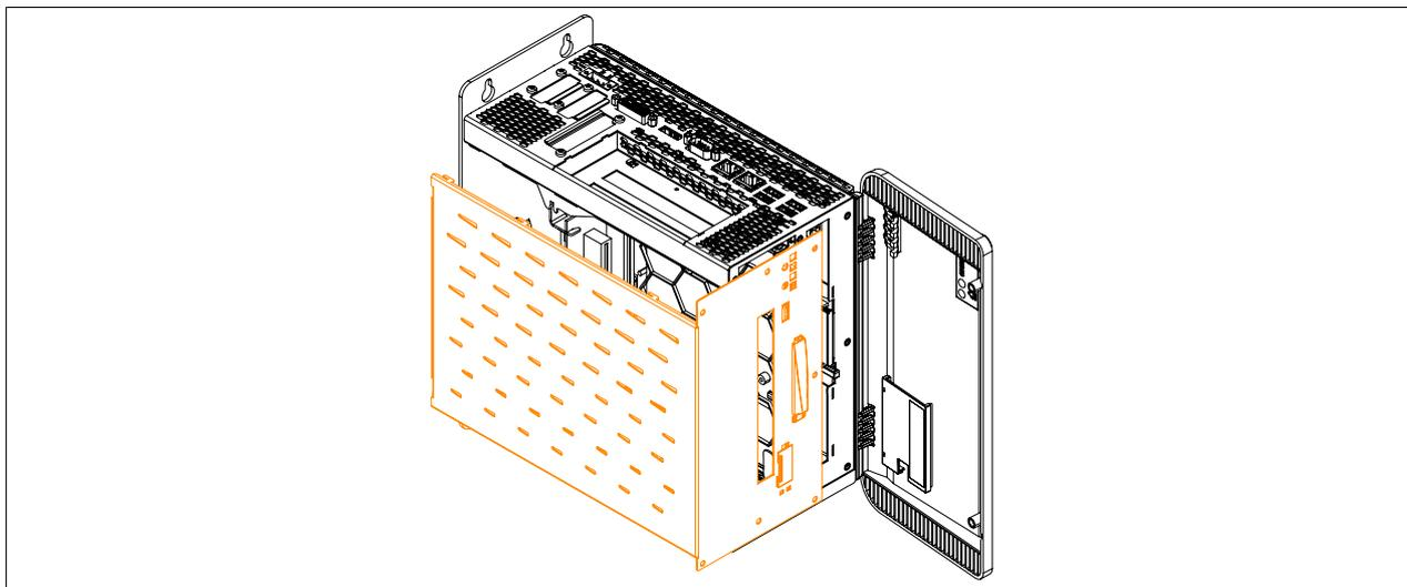
Abbildung 240: Seitenabdeckung entfernen
