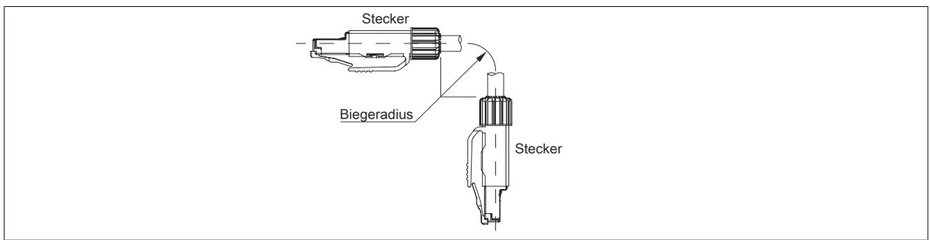
Abbildung 191: Biegeradiusspezifikation SDL3
