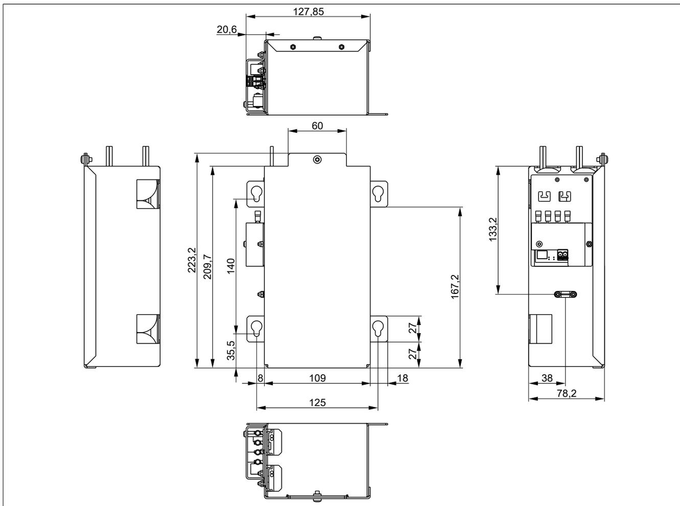
Abbildung 59: 5AC901.BUPS-00 - Abmessungen
