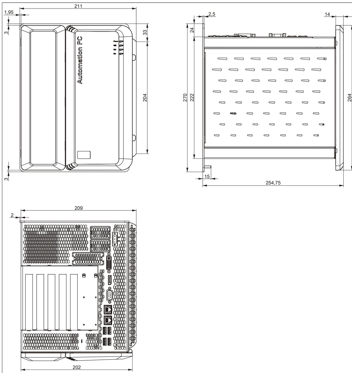
Abbildung 29: 5PC910.SX05-00 - Abmessungen
