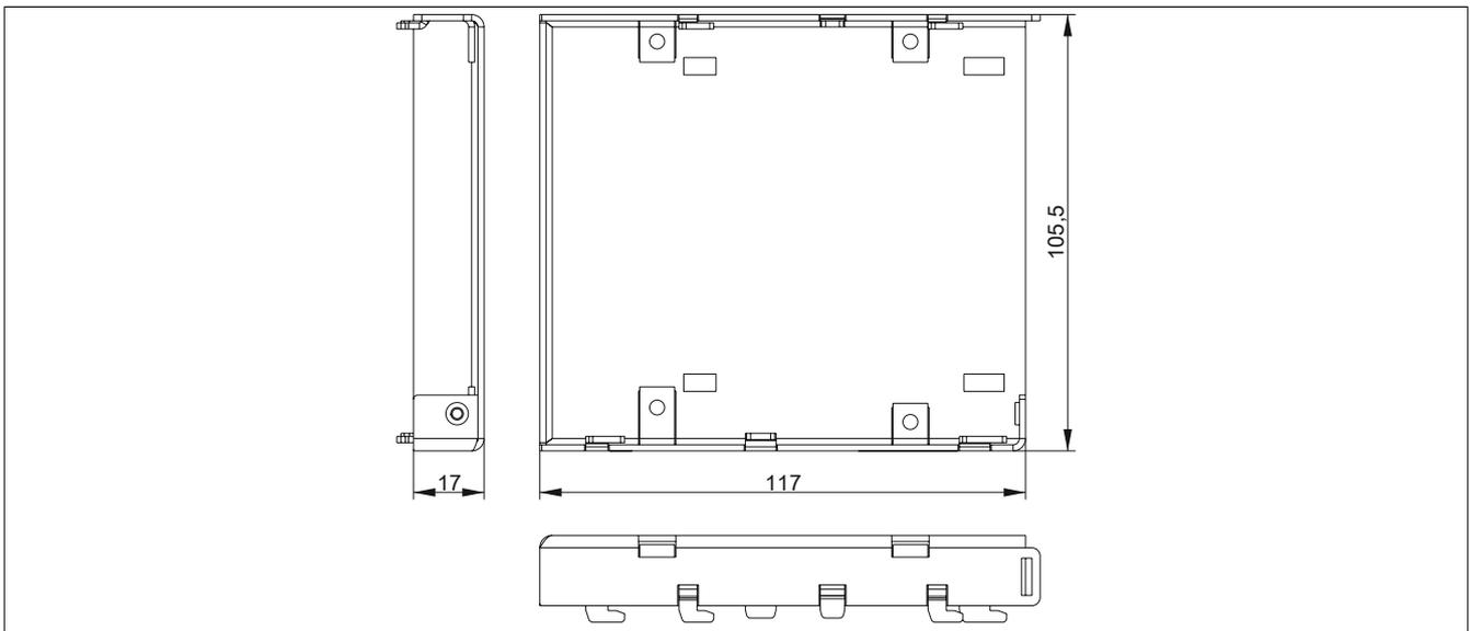
Abbildung 174: 5AC901.FRAM-00 - Abmessungen
