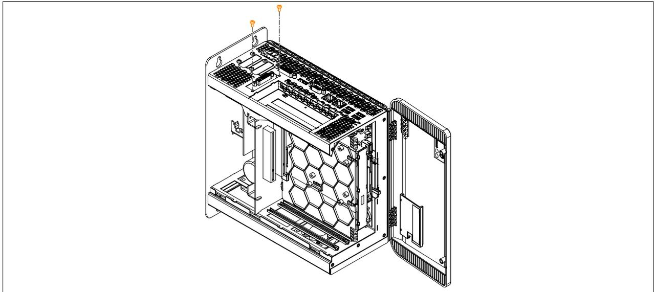
Abbildung 214: Monitor/Panel Option mit den Torxschrauben fixieren
