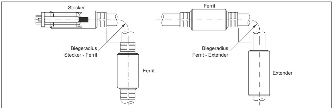
Abbildung 187: Biegeradiusspezifikation mit Extender
