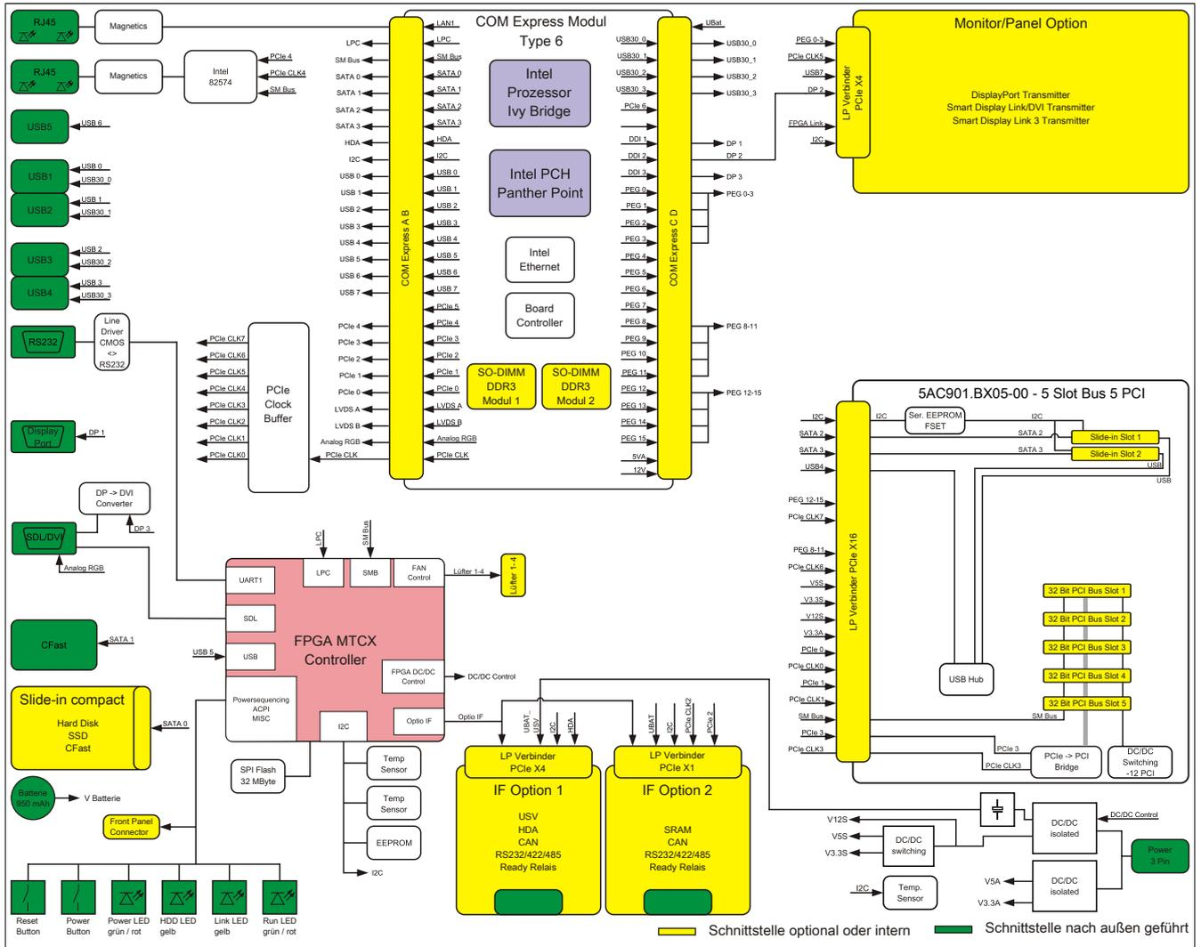
Abbildung 13: Systemeinheit 5PC910.SX05-00 + Buseinheit 5AC901.BX05-00 Blockschaltbild
