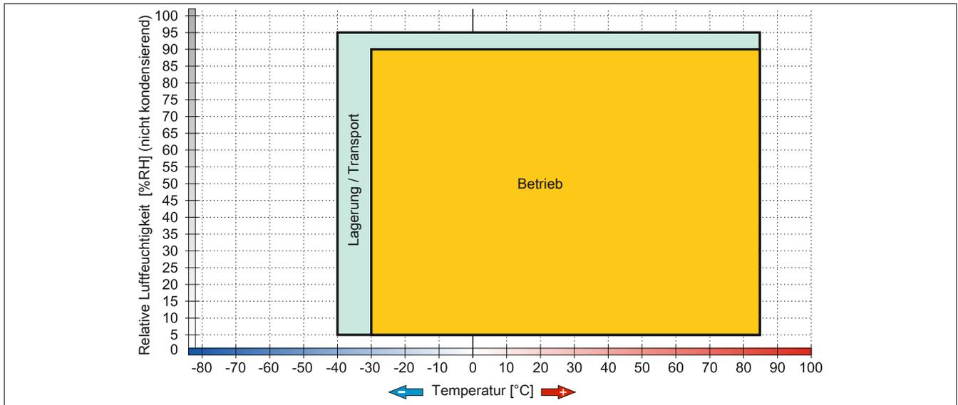
Abbildung 41: 5AC901.CSSD-03 ≥ Rev. D0 - Temperatur Luftfeuchtediagramm
