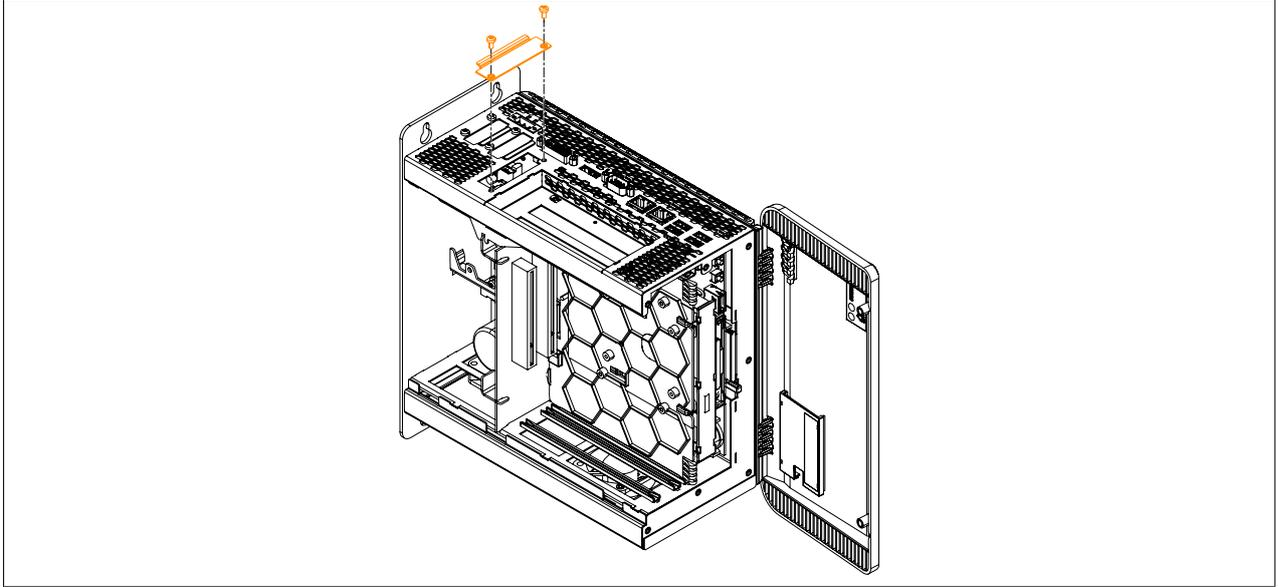
Abbildung 212: Torxschrauben und Blindabdeckung entfernen
