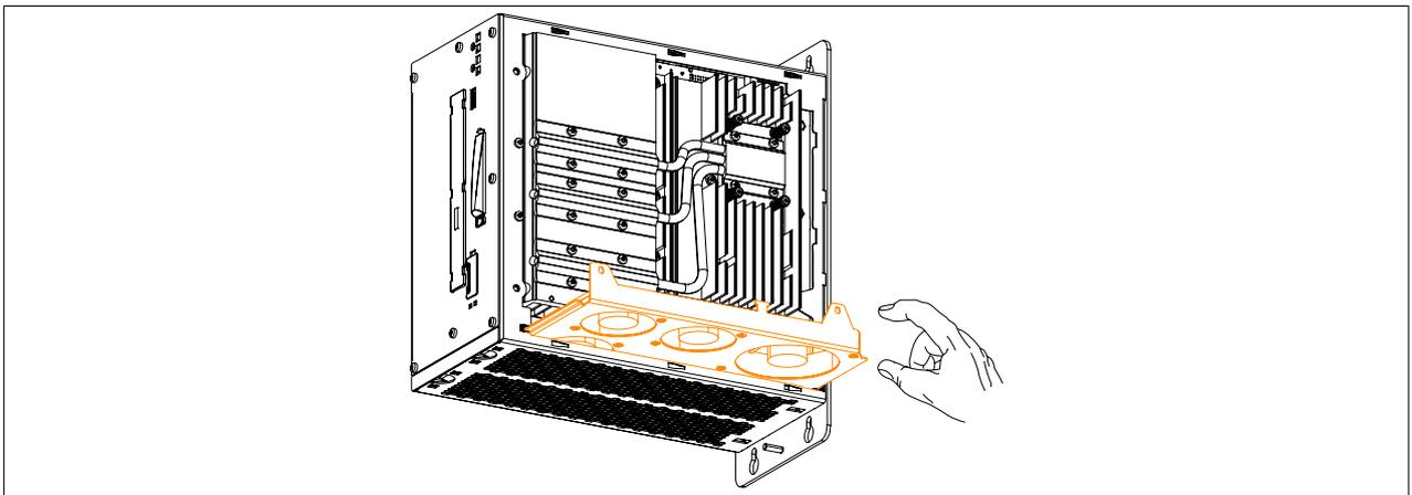
Abbildung 238: Lüfter Kit aus dem APC910 entfernen
