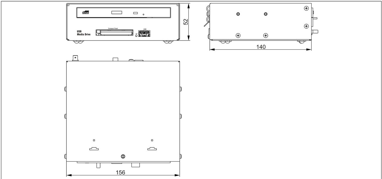
Abbildung 167: 5MD900.USB2-02 - Abmessungen
