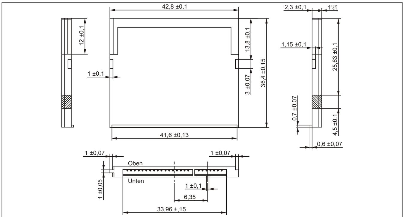
Abbildung 161: Abmessungen CFast-Karte
