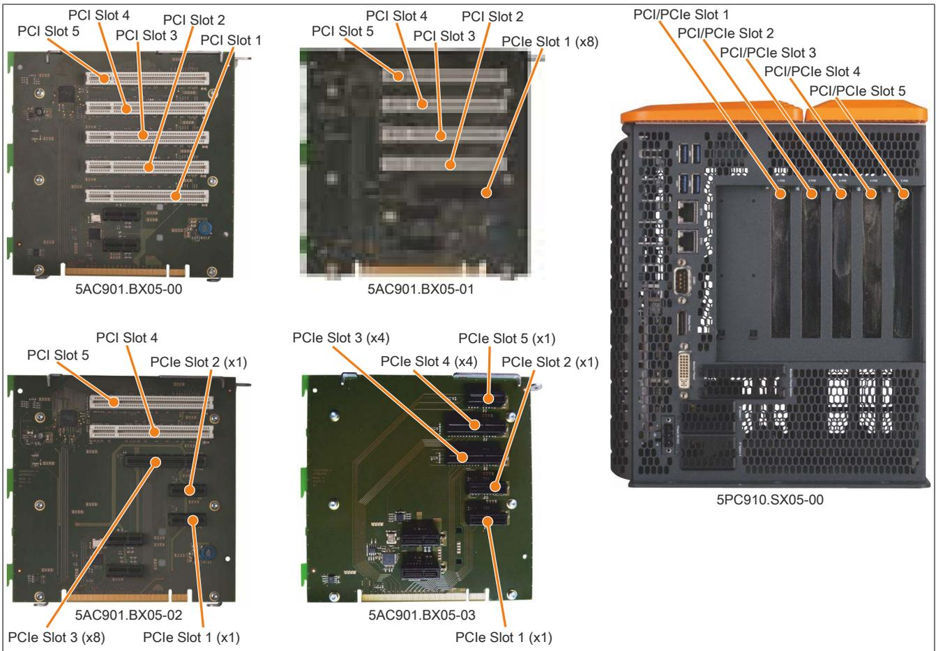
Abbildung 33: 5 Slot Buseinheiten
