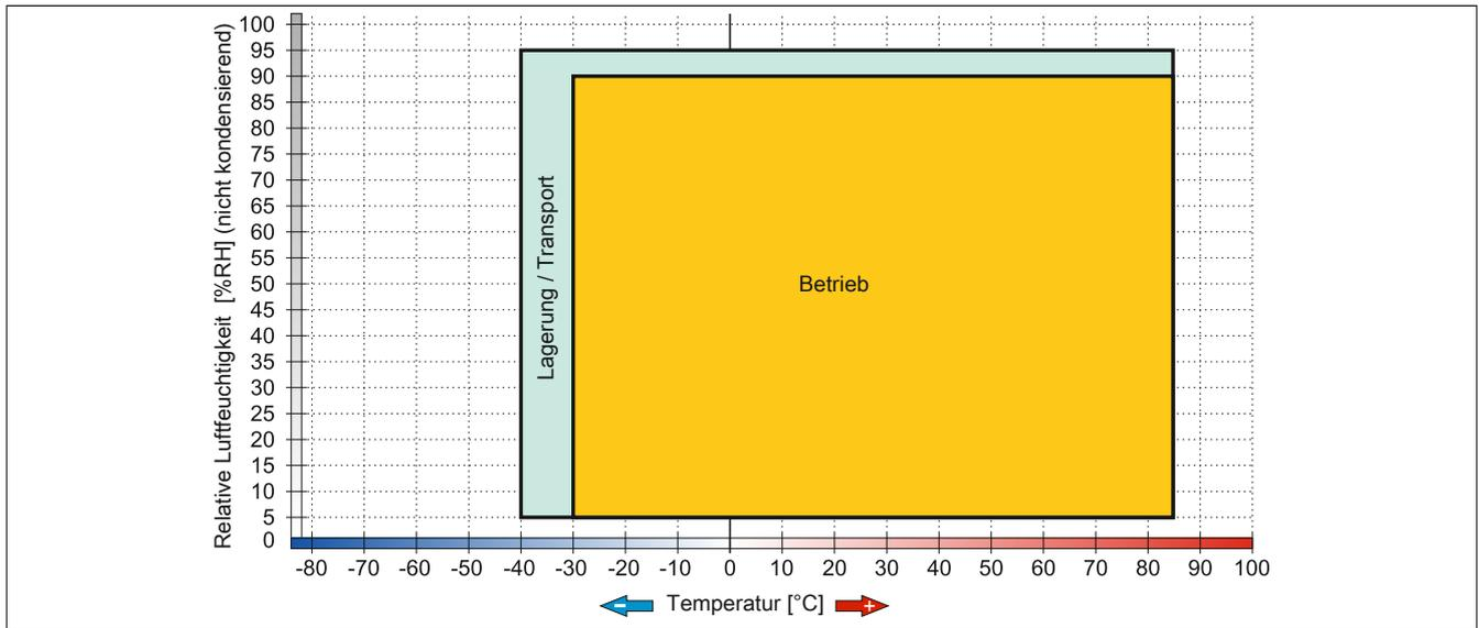
Abbildung 47: 5MMSSD.0060-01 ≥ Rev. D0 - Temperatur Luftfeuchtediagramm
