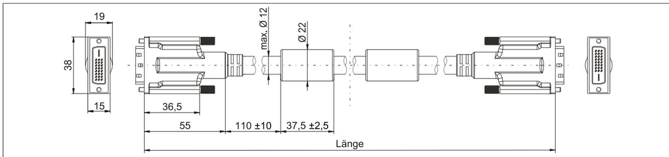
Abbildung 185: 5CASDL.0xxx-03 - Abmessungen
