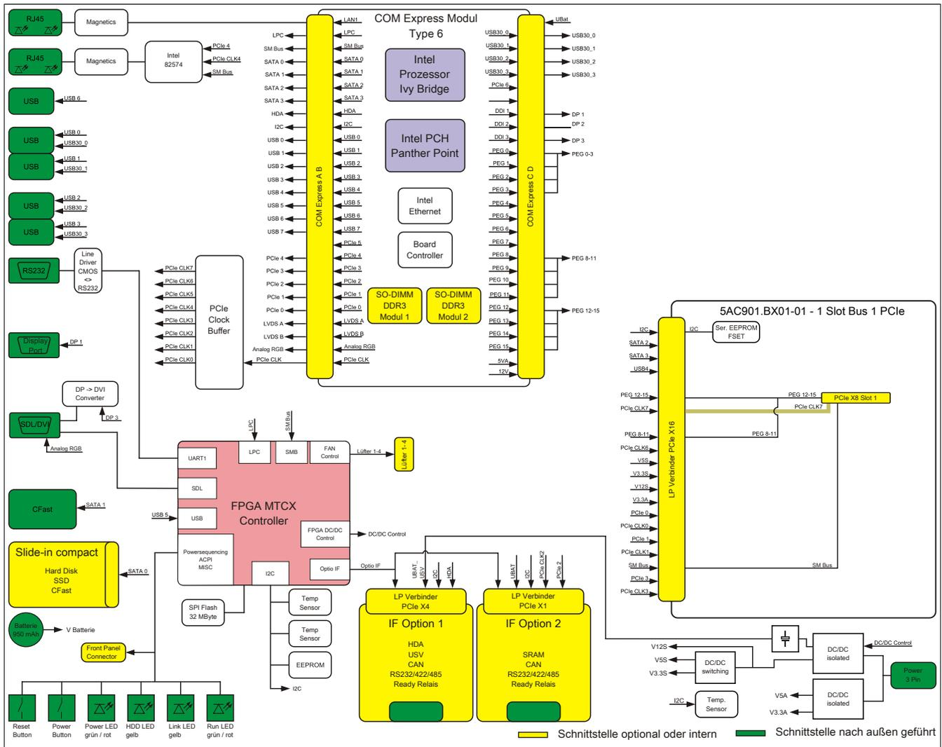
Abbildung 9: Systemeinheit 5PC910.SX01-00 + Buseinheit 5AC901.BX01-01 Blockschnittbild
