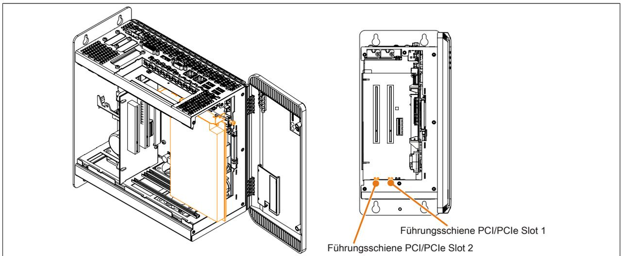
Abbildung 230: PCI-/PCIe-Karte einbauen bzw. tauschen
