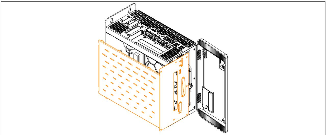
Abbildung 223: Seitenabdeckung entfernen
