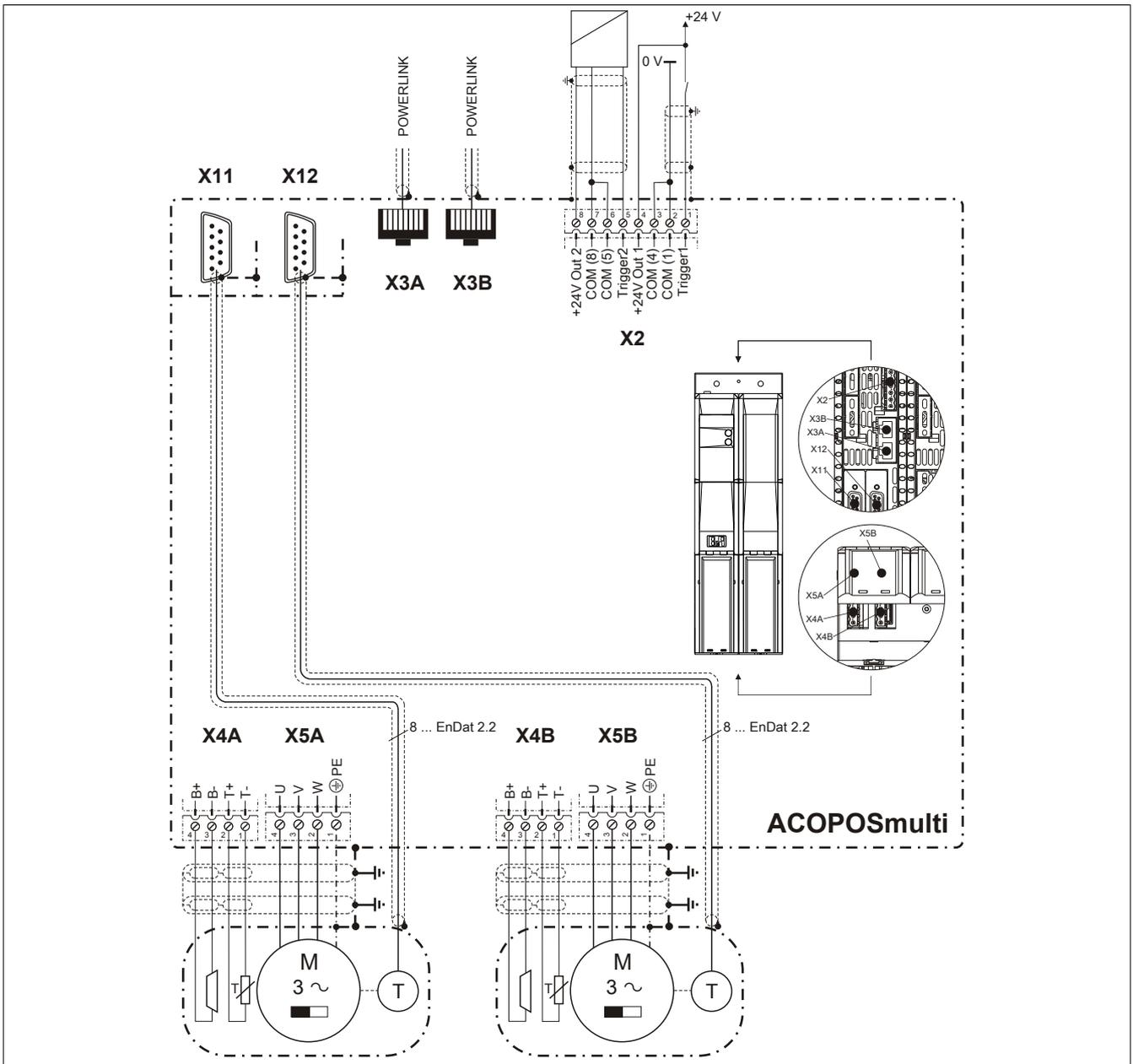
Abbildung 2: Übersicht Anschlussbelegungen
