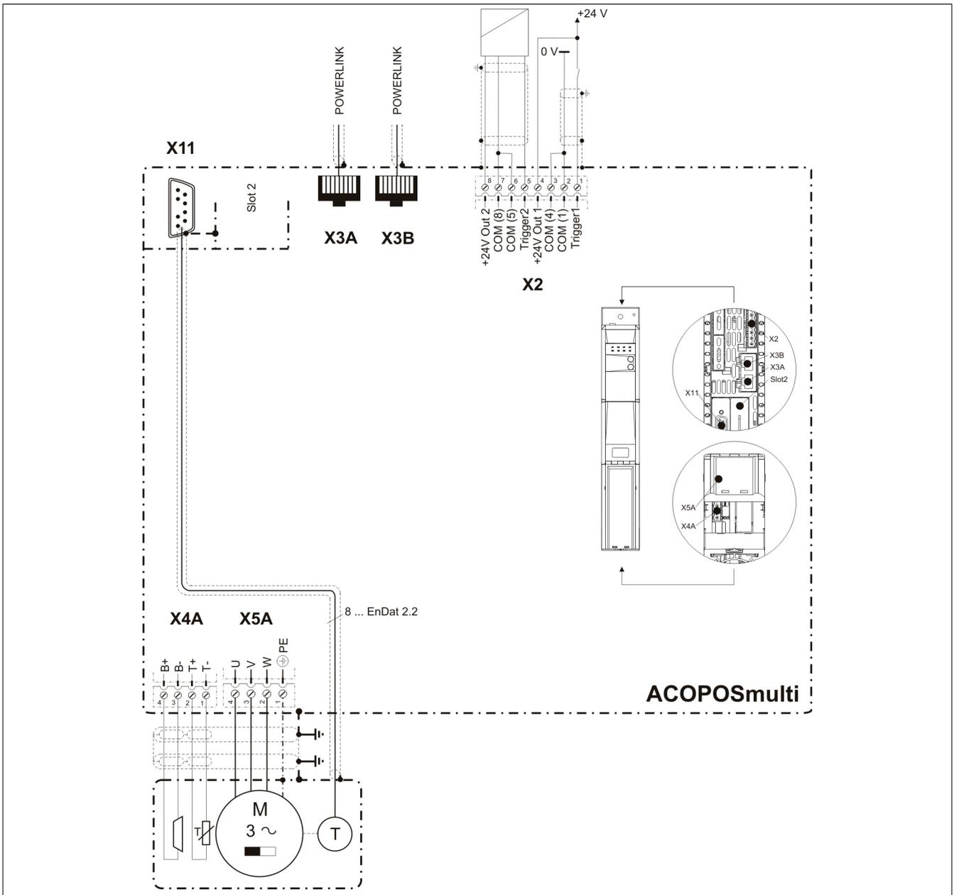
Abbildung 2: Übersicht Anschlussbelegungen
