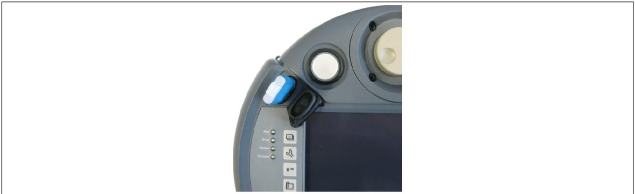
Abbildung 48: USB Schnittstelle - Memorystick einstecken
