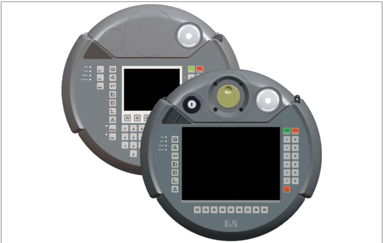
Anstelle der für raue Betriebsumgebungen nicht geeigneten rotierenden Massenspeichern, wie Disketten- und Festplattenlaufwerke, stehen im Mobile Panel onboard FLASH Bausteine zur Verfügung. Das Mobile Panel bietet eine Windows CE Plattform, auf die Applikationen aufgesetzt werden können.
