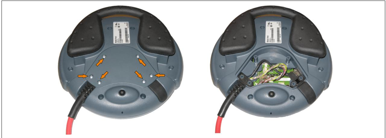
Abbildung 82: Abdeckung des Anschlusschachtes entfernen
