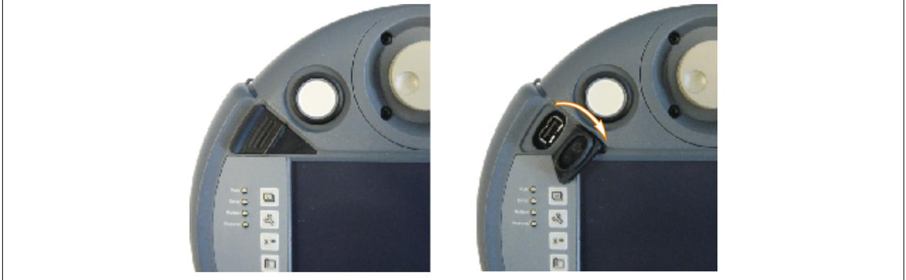
Abbildung 47: USB Schnittstelle - Schutzklappe öffnen
