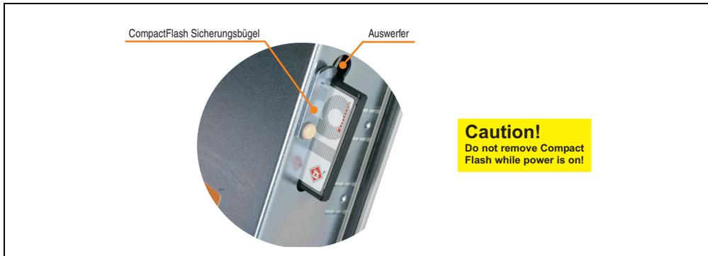
Abbildung 9: CompactFlash Slot
