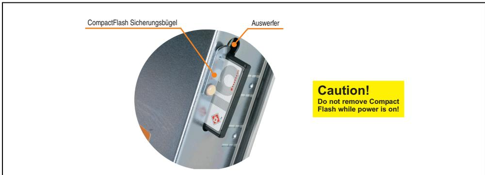
Abbildung 100: CompactFlash Slot
