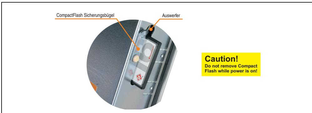
Abbildung 275: CompactFlash Slot
