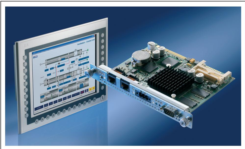
Der PPC300 wird mit Hilfe einfachster Einschubtechnik in den beim AP900 vorhandenen Einschubsteckplatz eingesteckt und mit den beiden Fixierschrauben (max. Anzugsmoment 0,5 Nm) fest mit dem AP900 verbunden. Nähere Informationen für den Einbau siehe Kapitel 3 "Inbetriebnahme", Abschnitt "PPC300 Montage in einem Automation Panel 900", auf Seite 105.
