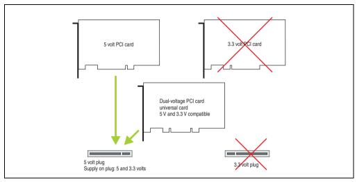
Figure 45: PCI connector type: 5 volt
