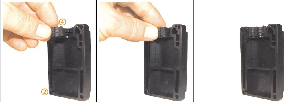
2) Dichtung 2 in den Motor einlegen und festdrücken.
