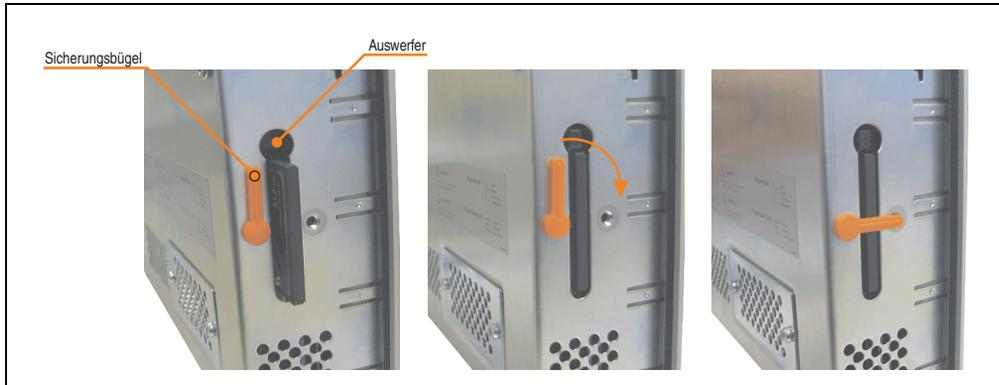
Abbildung 6: CompactFlash Slot
