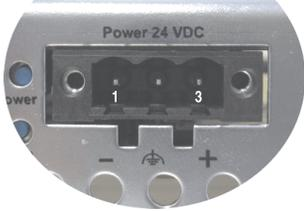
Abbildung 90: Spannungsversorgungsanschluss
