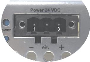
Abbildung 45: Spannungsversorgungsanschluss
