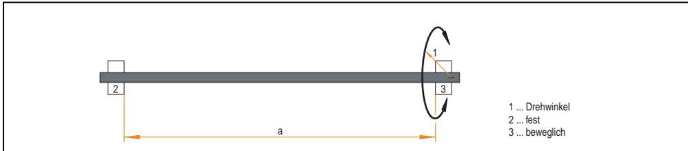
Abbildung 166: Testaufbau - Torsion
