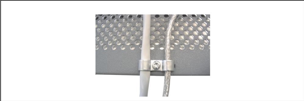
Abbildung 74: Kabelschellenfixierung
