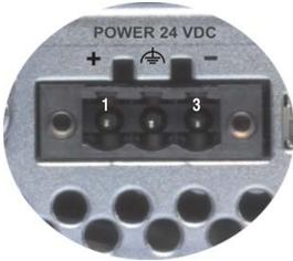
Abbildung 77: Spannungsversorgungsanschluss
