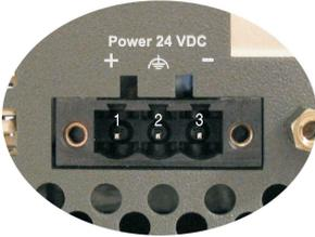
Abbildung 13: Spannungsversorgungsanschluss
