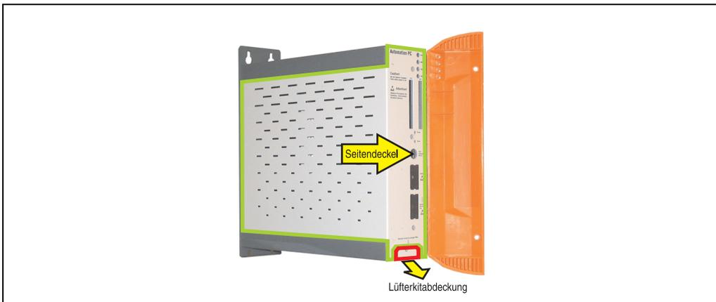
Abbildung 136: APC620 1PCI Slot - Seitendeckel und Lüfterkitabdeckung entfernen
