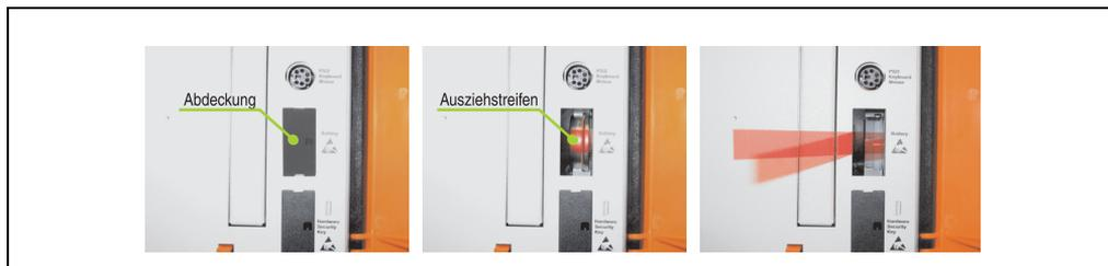
Abbildung 132: Batterie herausziehen
