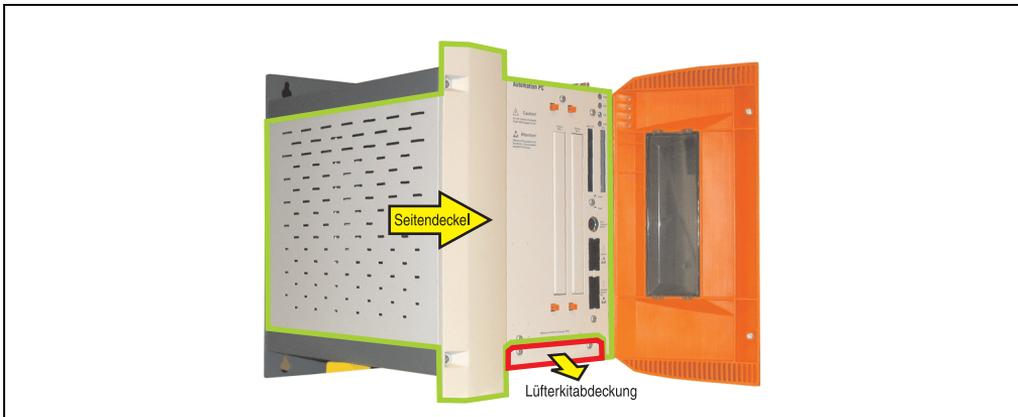
Abbildung 146: APC620 5PCI Slot - Seitendeckel und Lüfterkitabdeckung entfernen
