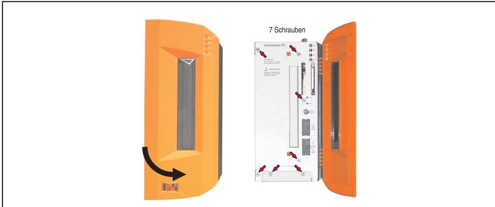
Abbildung 140: APC620 2PCI Slot - Schrauben für den Filterkit Ein- und Ausbau lösen
