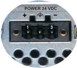
Abbildung 2: Spannungsversorgungsanschluss
