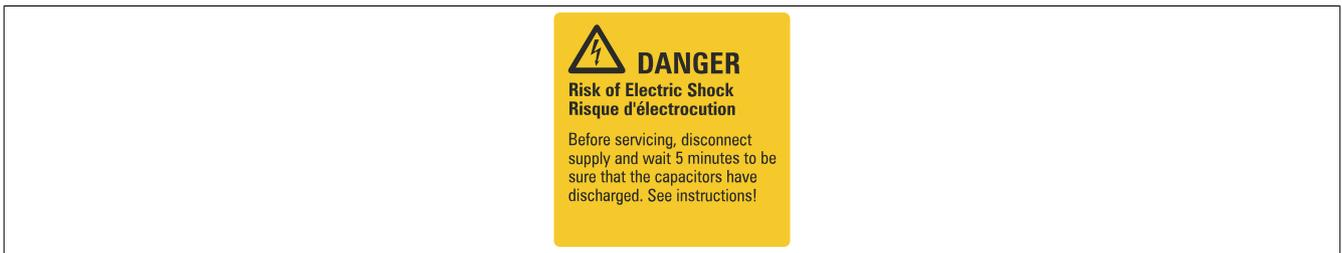
Abbildung 1: Warnschild am ACOPOSremote und ACOPOSmotor Modul
