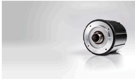
Die Direktantriebsmotoren der Baureihe 8LT sind permanenterregte Torquemotoren für Applikationen mit hohen Anforderungen an Dynamik und Positioniergenauigkeit bei gleichzeitig geringem Bauvolumen und Gewicht. Sie sind sowohl selbstgekühlt als auch in einer fremdgekühlten Variante erhältlich.
