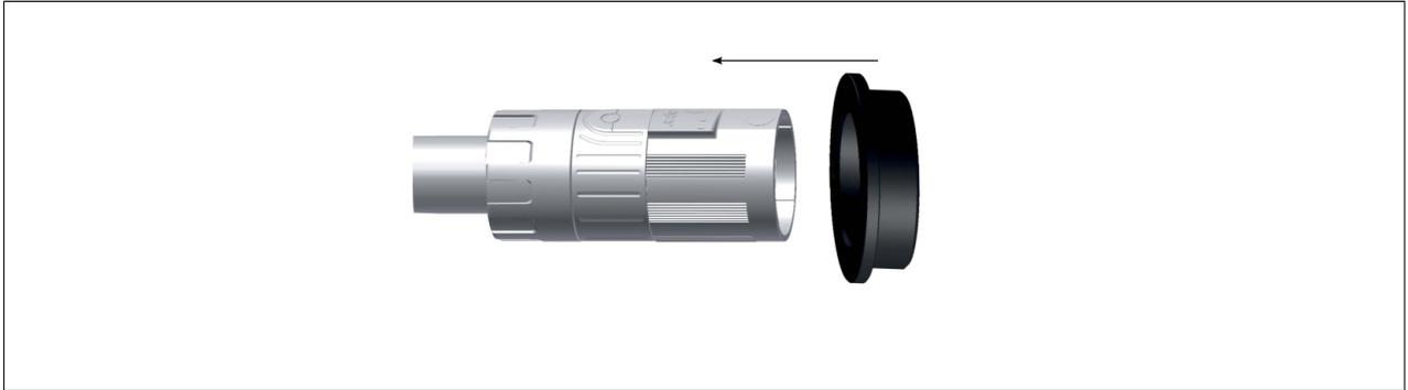
2. Metallflansch wie abgebildet über den Stecker und den Dichtring schieben.
