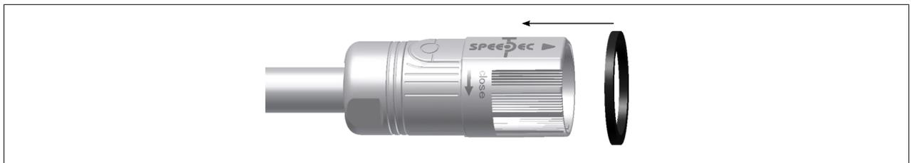
2. Metallflansch öffnen und wie abgebildet am Stecker anbringen. Dabei ist Montageart zu berücksichtigen (abgebildet ist die Hinterwandmontage). Der Dichtring muss sich immer zwischen Metallflansch und Schaltschrankwand befinden.
