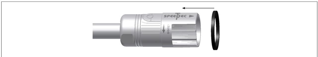
2. Schritt 2-6 siehe [Hinterwandmontage](#) (zu beachten ist, dass sich der Dichtring bei der Vorderwandmontage auf der anderen Seite des Metallflansches befinden muss).
