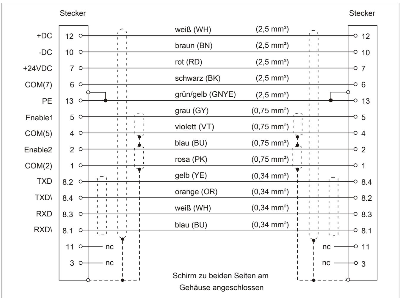
Abbildung 1: Kabelplan Hybridkabel
