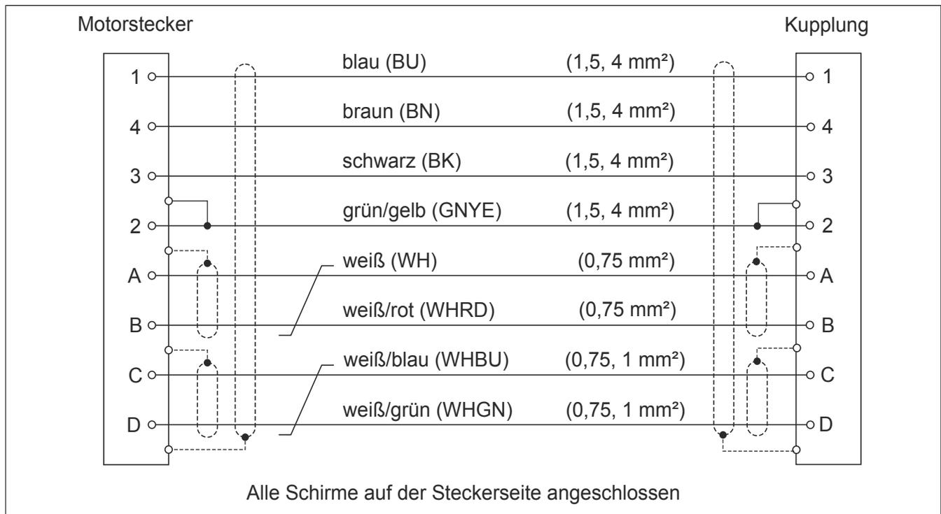
Abbildung 1: Kabelplan Motorkabel
