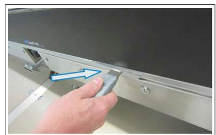
3. Ziehen Sie mit dem Magneten die Führungsleiste aus dem Kanal. Die Führungsleiste wird durch Permanentmagneten im Kanal festgehalten. Verwenden Sie den Magneten, um die Führungsleiste von den Permanentmagneten wegzuziehen.
