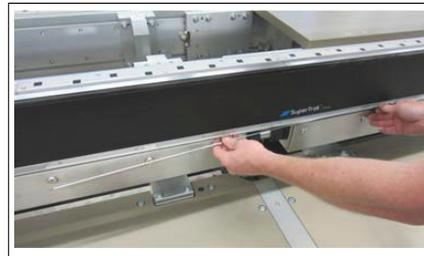
4. Entfernen Sie Schmutz oder Fremdkörper aus dem Leistenkanal. Siehe 9.2 "Vorgehensweise Reinigung" auf Seite 183.
