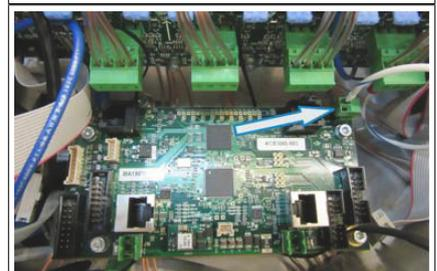
9. Lösen Sie die vier (4) Verbindungsschrauben.
