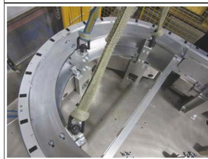
3. Verwenden Sie ein angemessenes Hebezeug wie beispielsweise einen Gabelstapler, um das Kurvensegment mit den Enden der Hebegurte anzuheben.
