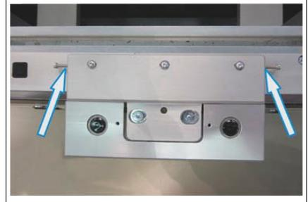
5. Montieren Sie das Shuttle unter der abnehmbaren Halterung. Schieben Sie das Shuttle langsam in Position. Das Shuttle sollte nicht gegen die Oberfläche der abnehmbaren Halterung stoßen, da sonst der Aufbau aus seiner Position geraten kann.
