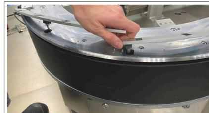
5. Lösen Sie die Schrauben, mit denen die Ständer des Segments am Rahmen befestigt sind (siehe rechts).
