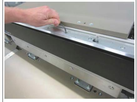
5. Markieren Sie die Position der 0,25 mm (0,01 Zoll) Distanzscheibe und heben Sie diese an einem sicheren Ort auf.
