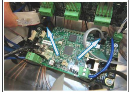
7. Stecken Sie ein (1) oder zwei (2) Motornetzwerkverbindungskabel ab wie erforderlich.
