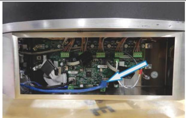
13. Führen Sie die 5 Drähte des Verbindungskabels durch die Zugentlastung des SuperTrak Schaltschranks.
