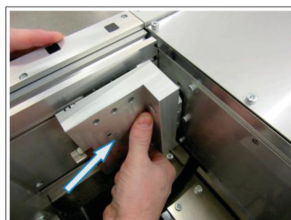
4. Montieren Sie vier (4) Beilagscheiben und vier (4) Schrauben lose auf der Seite des Geradensegments, montieren Sie danach zwei (2) Beilagscheiben und zwei (2) Schrauben auf der Seite des Kurvensegments und ziehen diese fest. Beachten Sie, dass die Schrauben, die am Kurvensegment angebracht werden, größer sind.
