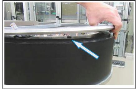
3. Montieren Sie elf (11) Schrauben, um die obere Platte zu sichern.
