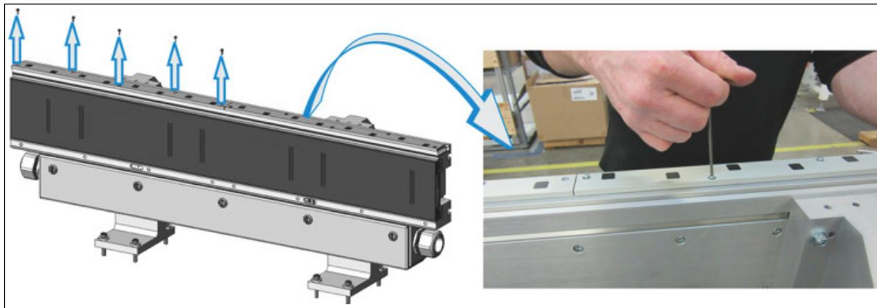
5. Heben Sie die Geberleiste gerade nach oben von den beiden Positionierstiften ab.
