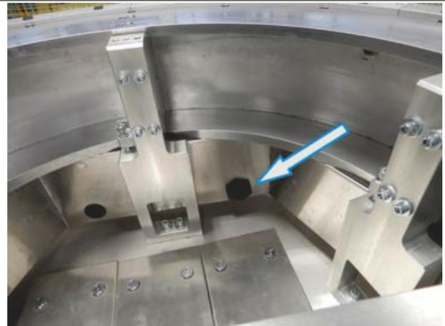
3. Führen Sie die 4 Drähte des Verbindungskabels durch die Zugentlastung in das Kurvensegment.
