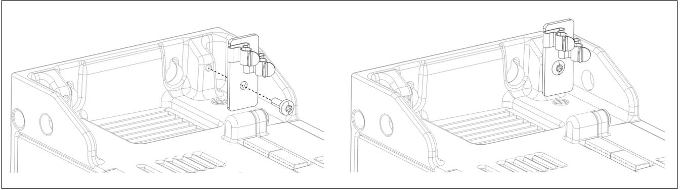
Abbildung 2: Schirmkomponentenset 8SCSE01.0300-00 - Montage (Servoverstärker mit 133 mm Breite)
