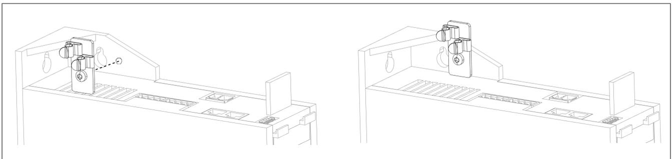
Abbildung 1: Schirmkomponentenset 8SCSE01.0300-00 - Montage (Servoverstärker mit 66 mm Breite)
