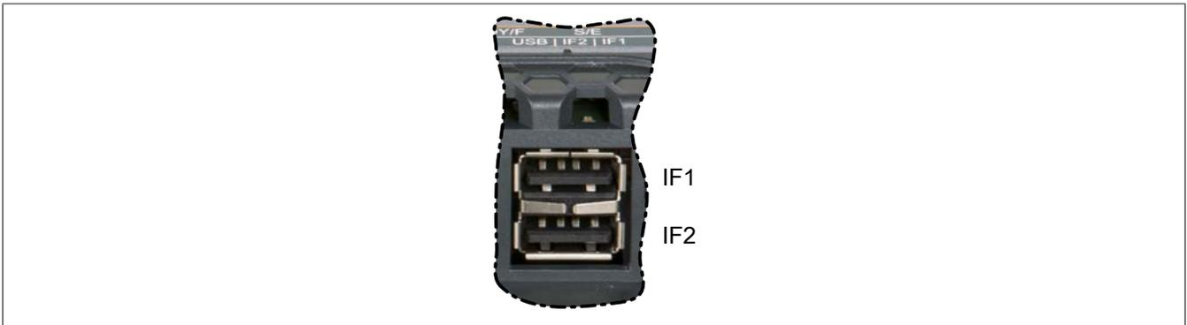
Das Power Panel verfügt über einen USB 2.0 Host Controller mit 2 USB-Schnittstellen:
