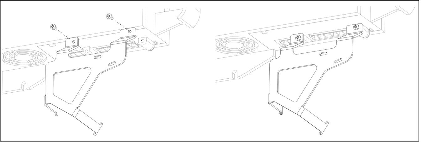
Abbildung 1: Schirmkomponentenset 8SCSE01.0100-00 - Montage
