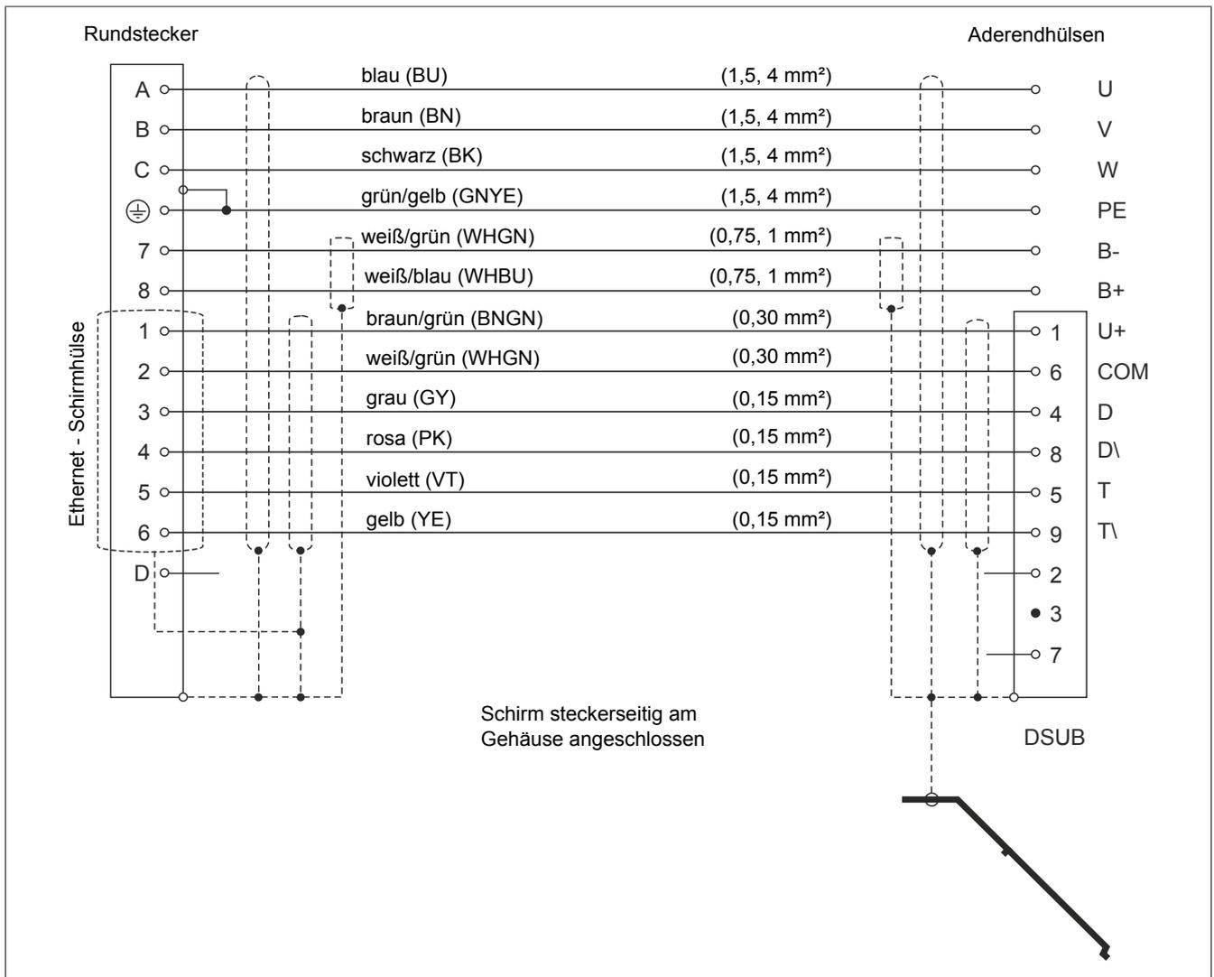
Abbildung 1: Kabelplan Motorhybridkabel
